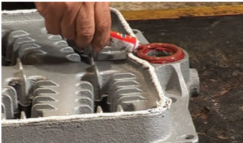
شکل ۲۰- استفاده از اورینگ به جای بوش
