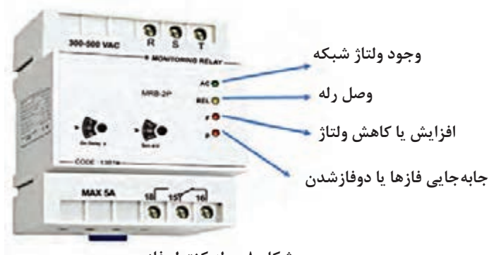
شکل ۸- رله کنترل فاز
