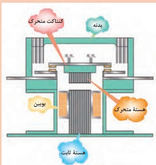
شکل ۵- کنتاکتور
