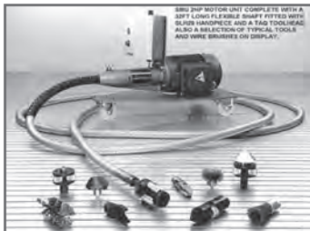
شکل ۲۹- سیستم رسوب‌زدایی مکانیکی به وسیله برس‌ها و فرچه‌های مختلف
