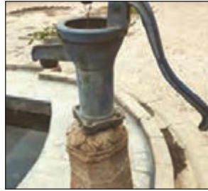
شکل ۲- تلمبه آب (سیلندر بیستونی قدیمی)
