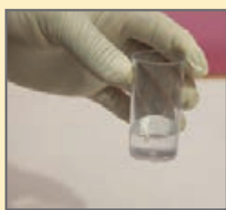
پرکردن آب تاخط نشانه
