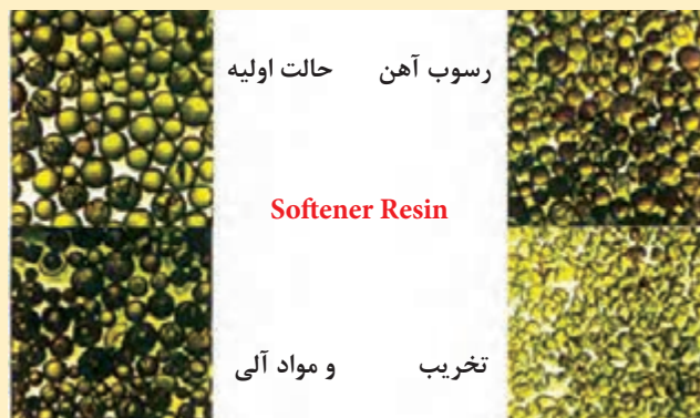
روند تغییر شکل رزین در طول سختی گیری و ترکیب با مواد آلی
