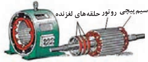
شکل ۴ - الکترو موتور با روتور سیم‌پیچی
