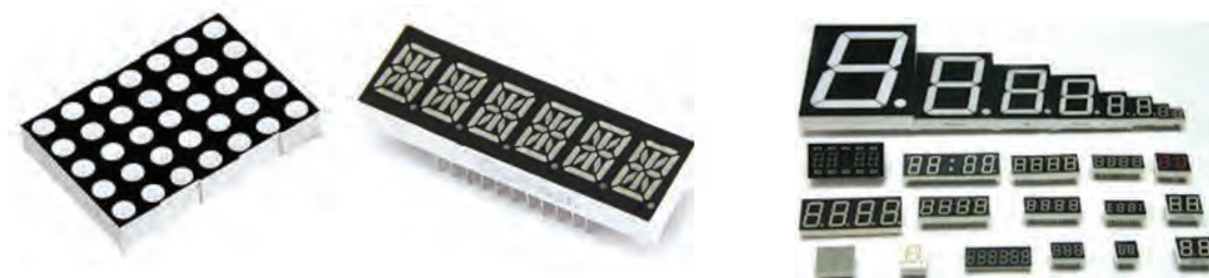
شکل ۱۶-۲- برخی از انواع نمایشگرهای LED
