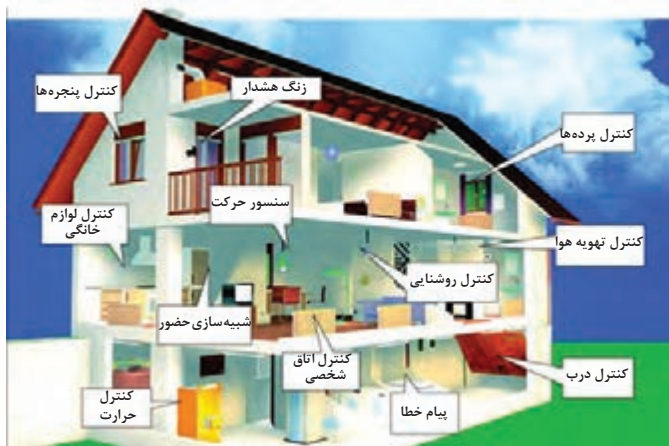
شکل ۲۱-۵- حسگرهای استفاده شده در یک خانه هوشمند
