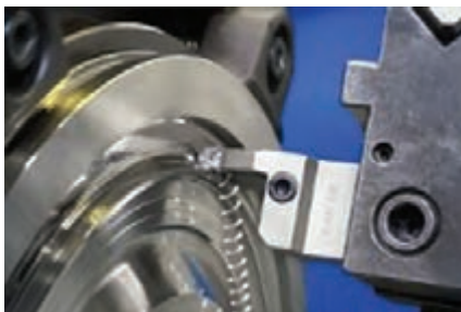
شکل ۴-۶: براده‌برداری به‌وسیله تیغه کاربیدی
