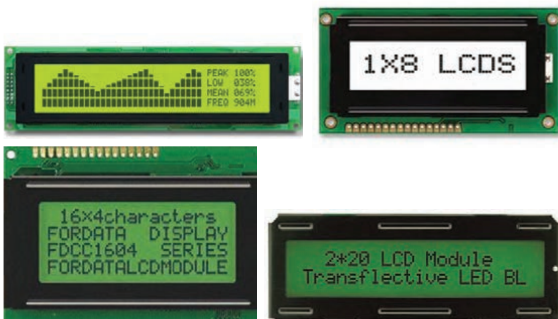
برخی از انواع نمایشگر کریستال مایع کاراکتری
