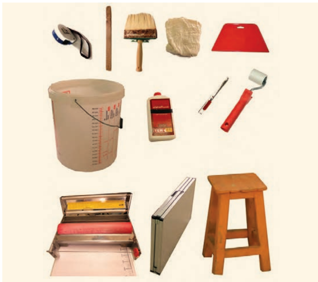
شکل ۶۲-۳- ابزار و تجهیزات کارگاه اجرای کاغذ دیواری
