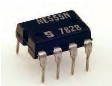
شکل ۲۵-۵- شکل ظاهری ترانزیستور و آی سی استفاده شده
