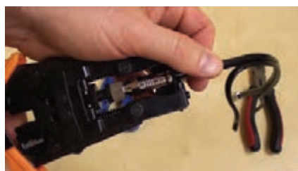
شکل ۱-۷۲ - دو نمونه دستگاه پرچ BNC
