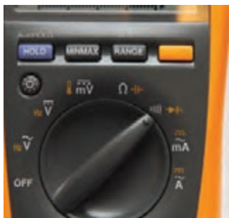
شکل ۳-۵- مولتی متر دیجیتالی در حالت آزمایش دیود
