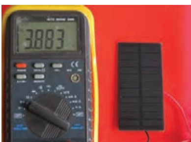
شکل ۳-۹۵- اندازه‌گیری ولتاژ سلول خورشیدی
