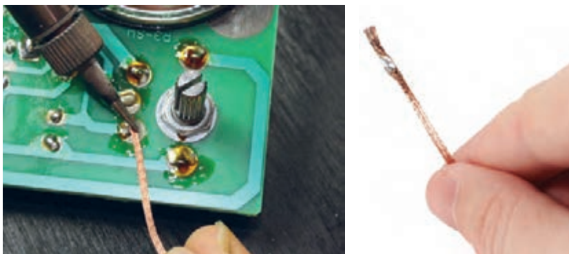
شکل ۸۰-۱- برداشتن قلع از روی فیبر
