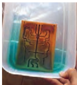
شکل ۷-۱۶- تکان دادن محلول برای خورده شدن مس اضافی فیبر
