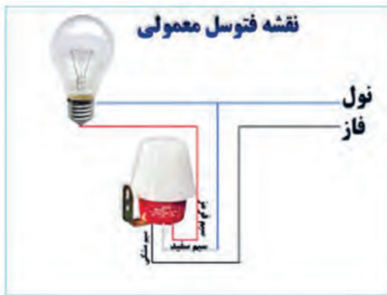
شکل ۶۸-۲- یک نمونه فتوسل
