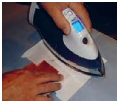
شکل ۹-۷- کشیدن اتو روی کاغذ و فیبر
