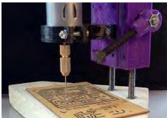
شکل ۱۸-۷- سوراخ کاری پایه قطعات با مته مناسب
