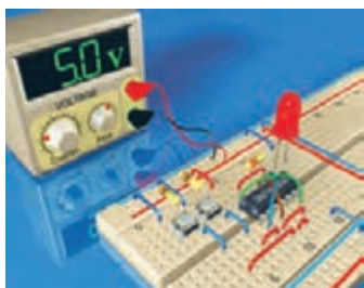
شکل ۷-۴- بستن مدار روی بردبرد و آزمایش آن
