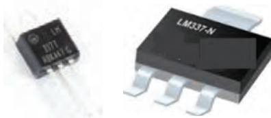
شکل ۸۱-۳- نقشه مدار و تصویر دو نمونه رگولاتور منفی
