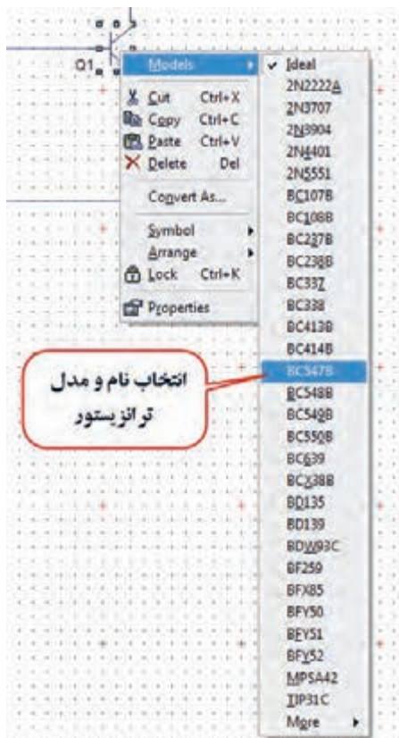
شکل ۱۹-۶- نحوه انتخاب نام و مدل ترانزیستور
