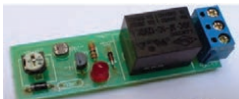
شکل ۲-۶۶- یک نمونه فتوسل
