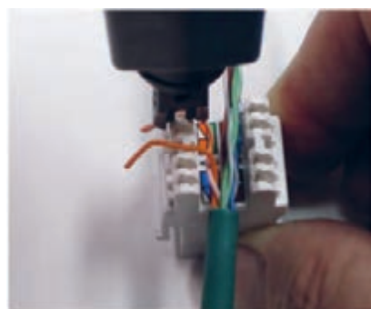
شکل ۱۹-۲- استفاده از یک نوع دستگاه پرچ
