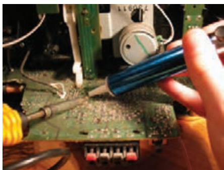
شکل ۸۴-۱- مراحل ذوب شدن و مکش قلع
