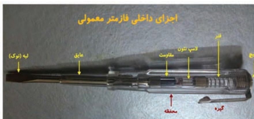
شکل ۲-۳۷- ساختمان داخلی فازمتر
