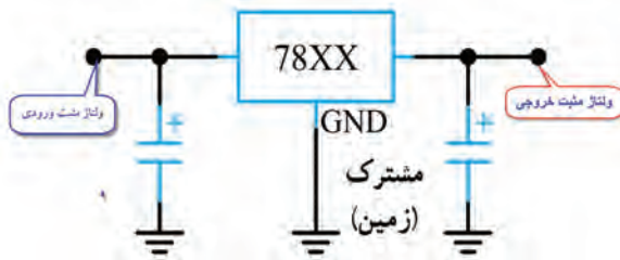
شکل ۷۱-۳- مدار استاندارد قرارگرفتن آی‌سی در مدار
