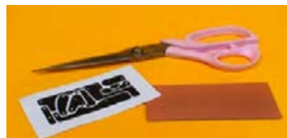
شکل ۷-۷- برش طرح مدار چاپی از کاغذ
