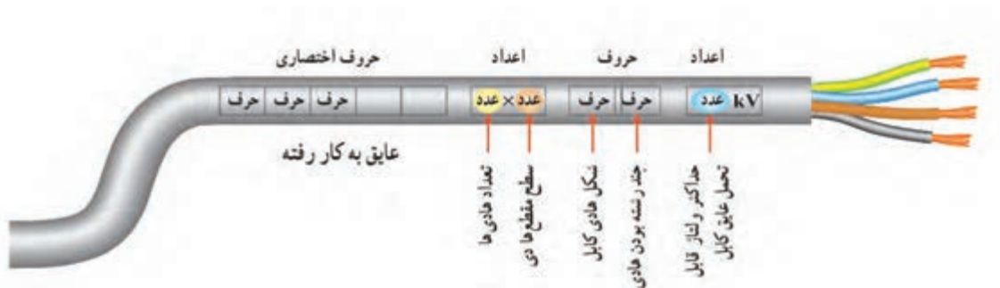
شکل ۲-۱ - مشخصات فنی یک نوع کابل
