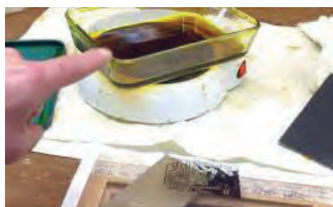
شکل ۷-۱۵- استفاده از اجاق برقی برای حرارت دادن محلول اسید کاری
