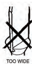
شکل ۲۹-۱- انتخاب آچار مناسب مانع خرابی گل پیچ می شود
