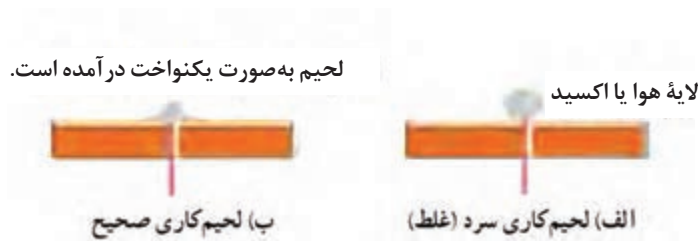
شکل ۵۰-۱- لحیم‌کاری صحیح و غلط
