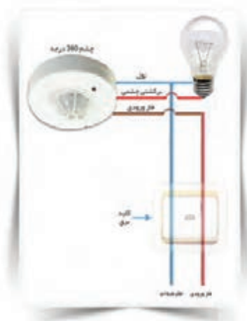
شکل ۲-۷۱- یک نمونه نقشه رله چشمی راه پله
