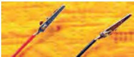
شکل ۱-۶۹ - لحیم کاری گیره سوسماری
