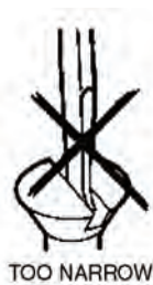
شکل ۲۹-۱- انتخاب آچار مناسب مانع خرابی گل پیچ می شود
