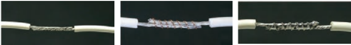
شکل ۶۰-۱- اجرای یک اتصال ساده
