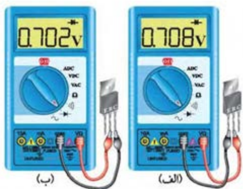
شکل ۴-۴- ولتاژ موافق کلکتور-بیس و امیتر-بیس
