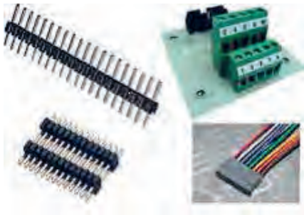
شکل ۷۵-۱ - انواع پین هدر و سوکت مادگی آن
