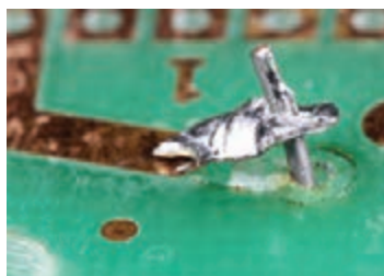
شکل ۹۲-۱- (اینفو گرافیک) نمونه‌هایی از لحیم مشکل دار
