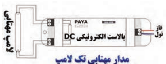
شکل ۶۱-۲- لامپ فلورسنت با انواع بالاست
