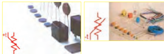
شکل ۹۴-۱- چند نمونه مقاومت‌های تابع حرارت و نماد آن
