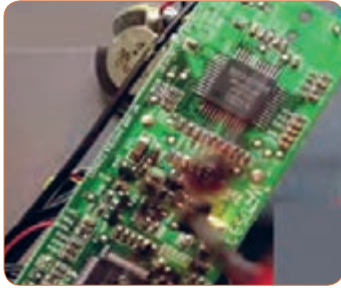
شکل ۵-۵ - قطعاتی از برد سوخته است.
