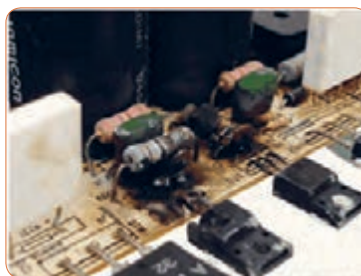
شکل ۲۴-۵ - آسیب قطعات در یک برد
