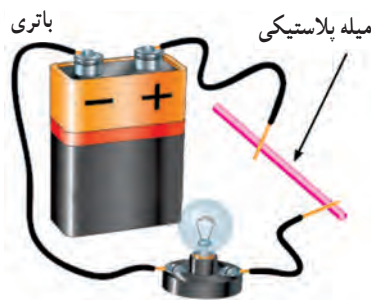
شکل ۲۰ - ۱ برقرار نشدن جریان الکتریکی در عایق
