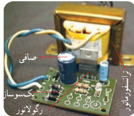
شکل ۶-۶۵ - بلوک دیاگرام منبع تغذیه و مدار واقعی آن
