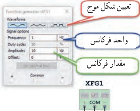
شکل ۳۵ - ۴ - فانکشن ژنراتور و صفحه تنظیم آن
