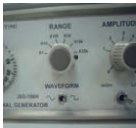
شکل ۴۴ - ۴ شکل ۴۵ - ۴ کلید در وضعیت موج مربعی
