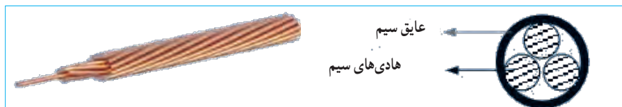
شکل ۱۱-۲- سطح مقطع سیم نیمه افشان
