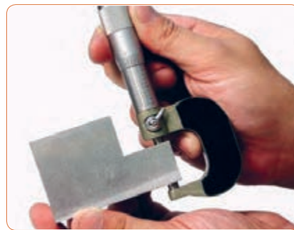
شکل ۱۶- ۲- چگونگی در دست گرفتن میکرومتر
