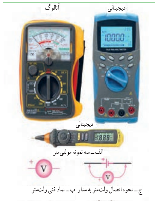
شکل ۵۵- ۱- ولت متر و نماد آن
