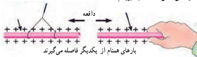
شکل ۱-۲- اثر بارهای استاتیکی بر یکدیگر
