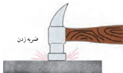
شکل ۸-۷ خنثی کردن اثر مغناطیس آهن‌ریا با زدن ضربه
