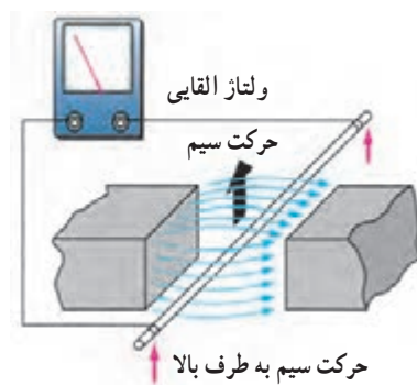
شکل ۸-۲۳- اساس کار یک ژنراتور ساده
