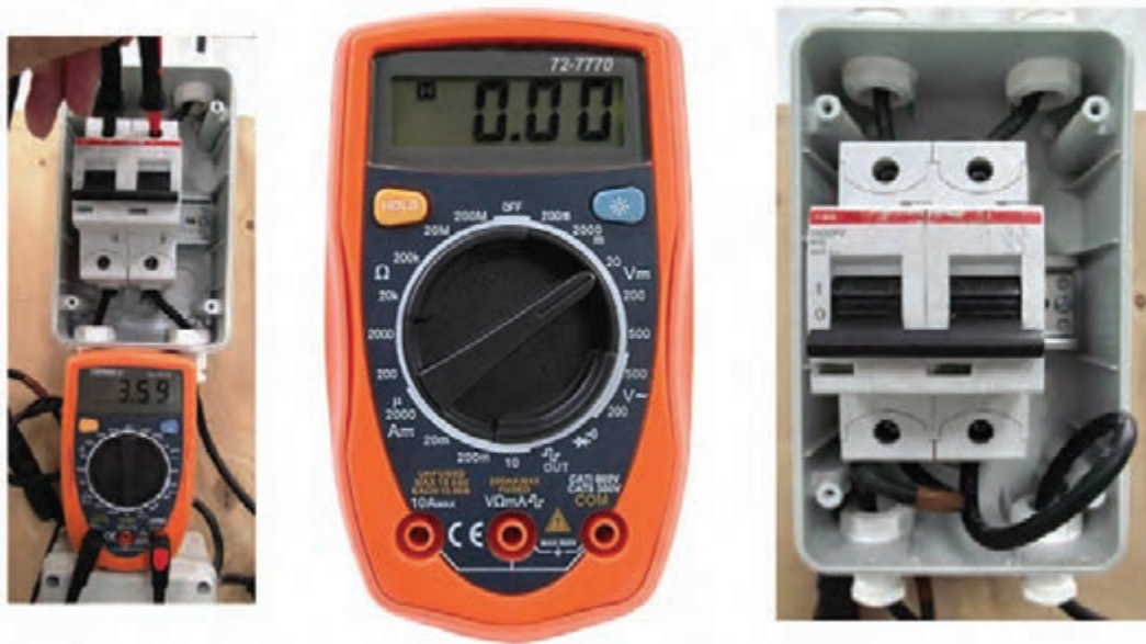
شکل ۱۰- اندازه گیری جریان اتصال کوتاه با مولتی متر
