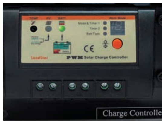
شکل ۳۶- با اتصال باتری LED روشن می شود.
