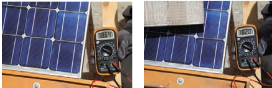
شکل ۷- الف - اثر سایه بر ولتاژ بی‌باری
