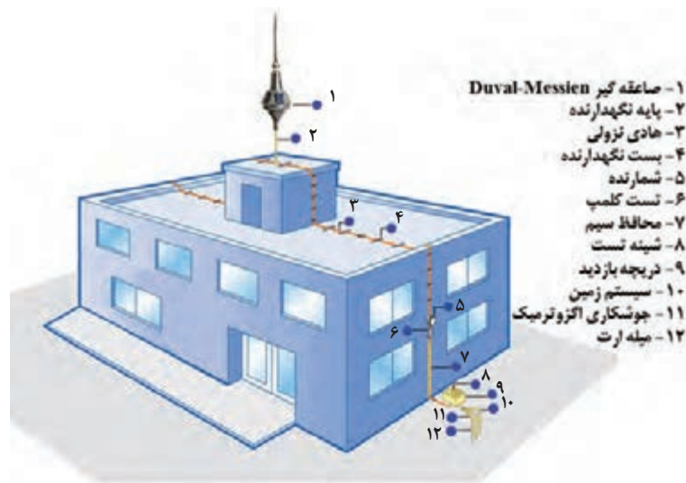
شکل ۴۱- تجهیزات صاعقه گیر
