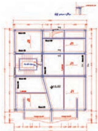
شکل ۱۴- نقشه اجرای همبندی سقف‌های ساختمان
