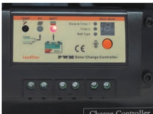
شکل ۳۶- با اتصال باتری LED روشن می شود.
