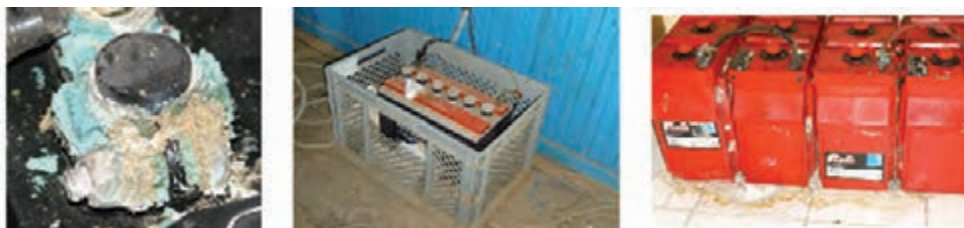
شکل ۲۱- سولفاته و نشستی باتری
