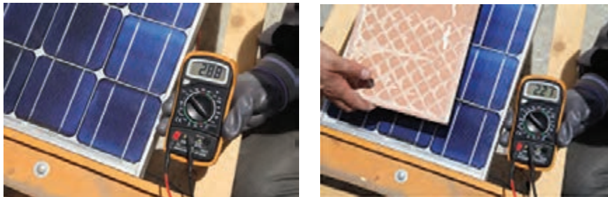
شکل ۷- ب - اثر سایه بر جریان اتصال کوتاه
