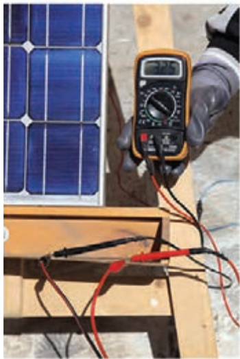
شکل ۱۵-۲ اندازه‌گیری جریان اتصال کوتاه
