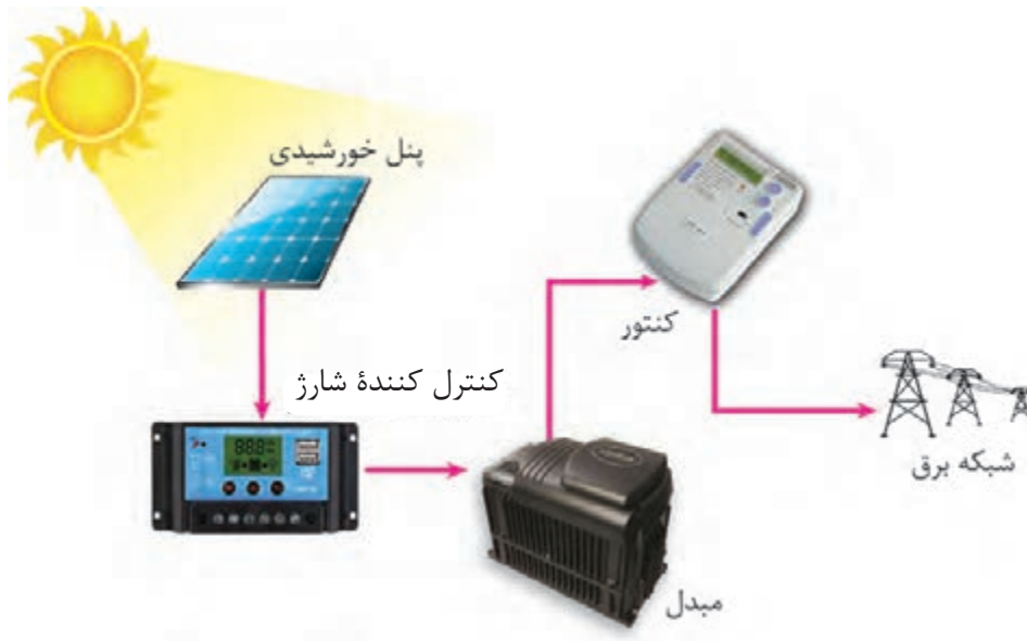
شکل ۵۱- نقشه ارتباط عناصر سیستم فتوولتائیک On_Grid
