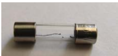
شکل ۱۶ - فیوز آسیب دیده است.
