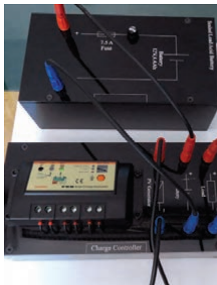
شکل ۳۷ - اتصال کنترل کننده شارژ به مدول
