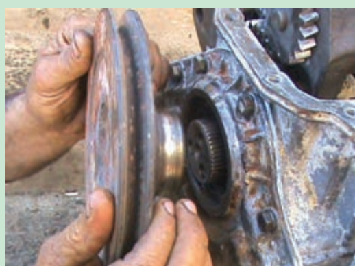
شکل ۱۱۲. جا زدن پولی سر میل لنگ
