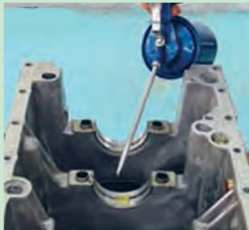
شکل ۹۵. روغنکاری یاتاقان ها قبل از نصب
