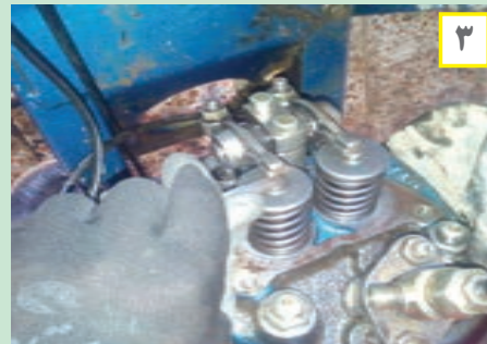
شکل ۳۷. فیلرگیری موتور تراکتور دوچرخ
