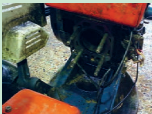
شکل ۵۶. برداشتن سر سیلندر
