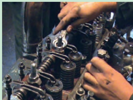
شکل ۴۵. باز کردن پیچ‌های پایه اسبک
