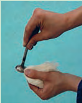
شکل ۸۰. تمیز کردن سوپاپ
