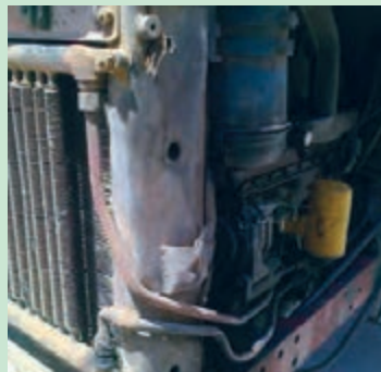
شکل ۱۳. رادیاتور روغن تراکتور U650
