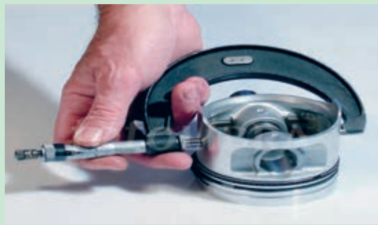
شکل ۷۵. اندازه‌گیری قطر پیستون با میکرو متر
