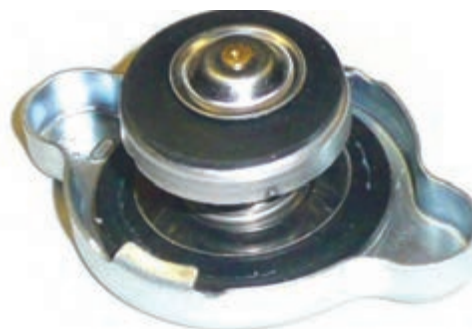
شکل ۱۲. درب رادیاتور و سوپاپ های آن
