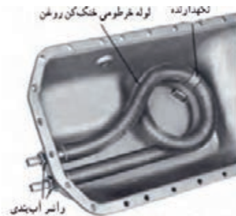
الف- عبور لوله مایع خنک‌کننده از کارتر ب- عبور مایع خنک‌کننده از پایه فیلتر JD314 ج- رادیاتور روغن U65
