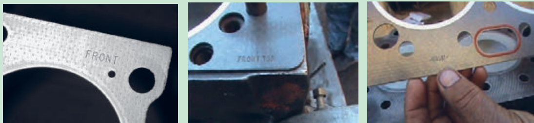
شکل ۸۶. علامت‌های روی واشر سرسیلندر
