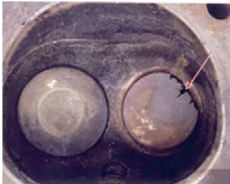
شکل ۷۰. عیوب ظاهری سوپاپ‌ها
