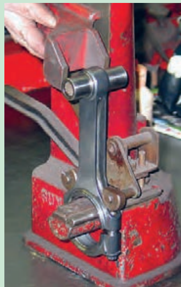
شکل ۸۲. پیچیدگی شاتون، اندازه گیری و اصلاح آن
