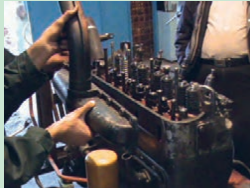
شکل ۴۳. باز کردن مانیفولد تراکتور U650
