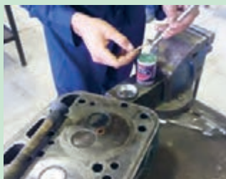
شکل ۷۸. زدن روغن سنباده به سوپاپها
