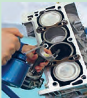
شکل ۱۰۱. روغن کاری کپه یاتاقان شاتون
