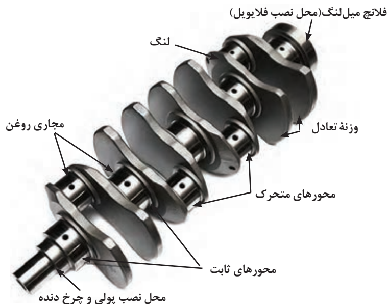
شکل ۱۶. اجزاء میل لنگ
