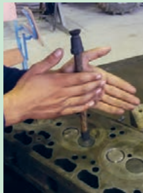
شکل ۷۹. چرخاندن سوپاپ به وسیله چوب سوپاپ گردان
