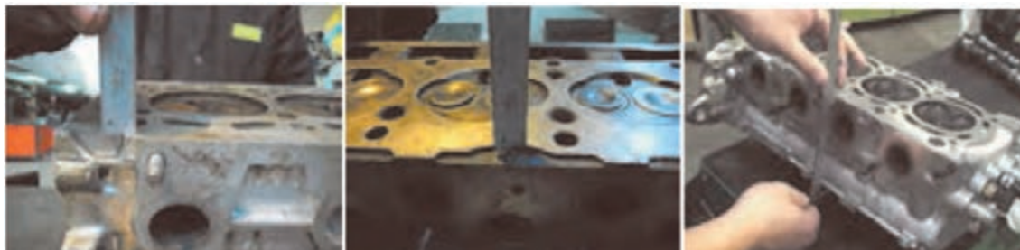
شکل ۸۳. کنترل ارتفاع مجاز کف تراشی سر سیلندر
