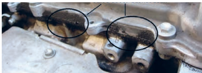
شکل ۲۷. نشستی روغن از درپوش سوپاپ‌ها
