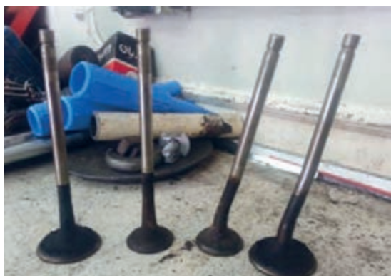
شکل ۶۷. کربن گرفتگی سرسیلندر و سوپاپ‌ها
