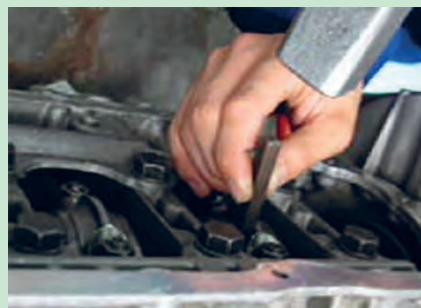
شکل ۴۱. علامت زدن کپه شاتون
