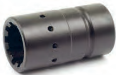
شکل ۲۳. واسطه انتقال بین جعبه دنده و دیفرانسیل و موقعیت آن روی تراکتور
