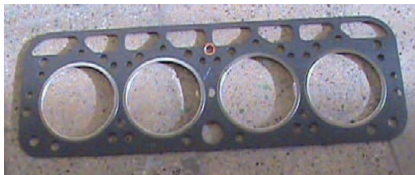
شکل ۱۳- واشر سر سیلندر تراکتور رومانی (U650)
