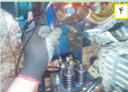
شکل ۳۷. فیلرگیری موتور تراکتور دوچرخ
