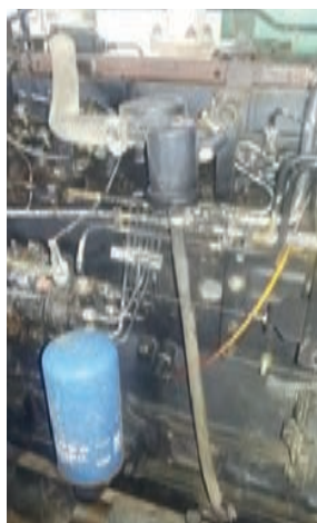
شکل ۳۹. تهویه محفظه کارتر در تراکتور MF399
