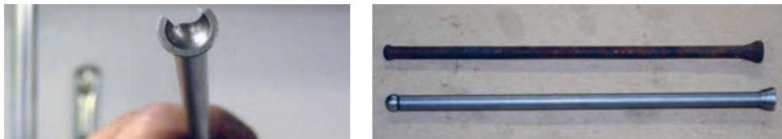
شکل ۷۶. زنگ زدن و شکستگی میل تپت
