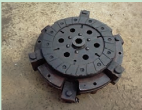
شکل ۲۵. جدا کردن مجموعه کلاچ از فلاپویل
