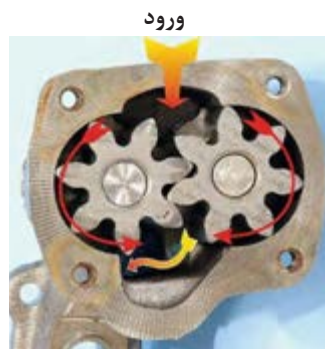
شکل ۴۲. پمپ روغن دنده ای
