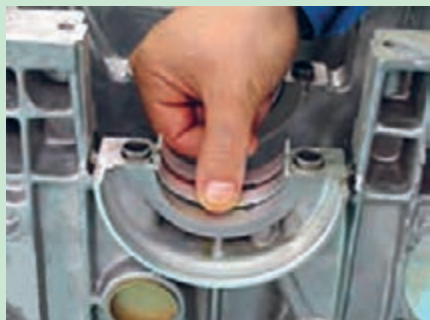
شکل ۵۰. برداشتن یاتاقان های ثابت و بغل یاتاقانی
