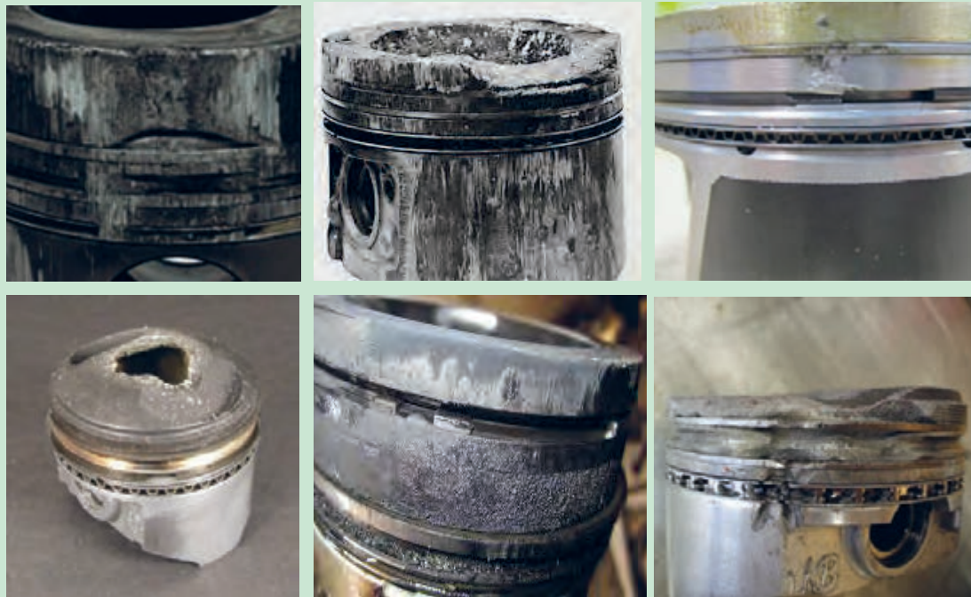
شکل ۷۴. نمونه ای از پیستون های معیوب
