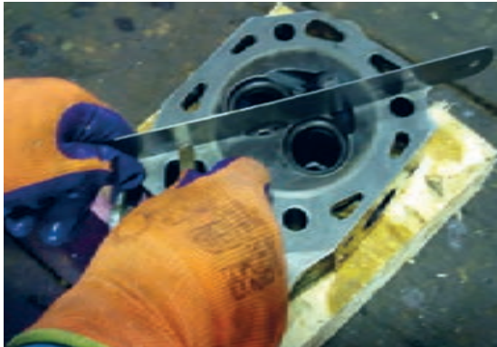
شکل ۶۵. کنترل تابیدگی سرسیلندر تراکتور دوچرخ
