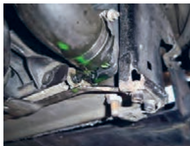
شکل ۵. نشتی از محل اتصالات
