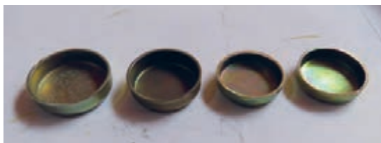
شکل ۲۹. انواع پولکی سر سیلندر تراکتور و نشتی آب از پولکی
