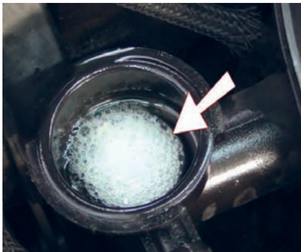
شکل ۳۳. خروج حباب از رادیاتور
