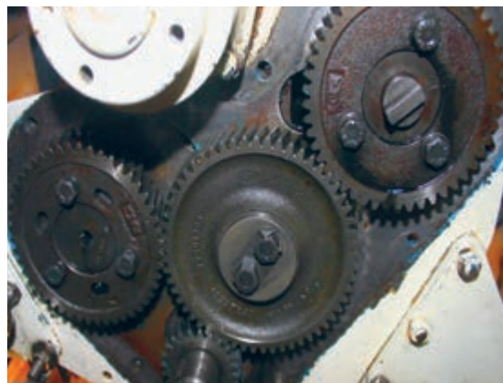
شکل ۲۷. چرخ دنده‌های تایمینگ در سینی جلو موتور
