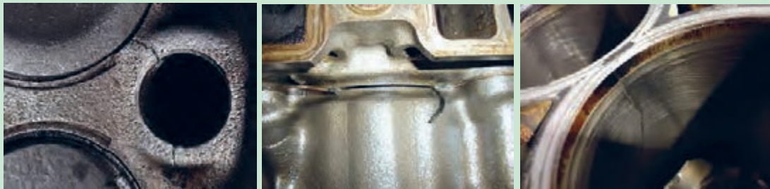
شکل ۶۲. ترک در سیلندر و بلوکه سیلندر
