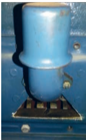
۴۰. تهویه محفظه کارتر در تراکتور U650
