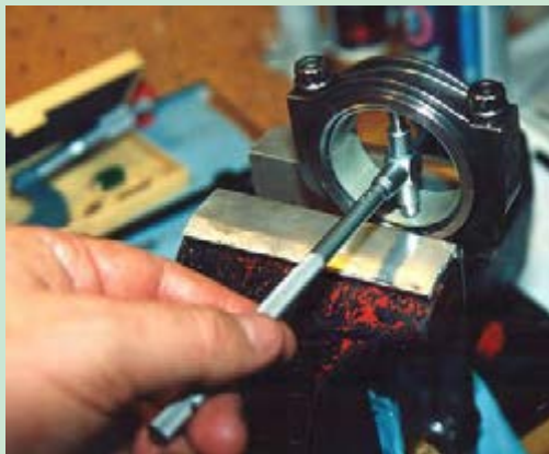
شکل ۸۳. کنترل بیضی شدن سر بزرگ شاتون
