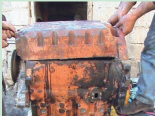
شکل ۱۱۵. نصب کارتر روی بلوکه سیلندر
