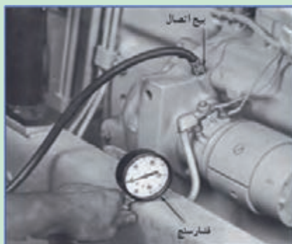
شکل ۵°. فشار سنجی مدار روغن کاری
