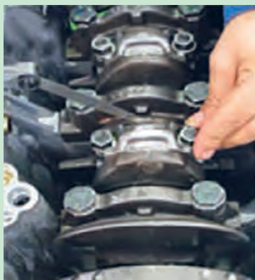
شکل ۱۰۲. کنترل لقی شاتون روی محور میل لنگ
