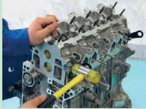
شکل ۴۹. آزاد کردن چسبیدگی سر سیلندر
