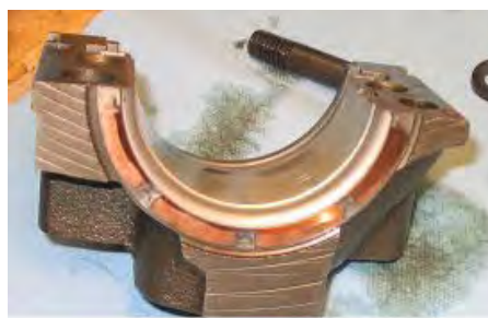
شکل ۷۳. نمونه بغل یاتاقانی معیوب
