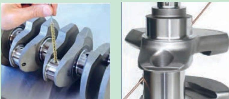
شکل ۶۰. تمیز کردن مجاری میل لنگ
