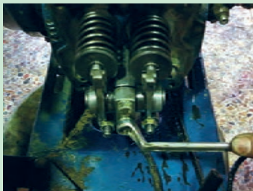
شکل ۵۴. باز کردن مجموعه اسبک‌ها
