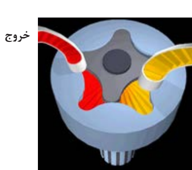
شکل ۴۳. پمپ روغن روتوری
