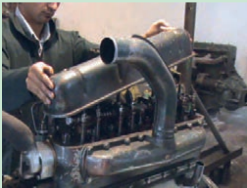
شکل ۴۴. برداشتن درپوش سوپاپ‌های تراکتور U650
