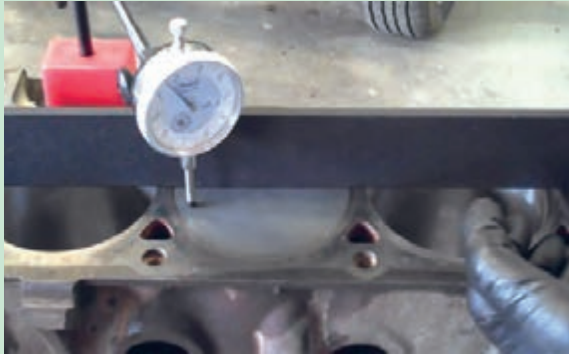
شکل ۱۰۳. کنترل سطح پیستون نسبت به سطح بلوکه سیلندر با فیلر و ساعت اندازه گیری
