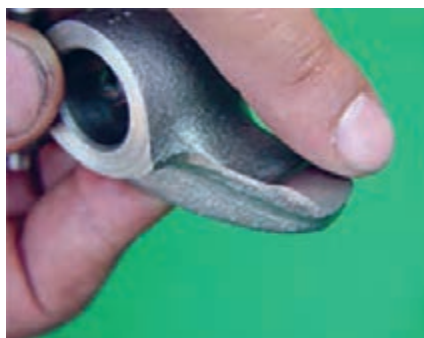
شکل ۷۵. فرسودگی سر اسبک
