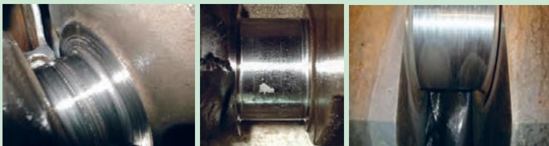
شکل ۷۰. نمونه‌ای از معایب رؤیت شده روی محورهای میل‌لنگ
