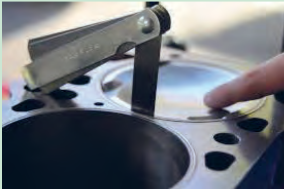
شکل ۷۷. اندازه گیری لقی پیستون در سیلندر با فیلر
