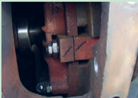
شکل ۲۶. علامتگذاری قطعات مجموعه کلاچ
