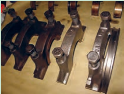
شکل ۴۸. برداشتن کپه های یاتاقان و چیدن آنها
