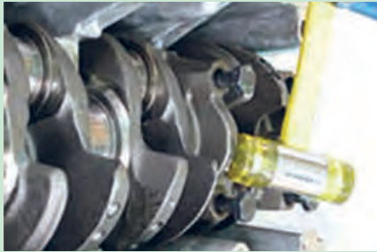
شکل ۴۷. شل کردن کپه های یاتاقان
