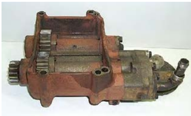
شکل ۴۴. بالانس‌های نصب شده روی پمپ روغن
