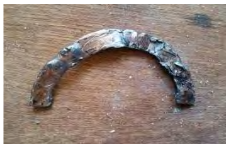
شکل ۷۳. نمونه بغل یاتاقانی معیوب
