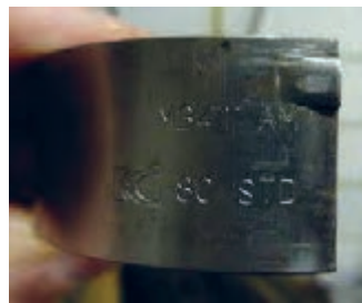
شکل ۲۳. تغییر ضخامت یاتاقان در سایزهای مختلف
