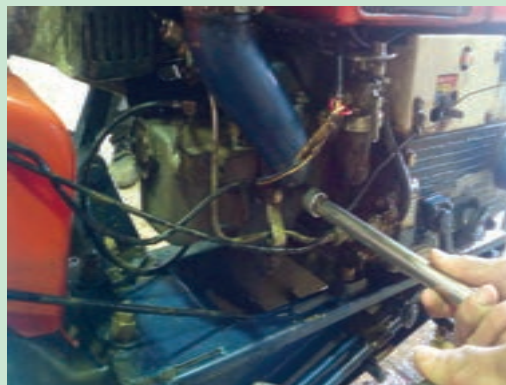
شکل ۵۲. باز کردن مانیفولد هوا
