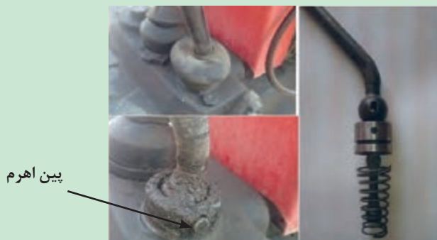
شکل ۲۹. خارج کردن اهرم‌های تعویض دنده
