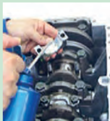
شکل ۱۰۱. روغن کاری کپه یاتاقان شاتون
