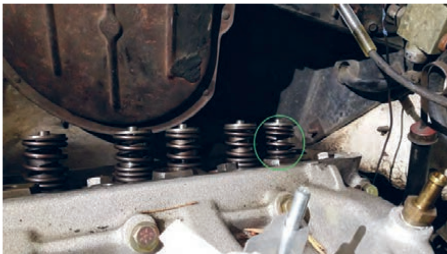
شکل ۷۱. شکستن فنر سوپاپ
