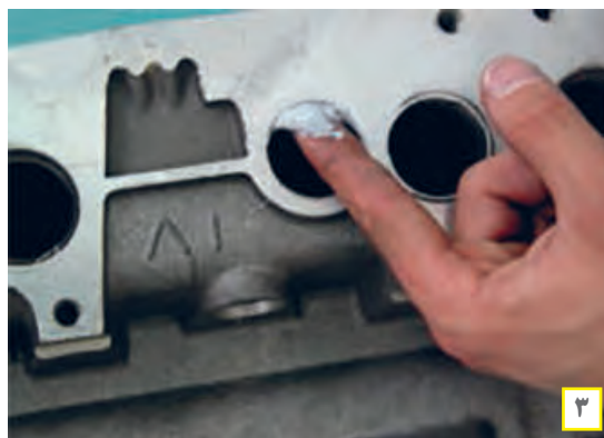
شکل ۶۹. روش تعویض پولک سر سیلندر
