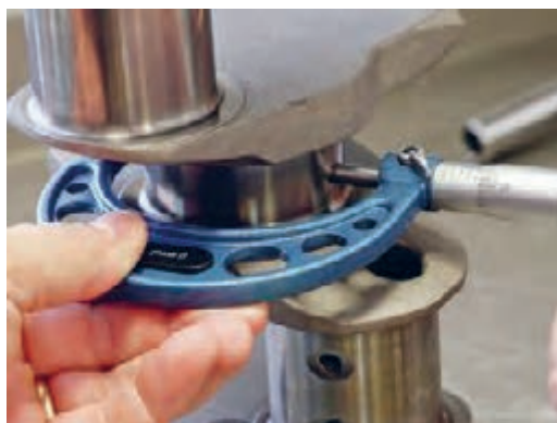
شکل ۷۱. اندازه‌گیری قطر میل‌لنگ
