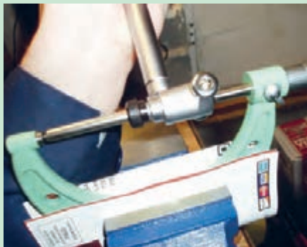
شکل ۷۶. اندازه‌گیری قطر سیلندر با میکرومتر داخلی
