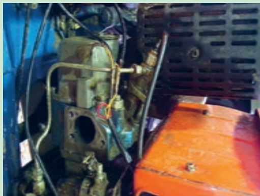
شکل ۵۲. باز کردن مانیفولد هوا
