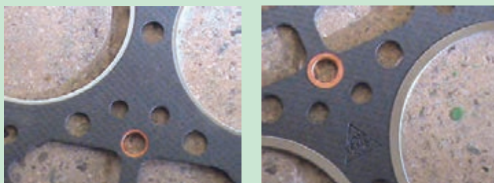
شکل ۸۷. تفاوت ضخامت قسمت‌های مسی روی واشر سرسیلندر
