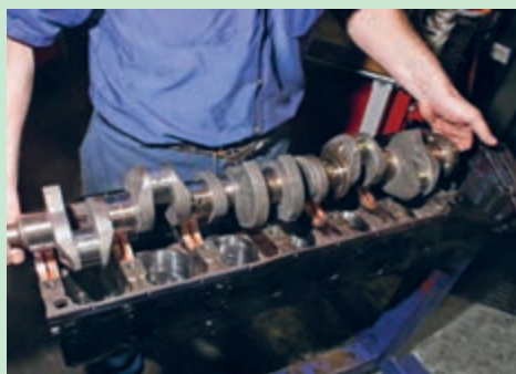
شکل ۴۹. برداشتن میل لنگ
