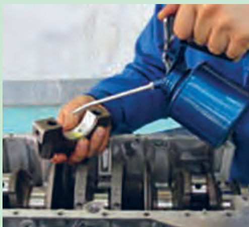
شکل ۹۵. روغنکاری یاتاقان ها قبل از نصب
