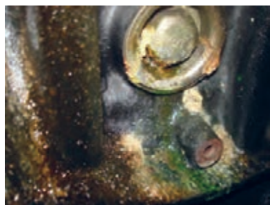
شکل ۷. نشتی از پولکی های موتور
