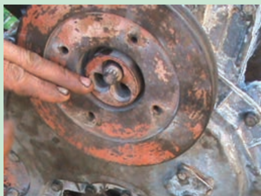
شکل ۱۱۳. پیچ‌های پولی سر میل لنگ
