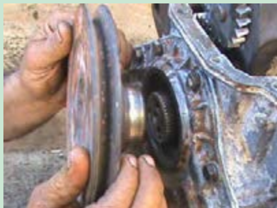
شکل ۳۵. پیاده کردن پولی میل لنگ
