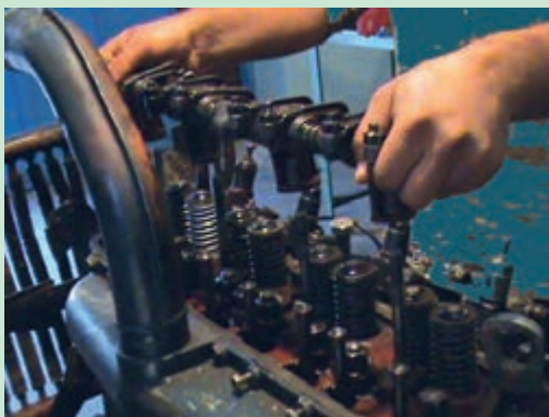
شکل ۴۶. برداشتن مجموعه اسبک از روی سرسیلندر
