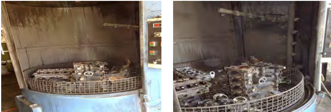
شکل ۶۱. شستشوی موتور به وسیله دستگاه شات بلاست
