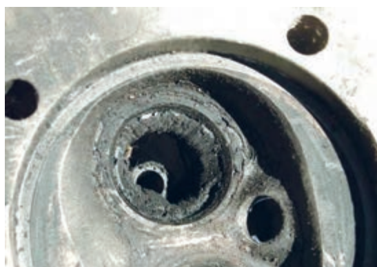
شکل ۶۷. کربن گرفتگی سرسیلندر و سوپاپ‌ها
