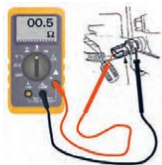
شکل ۴۹. کنترل فشنگی روغن
