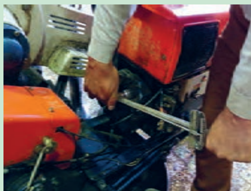
شکل ۵۵. باز کردن سر سیلندر
