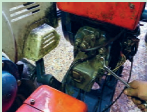
شکل ۵۳. باز کردن درپوش سوپاپ‌ها
