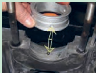
شکل ۹۳. قرار گرفتن سوراخ روغن مقابل هم
