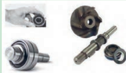
شکل ۱۸. نحوه قرار دادن بلبرینگ ها روی محور پمپ
