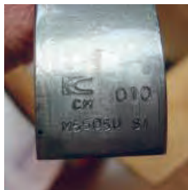
شکل ۲۳. تغییر ضخامت یاتاقان در سایزهای مختلف
