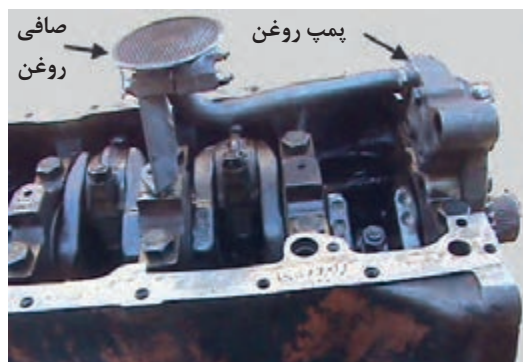
شکل ۴۱. پمپ روغن موتور و صافی آن
