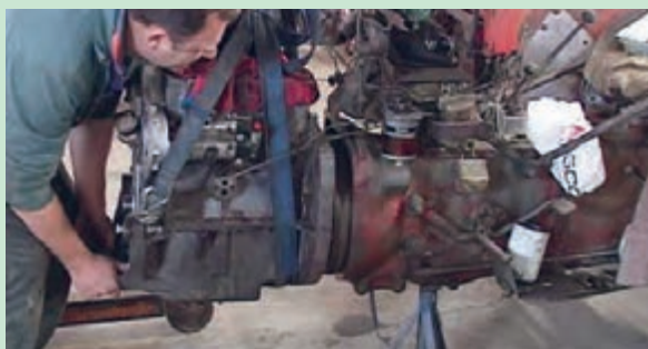
شکل ۳۲. جدا کردن موتور از جعبه دنده
