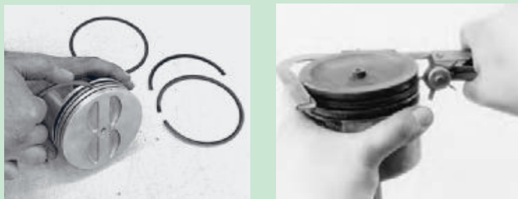
شکل ۵۸. روش های تمیز کردن شیار رینگ پیستون
