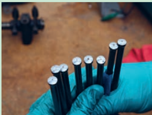
شکل ۴۷. خارج کردن میل تپت‌ها
