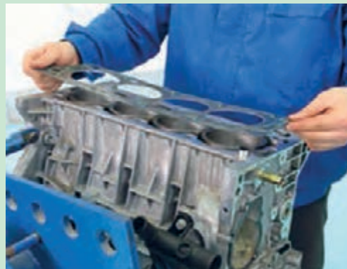
شکل ۵۰. برداشتن و اثر سر سیلندر
