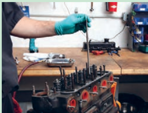
شکل ۴۷. خارج کردن میل تپت‌ها
