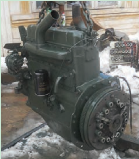
شکل ۲۴. پیاده کردن موتور تراکتور U650
