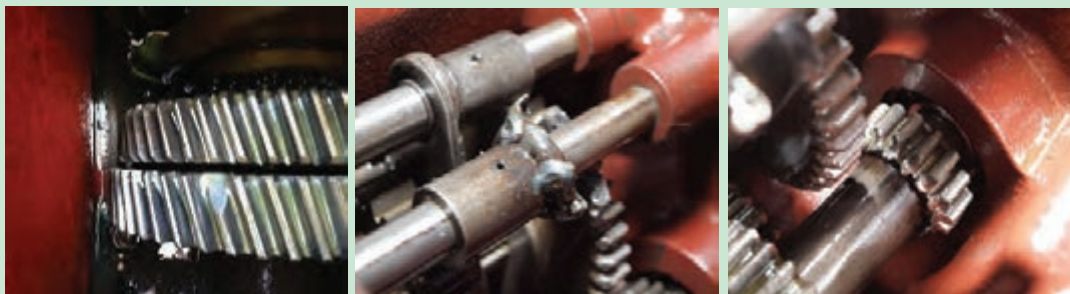
شکل ۴۰. برخی ایرادات قطعات جعبه دنده
