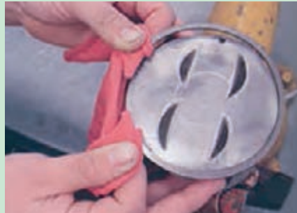
شکل ۵۳. خارج کردن رینگ بدون رینگ بازکن
