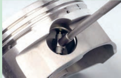
شکل ۸۱. اندازه گیری لقی گزن بین در پیستون
