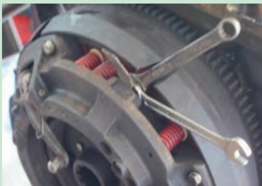
شکل ۳۹. تنظیم کلاچ محور تواندهی
