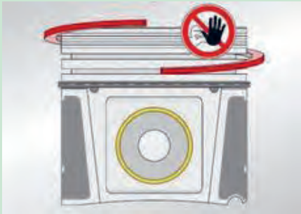
شکل ۵۳. خارج کردن رینگ بدون رینگ بازکن
