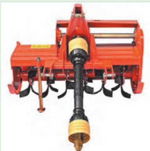
شکل ۲۵-۱. گاردان متصل به رتیواتور
