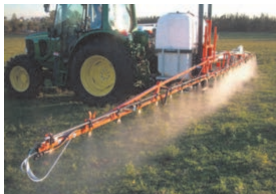
شکل ۳۰-۴. سم پاش بوم دار در دو حالت کار و حمل و نقل
