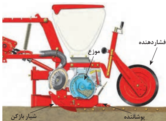
شکل ۱۴-۳. اصول کاشت بذر با کارنده
