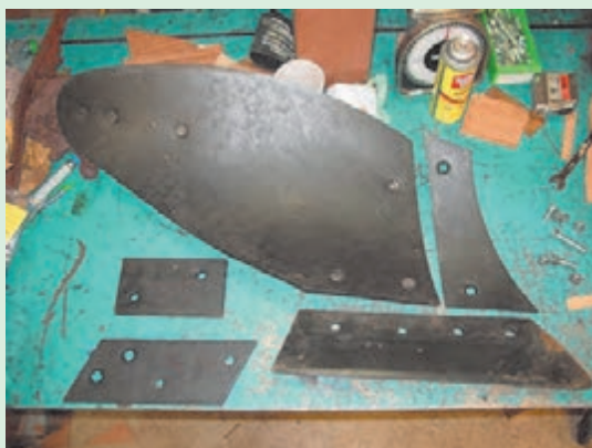
شکل ۲۰-۱. چیدمان اجزای بازشده خیش در کنار یکدیگر
