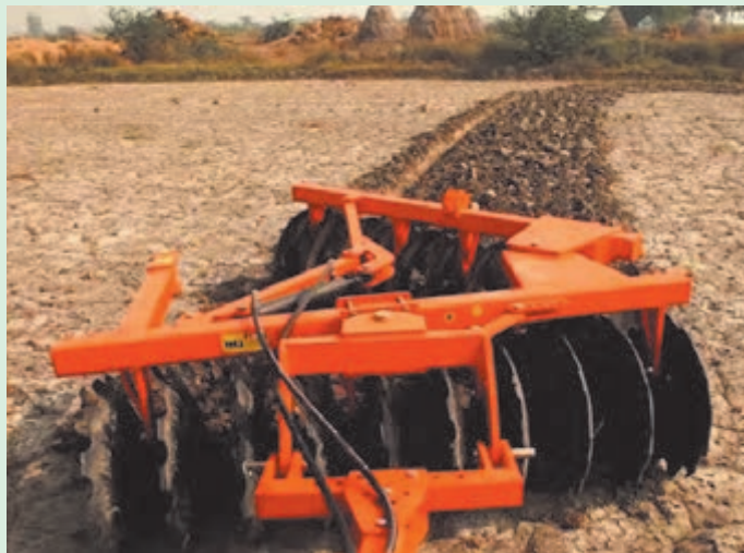
الف. تنظیم زاویه برش به وسیله جک
