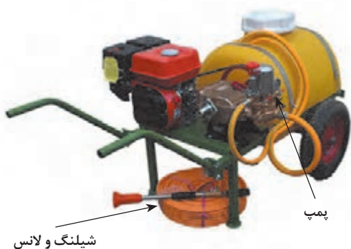
شکل ۲۹-۴. سم‌پاش فرغونی و اجزای آن
