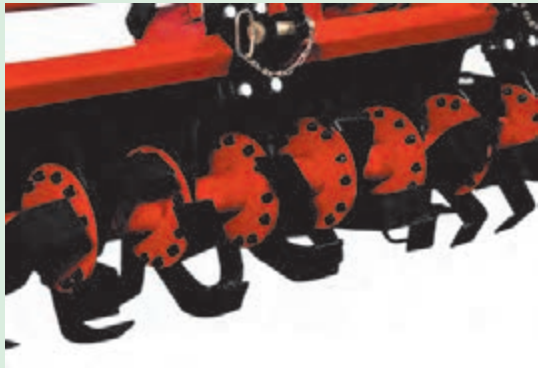
شکل ۲۲-۱. نقاط اتصال تیغه‌ها به فلانچ
