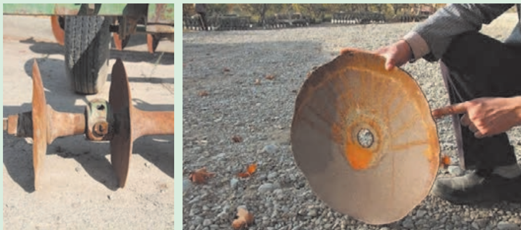
شکل ۱۵-۲. بررسی بشقاب‌ها و یاتاقان‌ها
