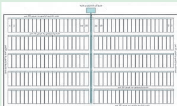
شکل ۴۷-۵. ترتیب جابجایی مناطق آبیاری
