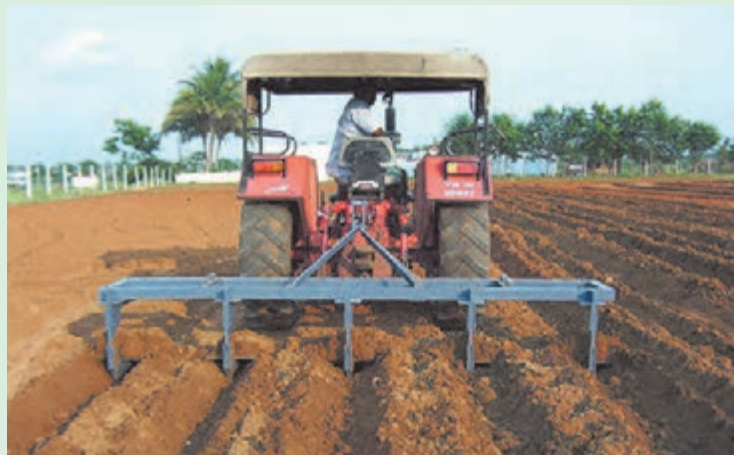
الف- قرار دادن یکی از شیار بازکن‌ها در داخل شیار
