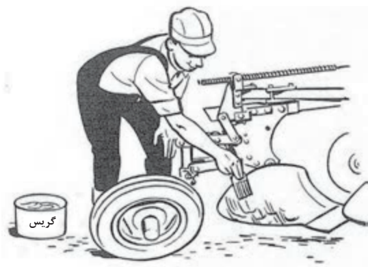
شکل ۵۲-۱. اندود کردن قطعات گاوآهن با مواد ضدزنگ
