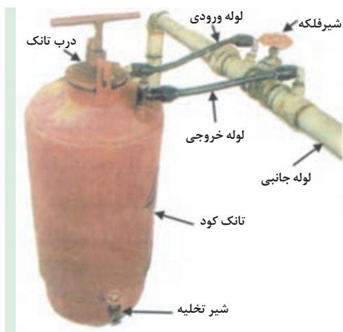
شکل ۴۹-۵. اجزای سیستم توزیع کود
