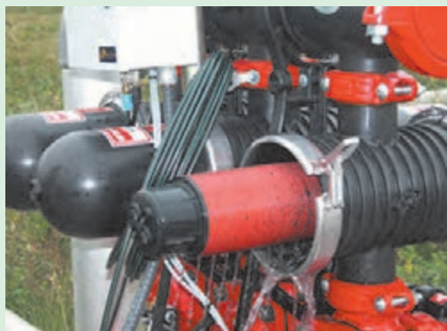
شکل ۶۰-۵. شست و شوی دستی صافی دیسکی
