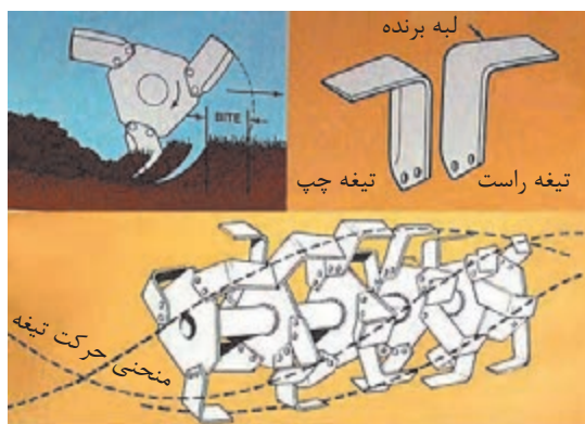
شکل ۱۵-۱. آرایش مارپیچ تیغه‌های گاواهن دوار
