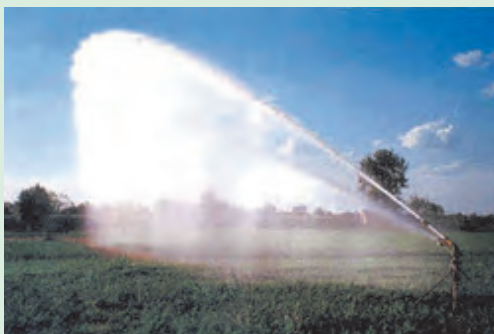
شکل ۳۳-۵. شکل مناسب فوران آب
