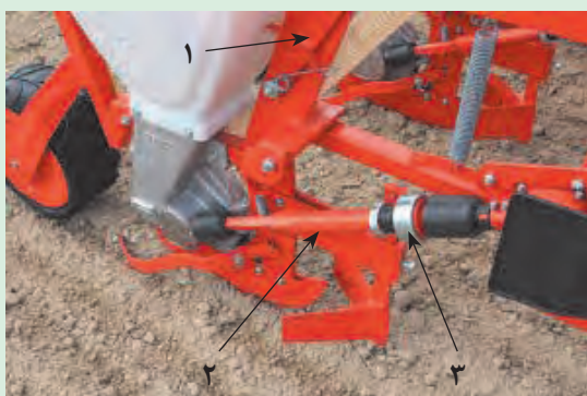
شکل ۲۷-۳. حذف واحد کارنده در یک نمونه ردیف‌کار
