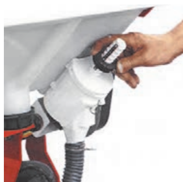
الف- موزع در کودکار فاروئر و پنجه کودریز برای تنظیم مقدار پخش کود
