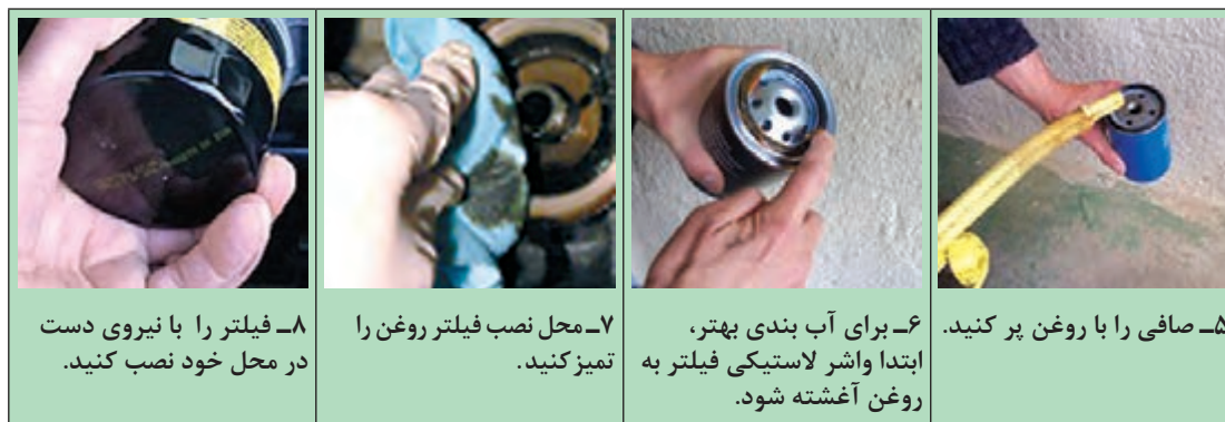
شکل ۵۰-۱- مراحل تعویض صافی روغن
