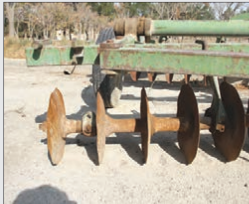
شکل ۱۹-۴- یاتاقان خراب بشقاب
