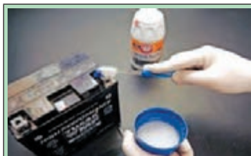
شکل ۱۸-۱- شست و شوی قطب‌ها با جوش شیرین و آب گرم
