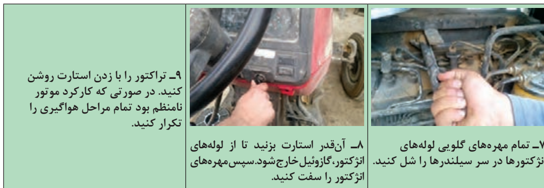
شکل ۴۰-۱- مراحل هواگیری سیستم سوخت رسانی
