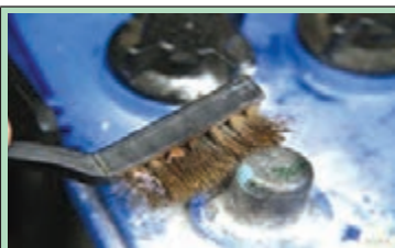
شکل ۱۷-۱- تمیز کردن قطب‌ها با برس سیمی
