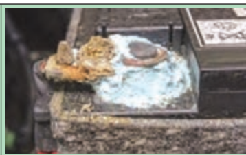
شکل ۱۶-۱- سولفاته شدن قطب‌های باتری
