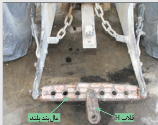
شکل ۱۵-۵- مال‌بند بلند برای اتصال ماشین هموارکننده نیمه‌سوار
