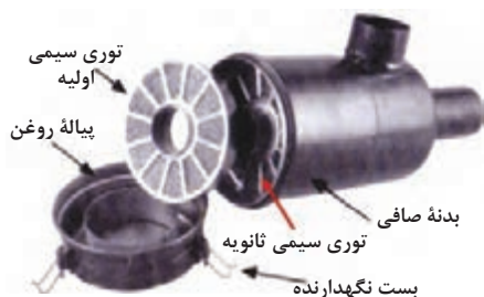
شکل ۲۶-۱- اجزای تشکیل دهنده صافی روغنی
