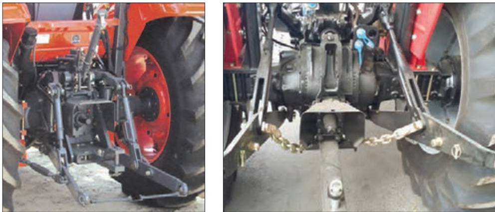
شکل ۳۲-۳- زنجیر تنظیم تعادل یا نوسان گیر
