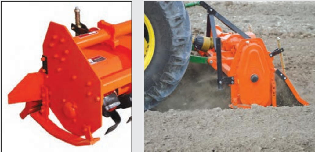
شکل ۳۴-۴- تنظیم درپوش و عمق کار
