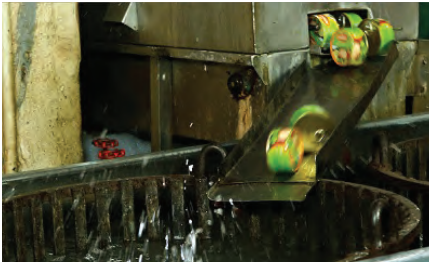
شکل ۲- وارد شدن قوطی‌های فلزی به سبدهای اتوکلاو
