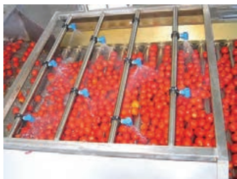
شکل ۶- شست‌وشو با پاشش آب
