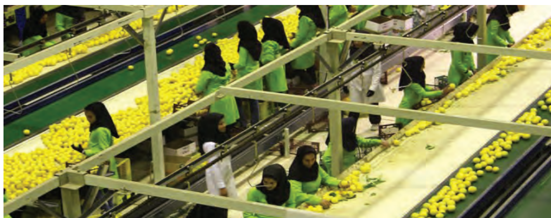
شکل ۹- بازیینی یا سورتینگ دستی
