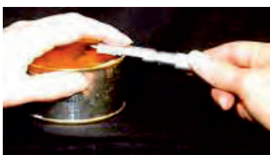
شکل ۴- اندازه‌گیری عرض دوخت
