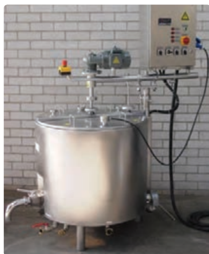
شکل ۱-۱۷- سیستم پاستوریزاسیون غیرمداوم
