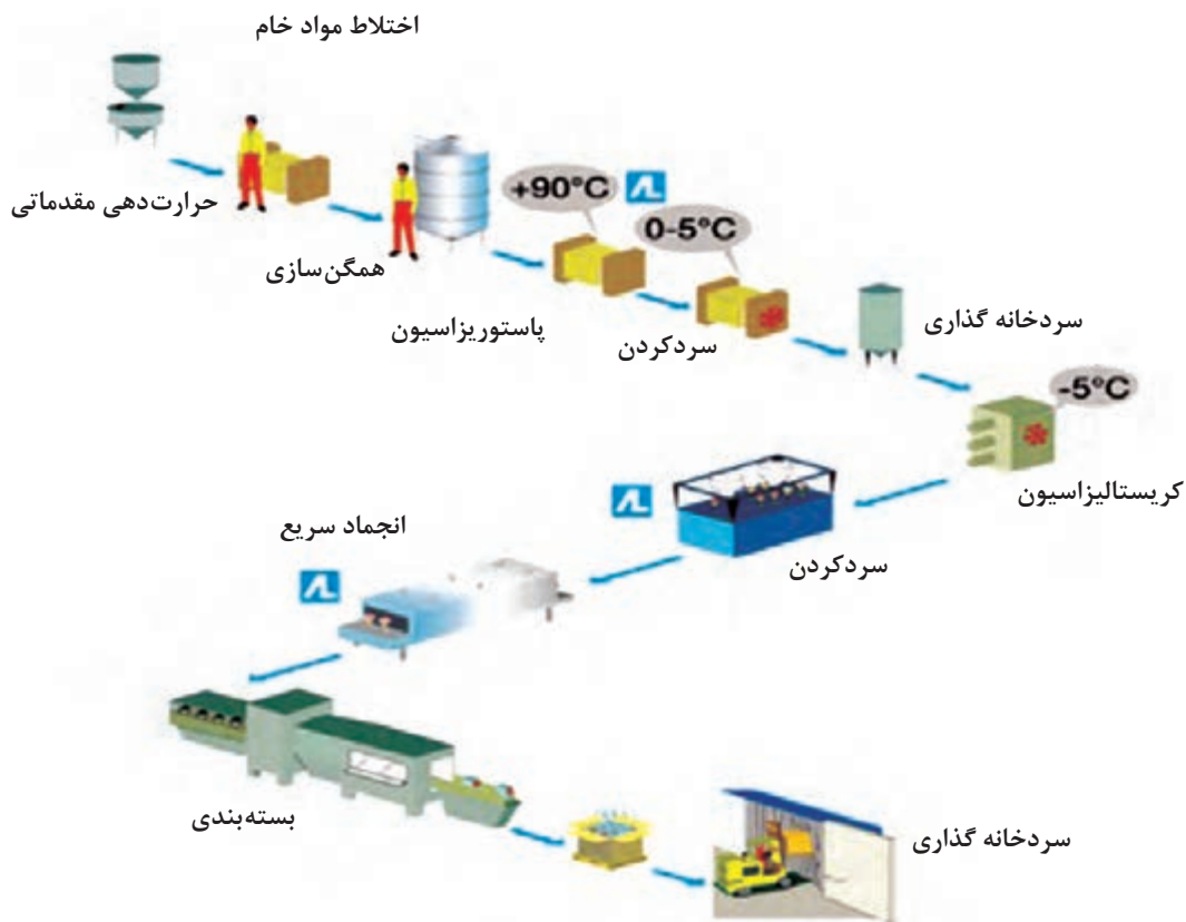
شکل ۳-۸ - فرایند تولید بستنی
