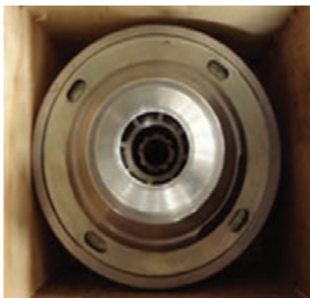
شکل ۵-۶- سپراتور و صفحات داخلی آن
