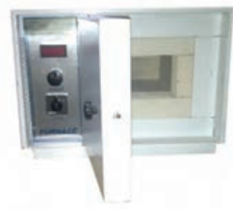
شکل ۲-۱۶- وسایل مورد استفاده برای آزمایش اندازه‌گیری خاکستر
