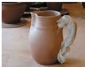
شکل ۱۸- پوشاندن دسته قطعه با نایلون
