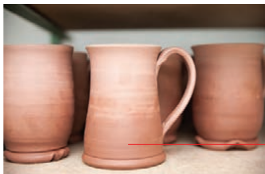
شکل ۱۴- قسمت زیرین ضخامت بیشتری دارد و هنوز رطوبت آن تبخیر نشده است.
