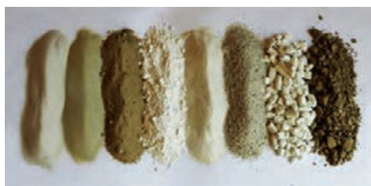
شکل ۳۲- دانه‌بندی انواع شاموت
