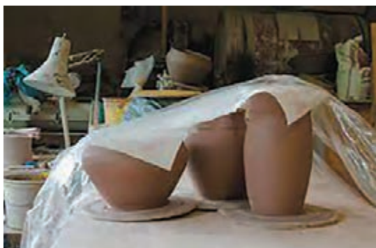
شکل ۱۵- بخش بالایی قطعات و یا هر جایی که ضخامت کمتری دارد باید با نایلون پوشانند.
