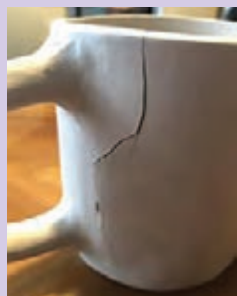
شکل ۱۱- مشکلات ترک خوردگی و شکستن قطعه به دلیل خشک شدن ناهمگن
