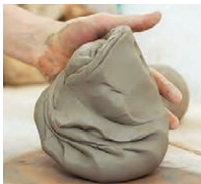
شکل ۱۷- خاصیت پلاستیسیته در گل سبب می شود بعد ایجاد فشار، گل به همان حالت باقی بماند
