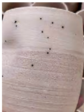
شکل ۲۵- لکه های حاصل از سوختن مواد آلی
