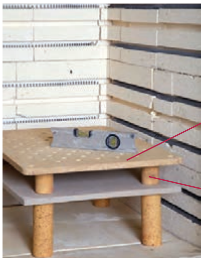
شکل ۲۸- تراز بودن هر طبقه از کوره
