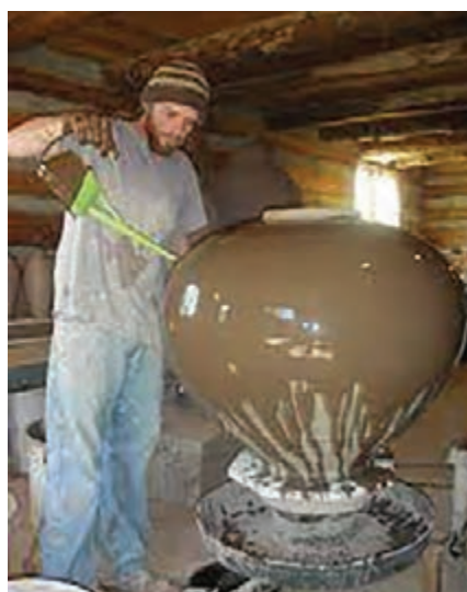
شکل ۳۹- نحوه قرارگیری قطعات بزرگ روی پایه گردان و ریختن لعاب
