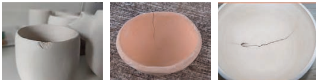
شکل ۳- قطعات معیوب (ترک دار و لب پریده)
