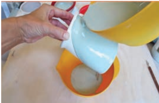
شکل ۳۶- نحوه نگه داشتن قطعه از دهانه
