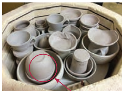
شکل ۴۳- قرارگیری ظروف گود از لبه‌ها بر روی یکدیگر
