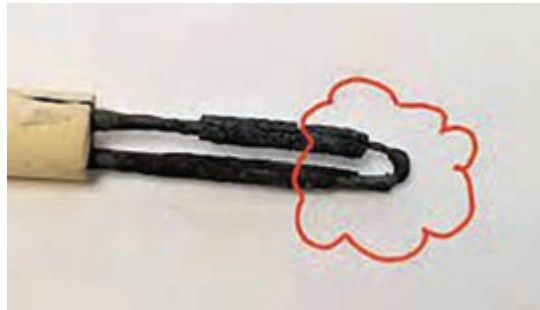
شکل ۱۷- ترموکوپل اکسید شده
