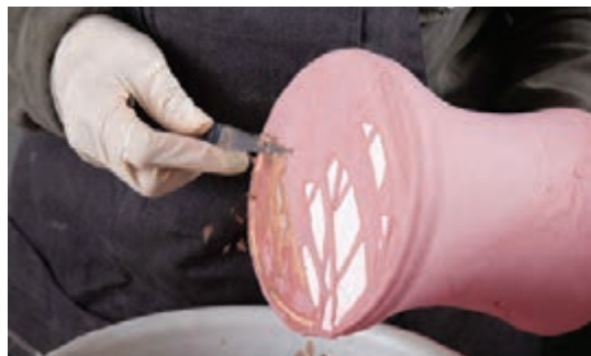
شکل ۴۱- تمیز کردن کف ظرف با ابزار برش
