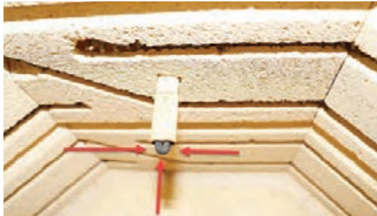
شکل ۱۸- محل قرارگیری ترموکوپل در داخل کوره الکتریکی
