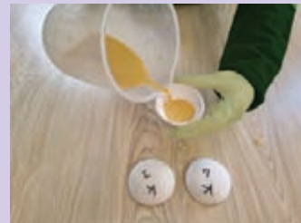
ریختن لعاب درون نمونه پیاله‌ای
