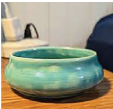
شکل ۱۶- تشکیل لعاب با ضخامت نازک ناشی از چگالی کم دوغاب
