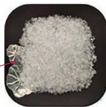
شکل ۷- مواد فریت شده که پس از سرد شدن به صورت شیشه درآمده است
