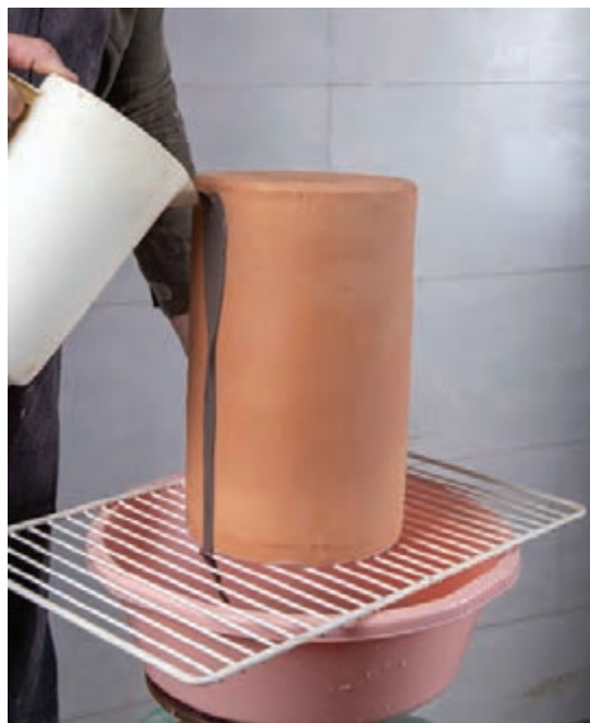
شکل ۳۴- ریختن روی سطح بیرونی قطعه قرار گرفته روی سطح ثابت یا پایه گردان
