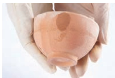
شکل ۱۰- اثر چربی روی قطعه سرامیکی
