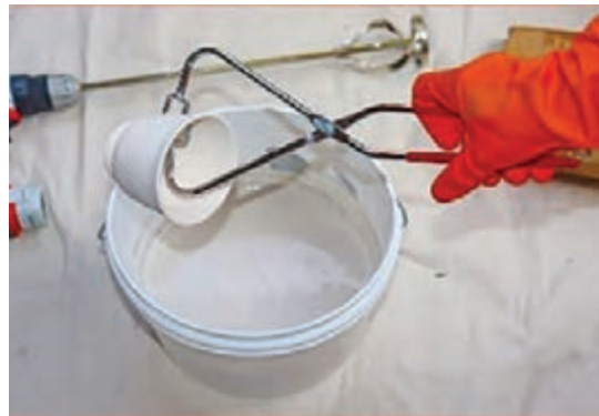
شکل ۲۳- لعاب‌زنی به روش غوطه‌وری
