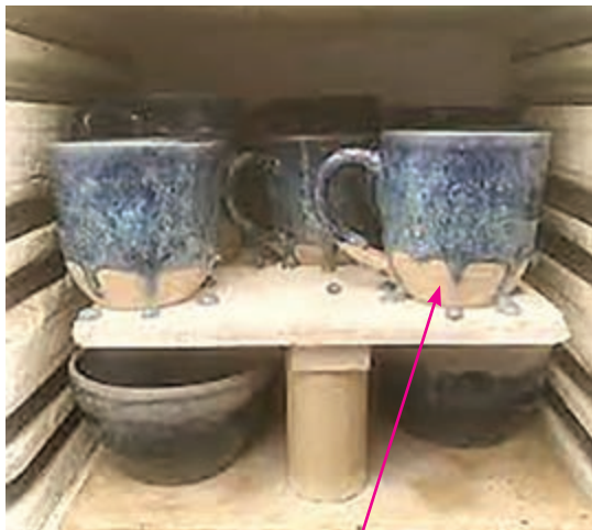
شکل ۶- شوره کردن لعاب و صدمه به طبقات کوره
