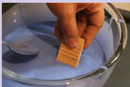
فرو بردن نمونه درون ظرف لعاب
