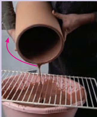
خالی کردن لعاب اضافی مطابق شکل
