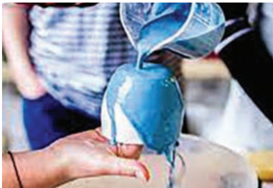
شکل ۳۸- نحوه نگه داشتن قطعه از دهانه گشاد
