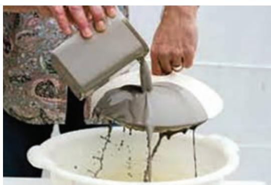
شکل ۳۷- نحوه نگه داشتن قطعه از دهانه تنگ
