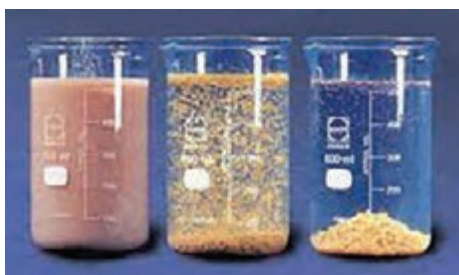
شکل ۵- تفاوت مواد معلق، ته‌نشینی شده و دوغاب
