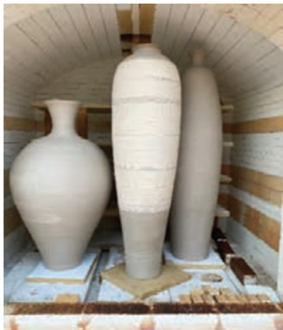
شکل ۴۶- گلدان‌هایی با ضخامت کم مجزا چیدمان شده‌اند
