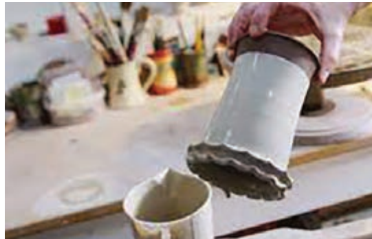
شکل ۳۵- نحوه نگه داشتن قطعه از پایه
