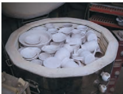
شکل ۳۵- پر کردن بیش از اندازه کوره
