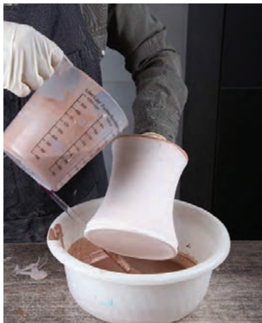
شکل ۳۳- ریختن لعاب روی سطح بیرونی قطعه نگه داشته شده با دست
