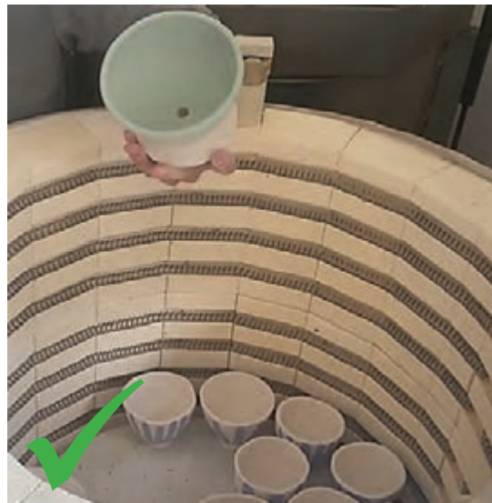
شکل ۳- نحوه صحیح گرفتن قطعه لعاب خورده
