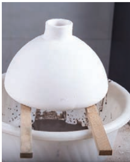
شکل ۴۰- نحوه قرارگیری قطعه روی سطح ثابت
