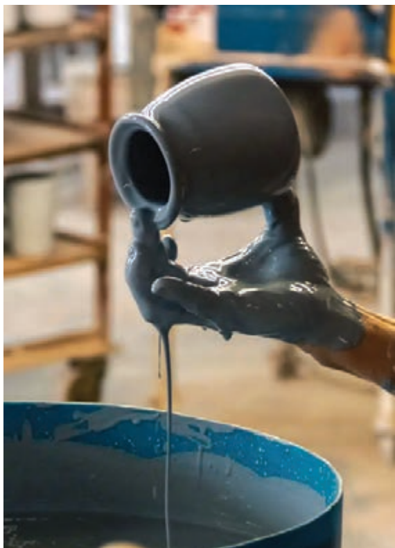
شکل ۱- غوطه‌ور کردن قطعه در دوغاب لعاب
