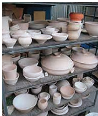
شکل ۴۷- چیدن قطعات بیسکویت شده در قفسه و جداسازی قطعات از یکدیگر
