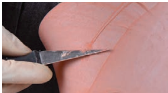
شکل ۴۳- تراشیدن شره‌های ضخیم با ابزار برش
