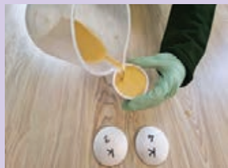
پر کردن لعاب درون نمونه پیاله‌ای
