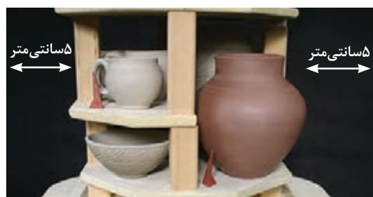
شکل ۲۹- فاصله مناسب از المنت‌ها
