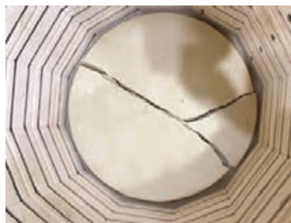
شکل ۳۴- شکستن صفحه کوره به علت وزن بیش از اندازه
