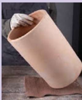
نحوه قرارگیری قطعه بزرگ روی موکت
