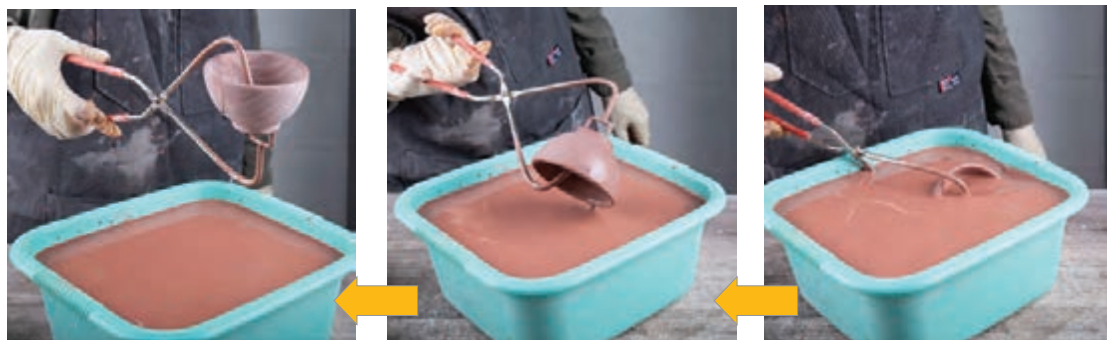
شکل ۱۲- مراحل خارج کردن قطعه از دوغاب
