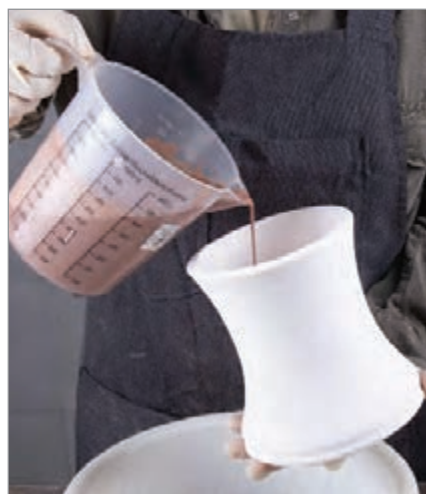
شکل ۳۱- ریختن لعاب به داخل قطعه نگه داشته شده با دست
