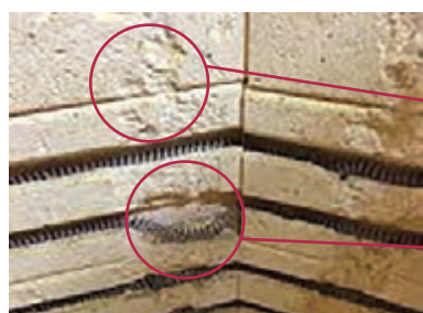
شکل ۳۰- آسیب دیدن دیواره کوره و المنت‌ها به دلیل چسبیدن قطعات به دیواره
