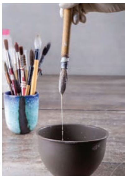
شکل ۳۱- خط ممتد ریزش لعاب
