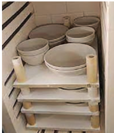
شکل ۴۱- چیدمان بشقاب درون کوره
