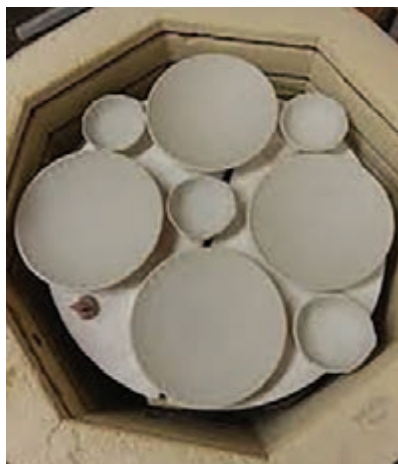
شکل ۴۲- چیدمان بشقاب درون کوره به صورت منفرد
