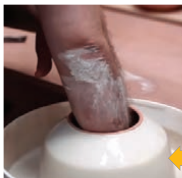
شکل ۸- نگه داشتن قطعه به کمک حفره داخلی
