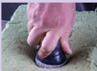
فرم دادن گل برش خورده به کمک قالب چوبی فرم دهنده
