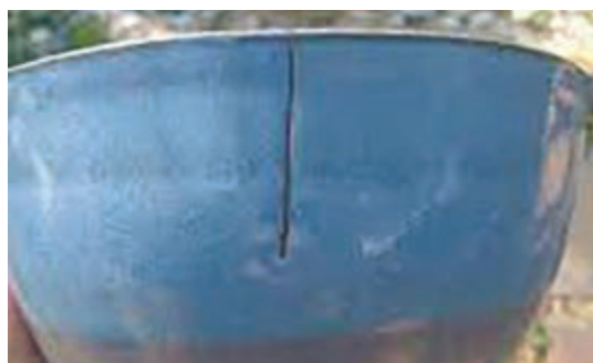
شکل ۴- اثر ترک‌های سطحی بعد از لعاب
