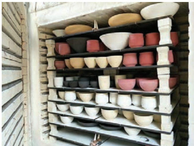
شکل ۱۵- چیدمان استاندارد کوره لعاب
