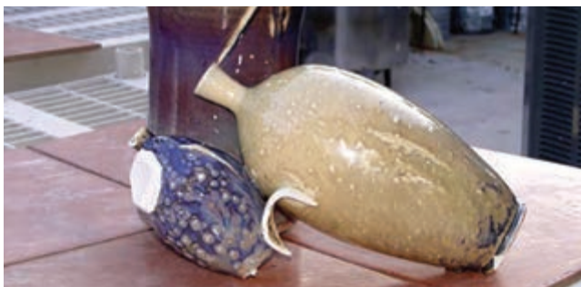
شکل ۵- قطعات به هم چسبیده در کوره
