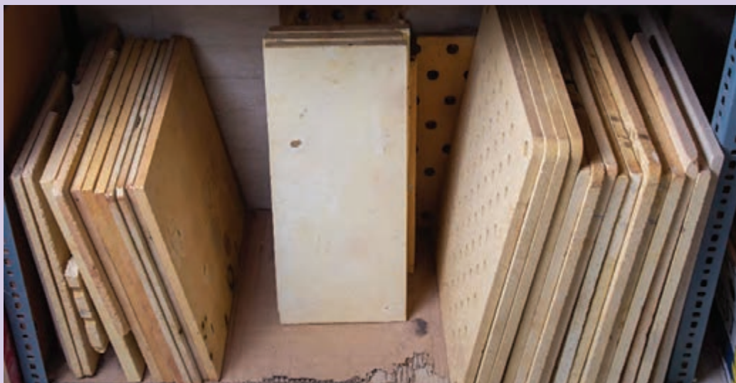
قرار دادن صفحات نسوز در قفسه مخصوص
