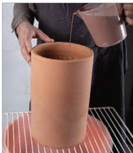
شکل ۳۲- ریختن لعاب داخل قطعه قرار گرفته روی سطح ثابت یا پایه گردان
