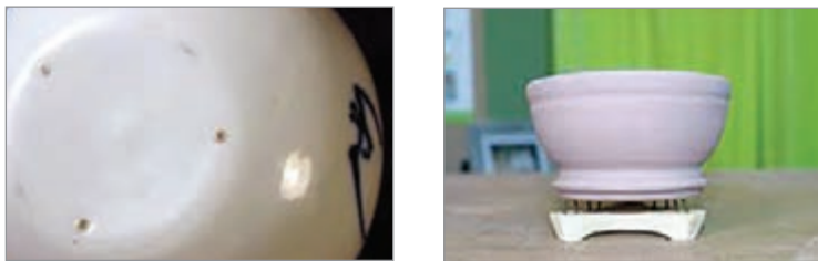
شکل ۱۲- قرار گرفتن قطعه لعابدار روی سه پایه شکل ۱۳- اثر سه پایه روی قطعه لعابدار
