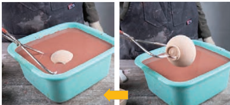
شکل ۱۱- مراحل وارد کردن قطعه در دوغاب
