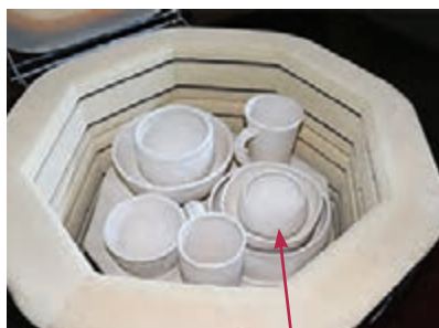
شکل ۴۴- قرارگیری ظروف گود و کاسه درون هم بر مبنای وزن و اندازه
