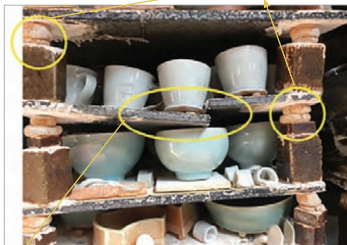
شکل ۳۱- عدم رعایت وزن مناسب در چیدمان کوره
