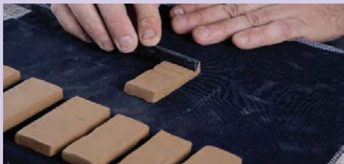
ایجاد شیار روی نمونه ساخته شده
