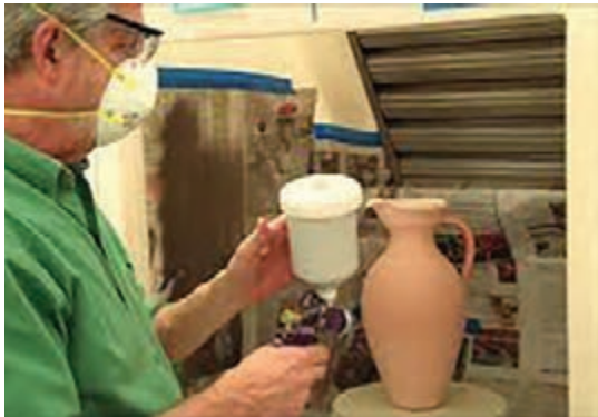
شکل ۲۴- لعاب‌زنی به روش اسپری
