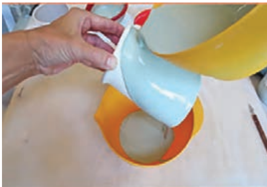
شکل ۲۶- لعاب‌زنی به روش ریختنی
