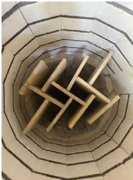
شکل ۴۰- چیدمان کاشی برجسته در داخل کوره
