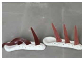
شکل ۱۹- مخروط‌های حرارتی پس از پخت در کوره لعاب
