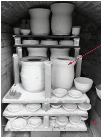
شکل ۳۹- چیدمان کوره - ضخامت قطعات
