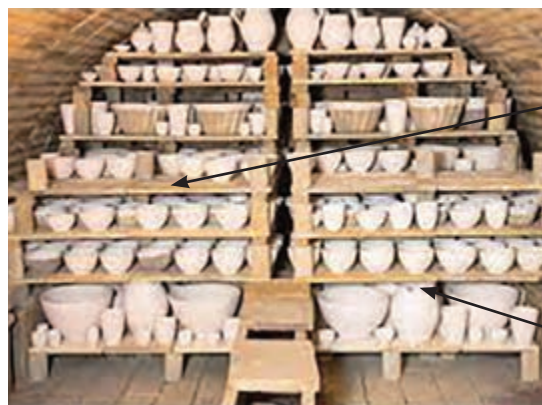
شکل ۳۷- چیدمان کوره - وزن قطعه
