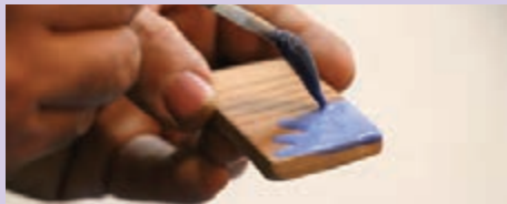
پوشش سطح قطعه با لعاب به‌وسیله قلم‌مو
