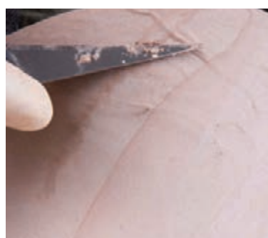
شکل ۱۳- تراشیدن لعاب اضافی
