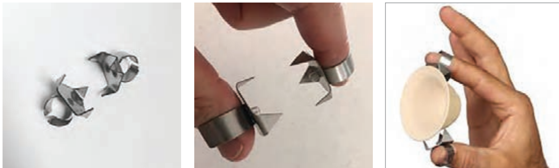
شکل ۹- گیره و روش گرفتن قطعه با آن
