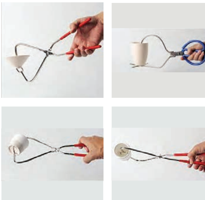
شکل ۱۰- انبر و روش‌های گرفتن قطعه با آن
