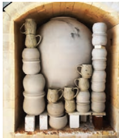
شکل ۴۵- گلدان‌هایی که از لبه روی هم قرار گرفته و چیدمان شده‌اند
