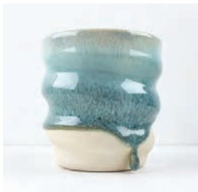
شکل ۱۵- شره کردن بخشی از لعاب ناشی از چگالی زیاد دوغاب
