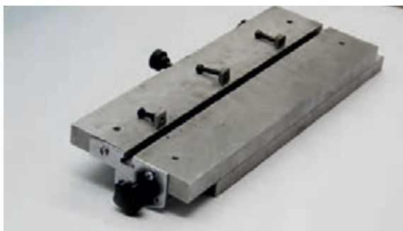
شکل ۲۶-۵ میز شیاردار- فیکسچر به همراه مهره های
