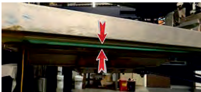
(شکل ۴-۱۷ فاصله بین توری و سطح چاپ شونده)
