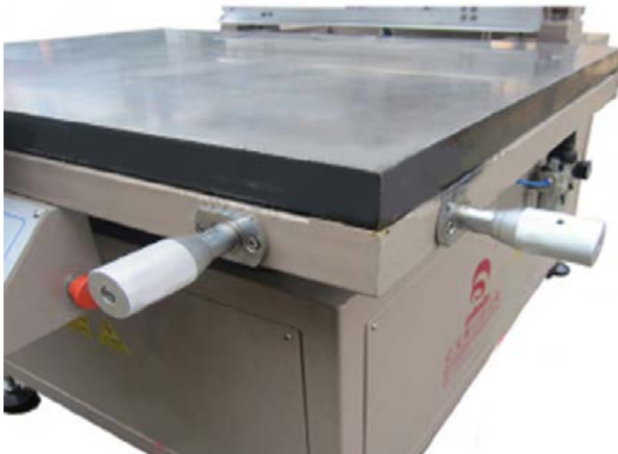
شکل ۳-۴ گونیا کردن طولی و عرضی با صفحه متحرک میز کار
