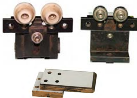
شکل ۲۱-۵ فیکسچر در شکل‌های مختلف
