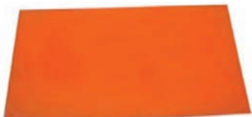
شکل ۴-۸- کلیشه خام فتوپلیمر
