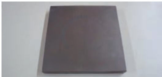
شکل ۴-۵- صفحه خام یا اسید کاری نشده کلیشه
