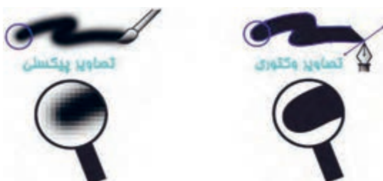
شکل ۲-۵- تفاوت تصویر رستری و وکتوری
