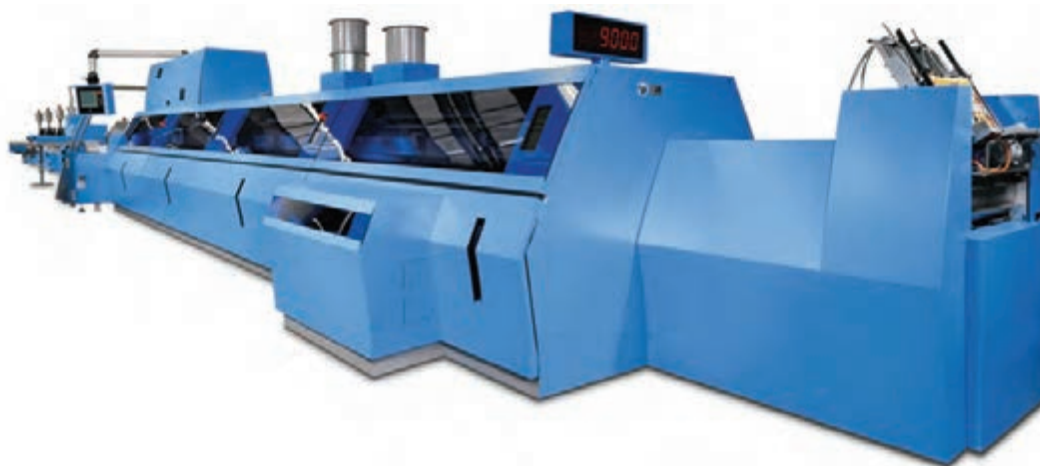
شکل ۳-۸۵- دستگاه صحافی چاپ سرد
