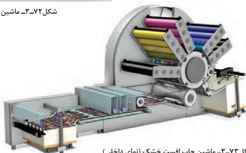
شکل ۳-۷۳- ماشین چاپ افست خشک (نمای داخلی)
