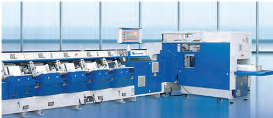
شکل ۳-۸۴- دستگاه صحافی چسب گرم
