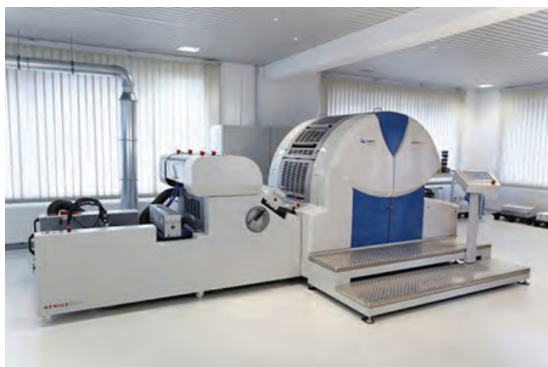
شکل ۳-۷۲- ماشین چاپ افست خشک (نمای خارجی)
