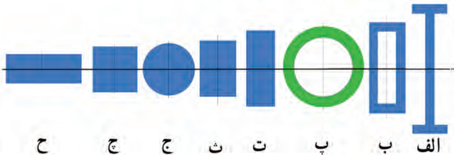
شکل ۵-۲۳ انواع سطح مقطع در خمش
