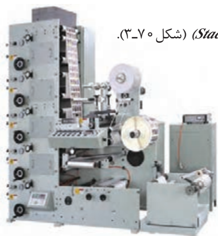
شکل ۳-۷۰ – ماشین چاپ فلکسوگرافی ایستاده
