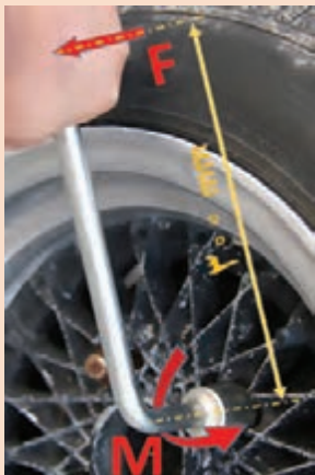
شکل ۵-۱۱ باز کردن پیچ چرخ خودرو توسط آچار چرخ
