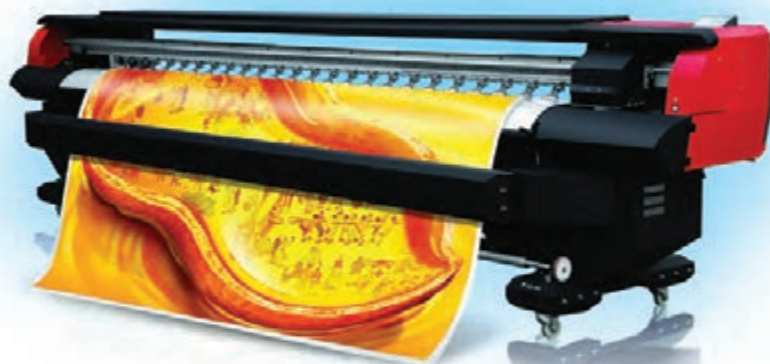
شکل ۳-۷۸- ماشین چاپ جوهر افشان Large Format
