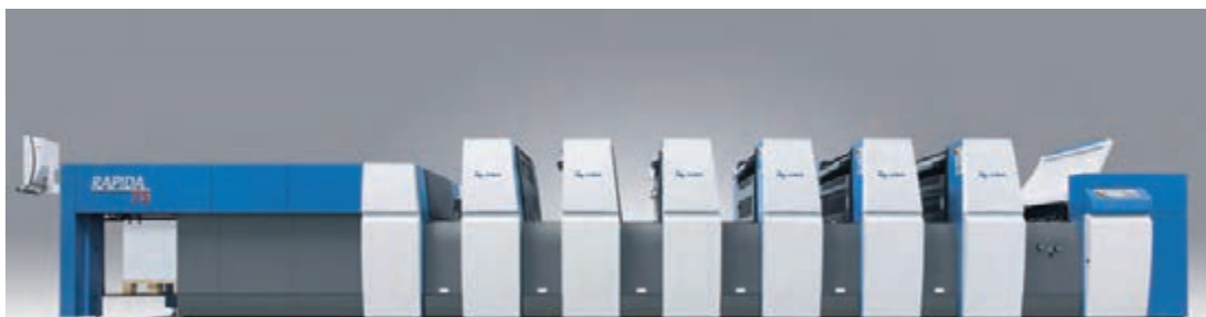
شکل ۳-۷۱- ماشین چاپ افست لیتوگرافی
