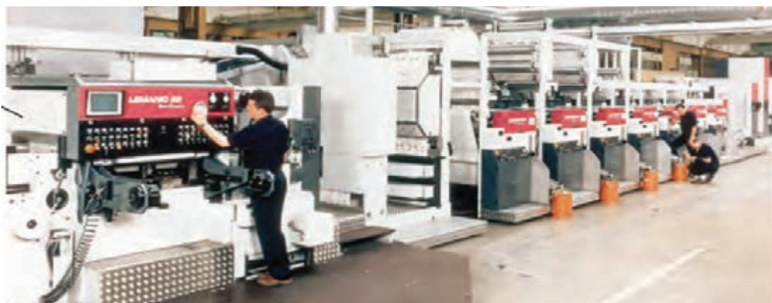
شکل ۳-۶۹ – ماشین چاپ فلکسوگرافی
