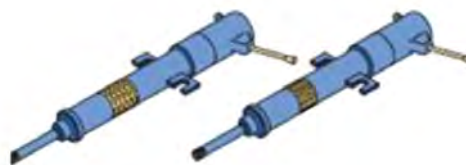
ستون فرمان لوله مشبک
