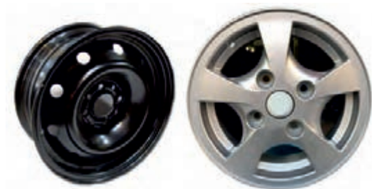
شکل ۱۰- رینگ آلومینیومی و فولادی
