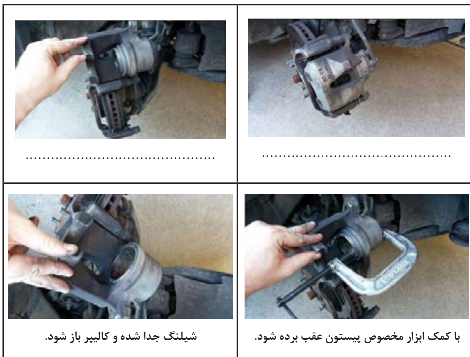
شکل ۳۳- مراحل باز کردن کالیپر ترمز
