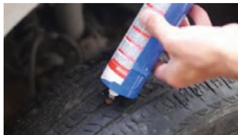
شکل ۲۷- مراحل پنچرگیری تایر بدون تیوب
