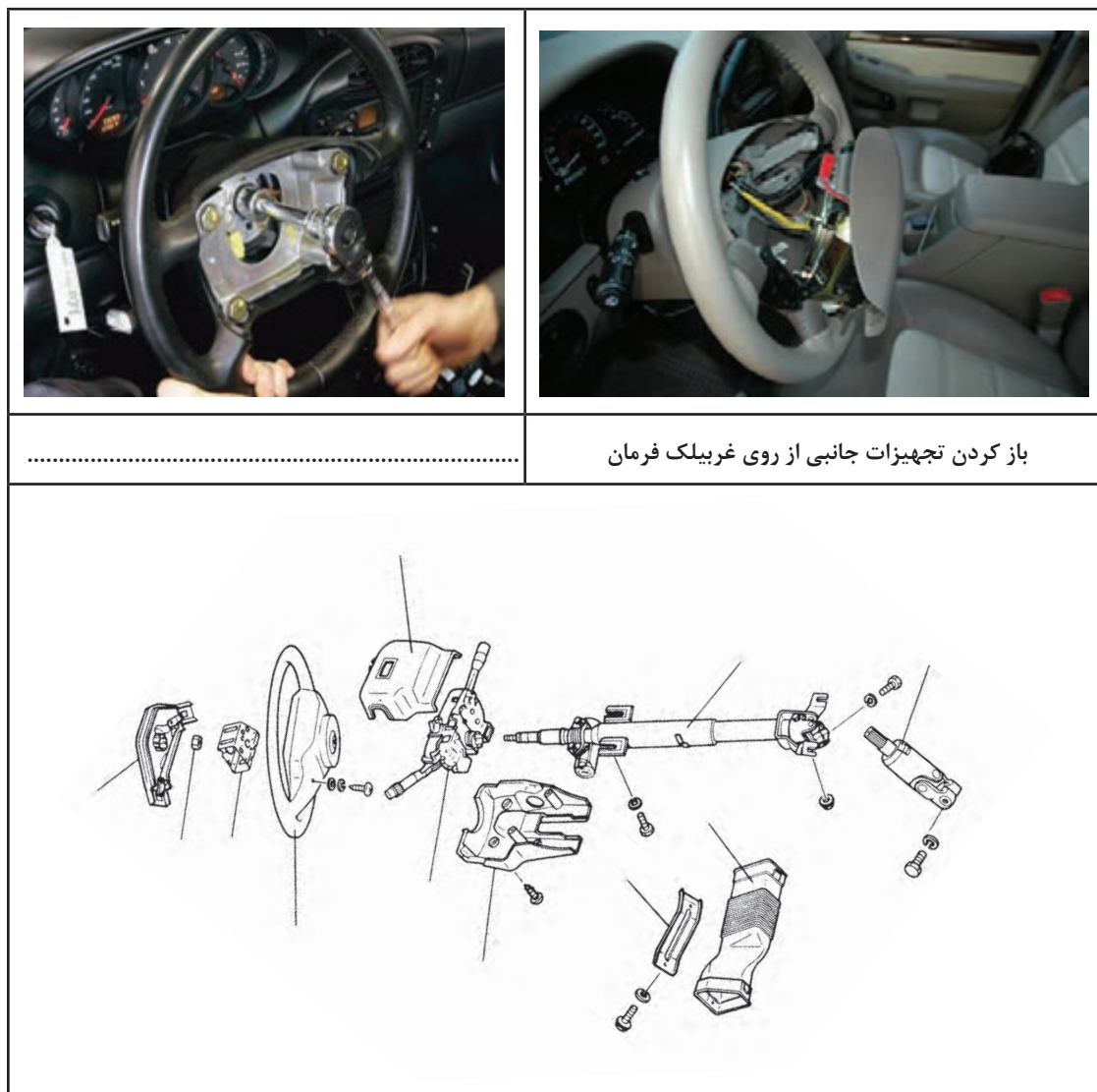
شکل ۲۳- راهنمای تعمیراتی باز کردن یک نمونه از مجموعه ستون فرمان
