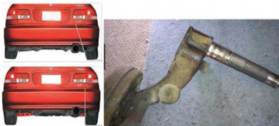
شکل ۴۳- خرابی بوش‌ها و تأثیر آن روی چرخ
