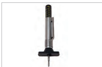
شکل ۱۵- ابزار مخصوص بررسی آج تایر و شاخص ساییدگی روی تایر
