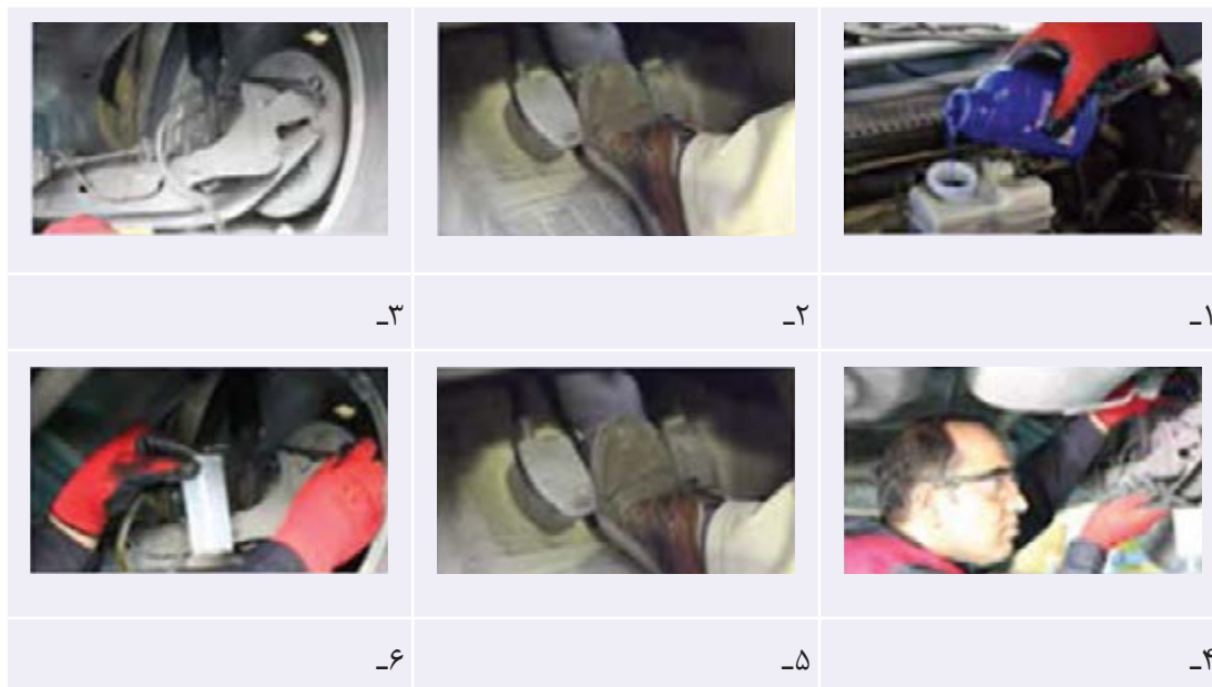
شکل ۱۹- مراحل هواگیری دستی مدار هیدرولیک ترمز
