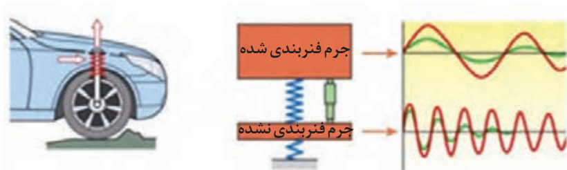
شکل ۲۴- عملکرد سیستم فنربندی تعلیق
