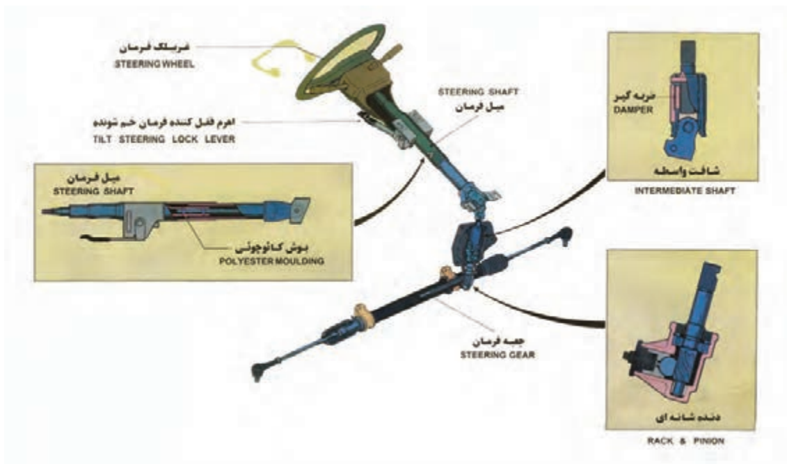
شکل ۲ - مجموعه فرمان و اجزای آن
