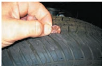
شکل ۱۷- نحوه اندازه‌گیری تقریبی شیار تایر
