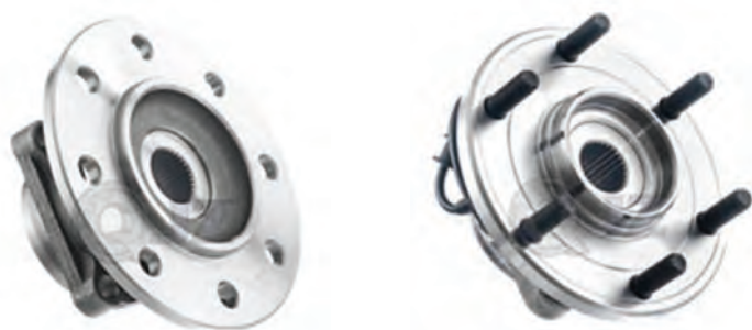
شکل ۲۷- توپی از نظر استفاده از پیچ یا مهره
