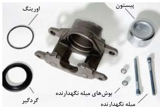
شکل ۳۶- اجزای مجموعه هیدرولیکی کالیپر ترمز
