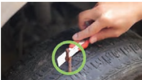
شکل ۲۷- مراحل پنچرگیری تایر بدون تیوب
