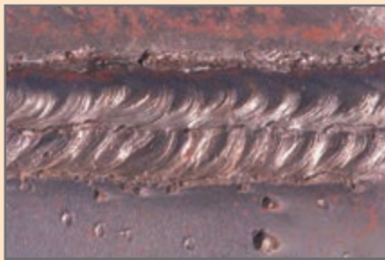
شکل ۴۰-۱- اندازه گرده جوش در پاس پوششی
