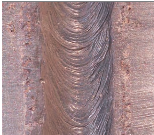
شکل ۲۷-۱- ساق (toe) جوش یکنواخت
