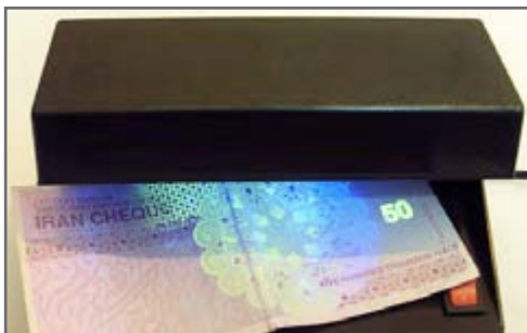
شکل ۱-۴- استفاده از نور ماورای بنفش در تشخیص اسکناس
