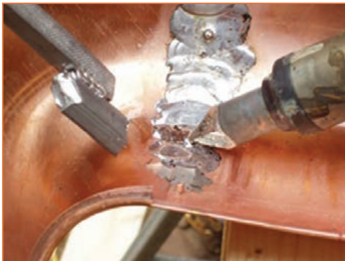
شکل ۲۲ - پرکردن درز اتصال به وسیله مذاب لحیم
