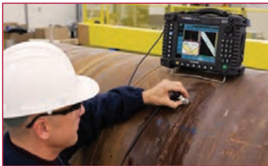
شکل ۶-۱- بازرسی جوش (تست التراسونیک)
