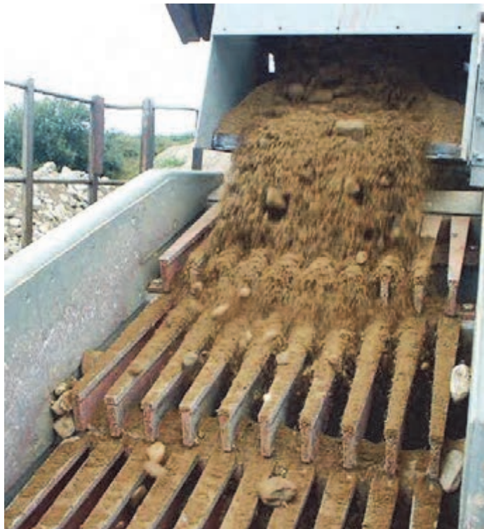
فیدر (تغذیه‌کننده) و سرند گریزلی سنگ‌شکن فکی
