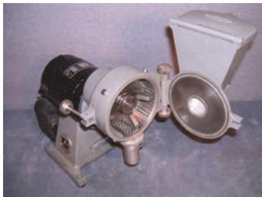
نمایی از سنگ شکن چکشی آزمایشگاهی
