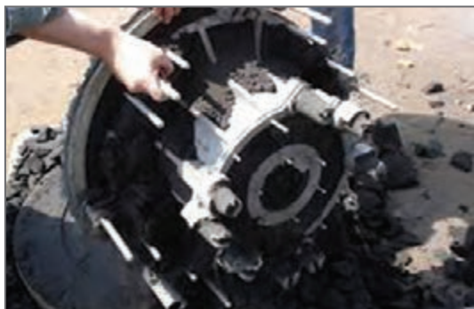
شکل ۱۰- قطعه هوزینگ ریخته شده سالم
