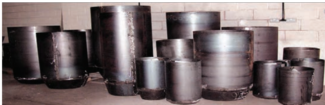
شکل ۱۶- انواع شابلون کوره در ظرفیت های مختلف
