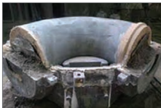
شکل ۱۷- ماهیچه زانویی پوشش داده شده
