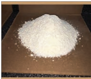
شکل ۴- عایق های ریختنی
