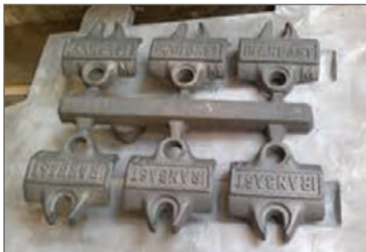
شکل ۷- قطعات ریخته شده با سیستم راهبار و راهبار
