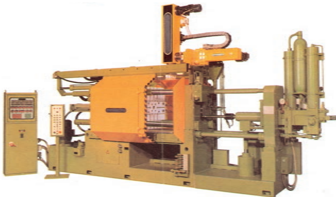
شکل ۸- ماشین ریخته‌گری تحت فشار با محفظه سرد
