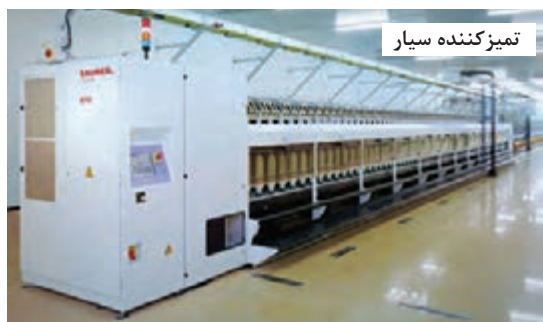
شکل ۵۲- تمیزکننده سیار روی فلایر
