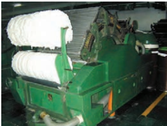
شکل ۴- تغذیه کارد با بالش
