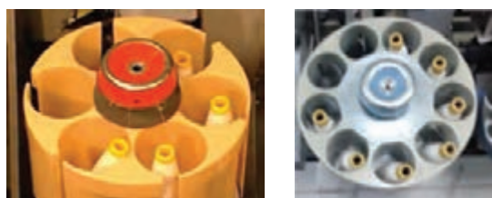
شکل ۴۲- دو نمونه مگازین ۶ و ۱۰ تایی
