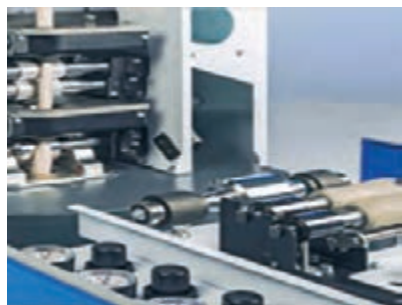
شکل ۱۱- کالندر و اتولولر در چندلاکنی
