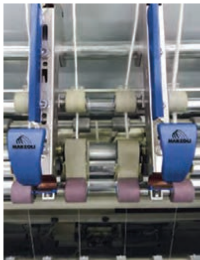
شکل ۹- تصویر واقعی سیستم کششی در رینگ
