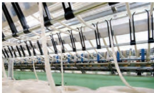
شکل ۲۲- سیستم هدایت فتیله روی قفسه ماشین فلایر
