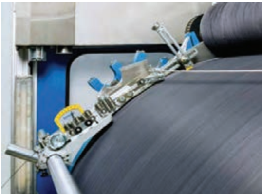
شکل ۲۵- نحوه پیچش نوار خاردار متالیک و ابزار تعیین میزان کشیدگی نوار متالیک
