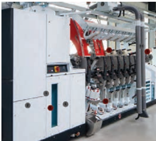
شکل ۵۵- تمیزکننده خودکار اتوکنر
