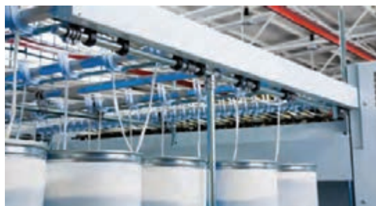
شکل ۲۱- نمای قفسه دستگاه فلایر
