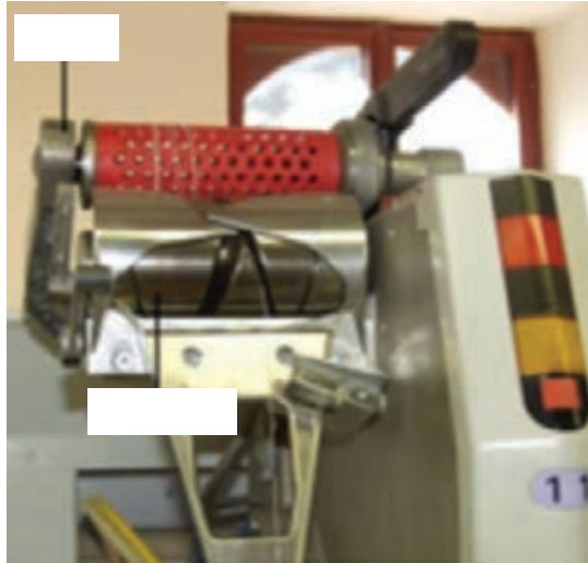
شکل ۵۳- شروع پیچش یک قرقه جدید
