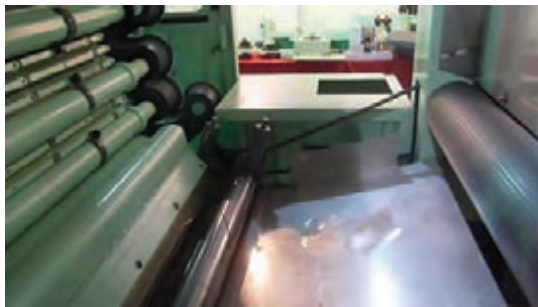
شکل ۱۰- سینی و غلتک تغذیه در سیستم قدیمی
