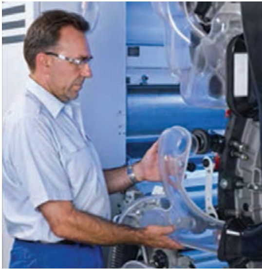
شکل ۵۲- سهولت نصب و خارج کردن کانال‌های هوا و درب‌های آن در کاردهای جدید.
