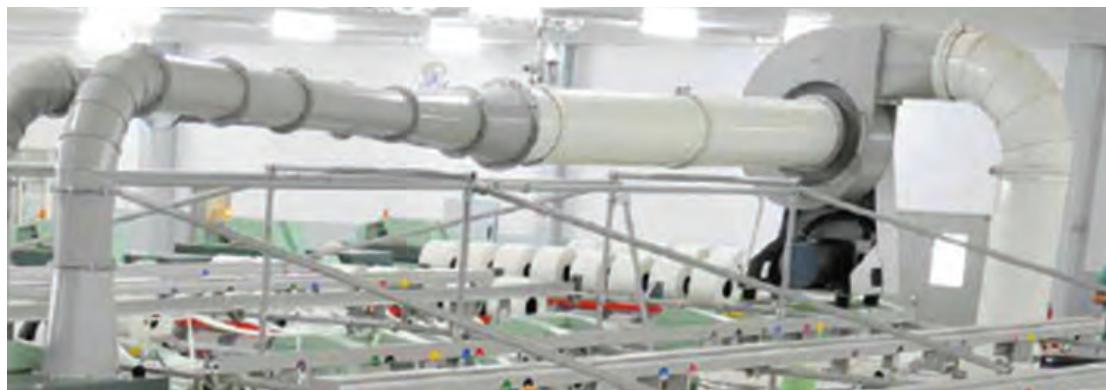
شکل ۲۴- تقویت فشار انتقال الیاف
