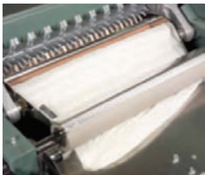
شکل ۳۸- جمع کردن الیاف شانه شده و تبدیل آن به فتیله
