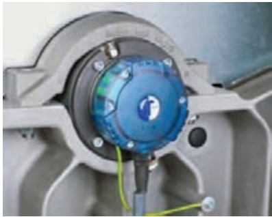
شکل ۱۷- سنسور تشخیص ناخالصی و تنظیمات
