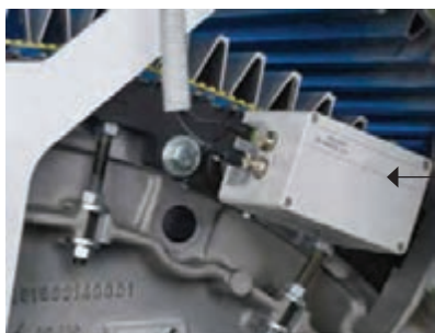
شکل ۳۵- موتور تنظیم فاصله کلاهدک و سیلندر (PFS-M)
