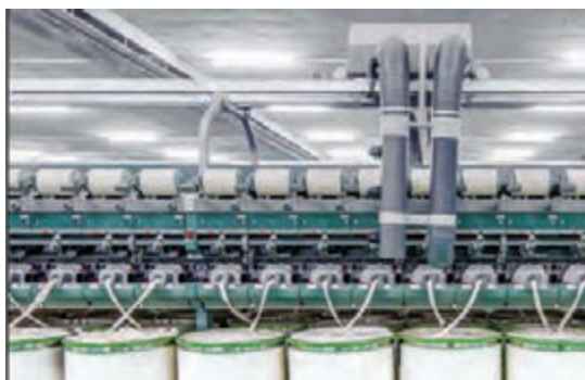
شکل ۱۶- تمیزکننده سیار روی ماشین چرخانه
