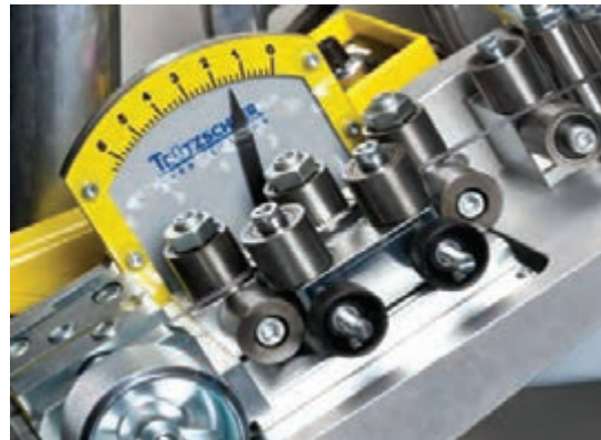
شکل ۲۵- نحوه پیچش نوار خاردار متالیک و ابزار تعیین میزان کشیدگی نوار متالیک
