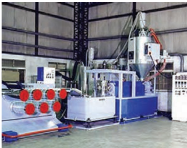
شکل ۱- دستگاه تولید الیاف پلی‌استر
