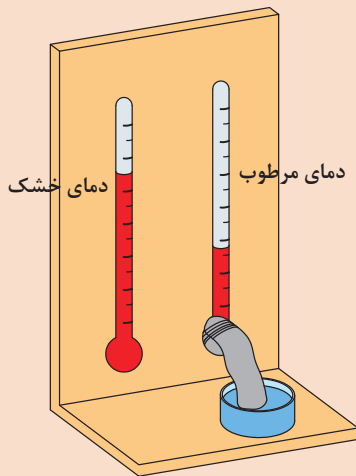
شکل ۱۱- آزمایش تعیین رطوبت نسبی هوا
