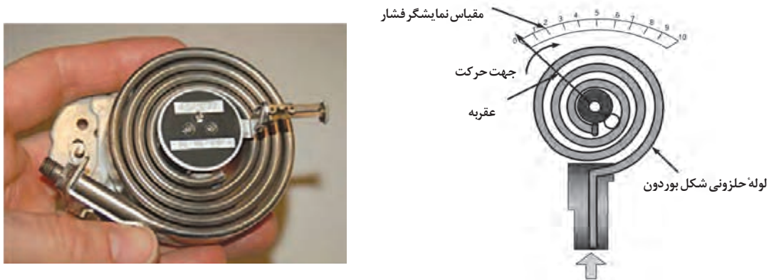
شکل ۲۲- لوله بوردون از نوع حلزونی
