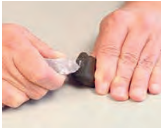
شکل ۱۹- روش‌های دستی و دستگاهی تعیین سختی
