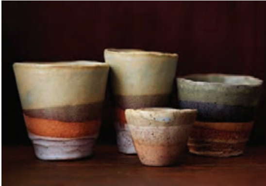
شکل ۵۷- رنگی شدن بدنه به علت وجود بنتونیت
