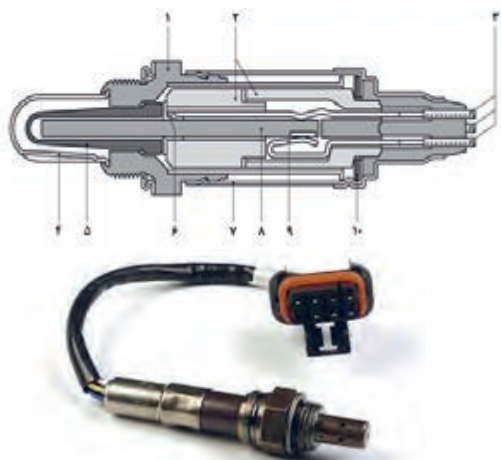
شکل ۵- اجزای حسگر اکسیژن
