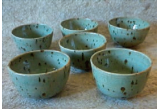
شکل ۵۶- اثر افزودن ۴ درصد بنتونیت در ترکیب لعاب
