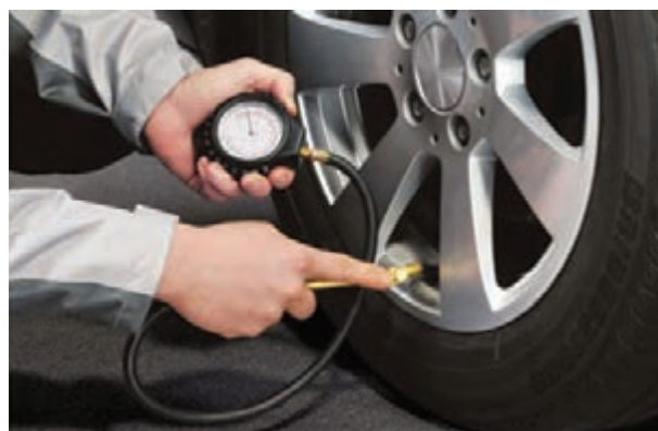
شکل ۱۰- اندازه‌گیری و تنظیم فشار باد تایر
