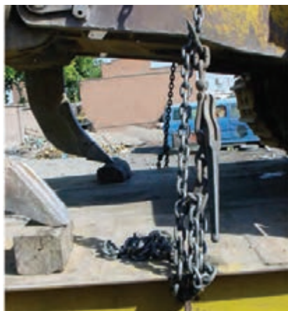
شکل ۲۷- بستن قسمت‌های مفصلی ماشین‌آلات راه‌سازی
