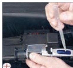
شکل ۱۰- اندازه‌گیری الکترولیت باتری
