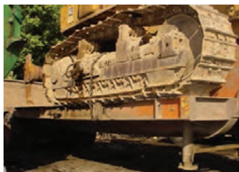
شکل ۳۰- بستن بلدوزر با یک زنجیر آن هم با عبور از چرخ شنی
