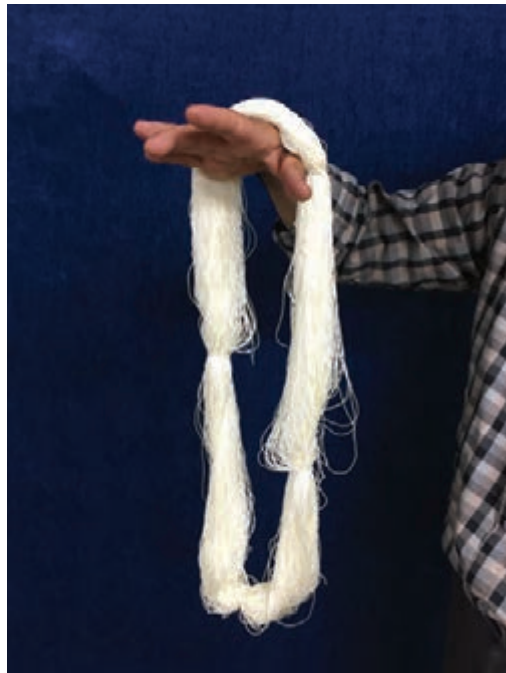
شکل ۲۲-۲- برداشتن کلاف و باز کردن تاب کلی
