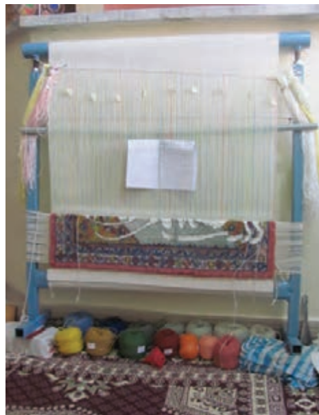
شکل ۱۰-۱- زیردار ثابت و سردار متحرک (مدل ۲)
