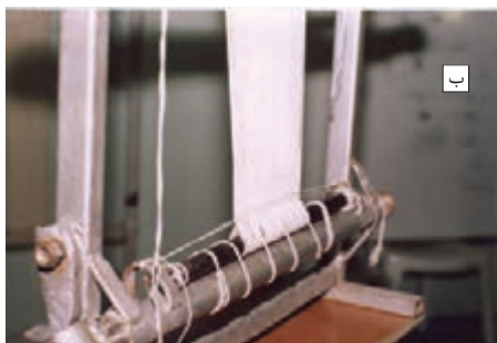
شکل ۱۱-۳- دوخت به روش میله کمکی
