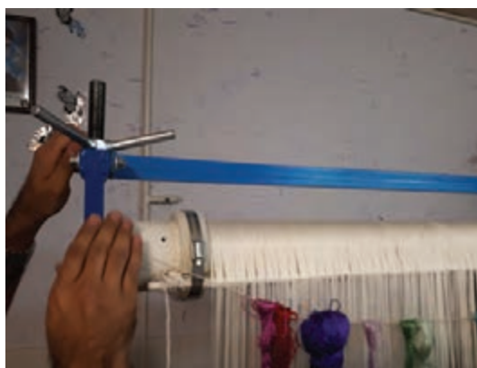
شکل ۳۵- ۵- شل کردن دار
