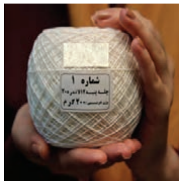
شکل ۱۶-۲- توپک ۲۰۰ گرمی، چله پنبه ای ۱۲ لا نمره ۲۰
