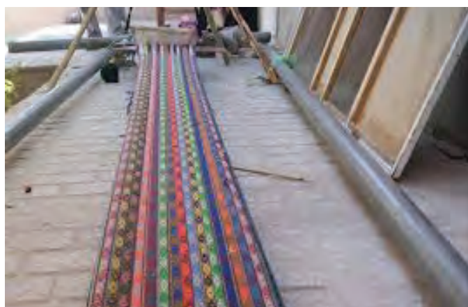
شکل ۲۰-۳- چله کشی بر روی دار در حالت افقی برای بافت جاجیم
