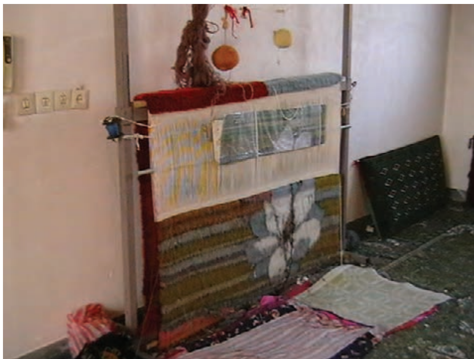
شکل ۸-۵- قالی پایین‌کشی شده به روش گردشی یا چرخان
