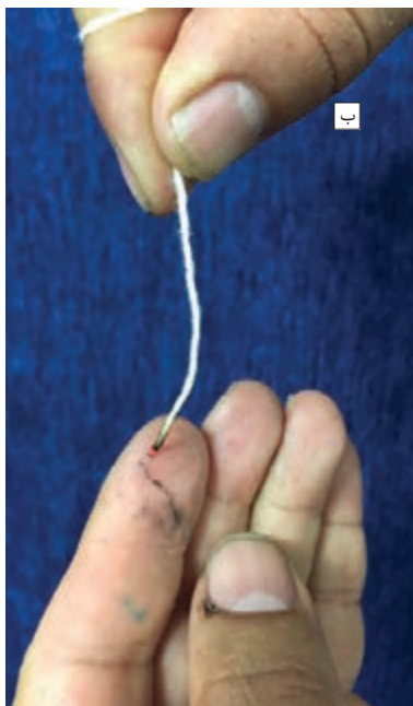
شکل ۱۱-۲- نخ چله پنبه‌ای در حالت سوزاندن
