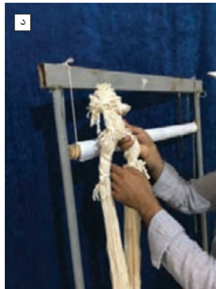
شکل ۳-۳- انتقال چله بردار
