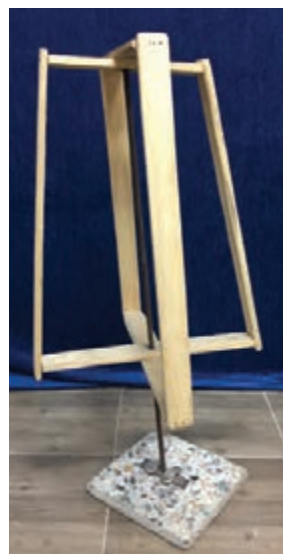
شکل ۲-۲- دستگاه کلاف باز کن
