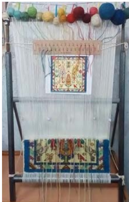
شکل ۹-۱- زیردار ثابت و سردار متحرک (مدل ۱)
