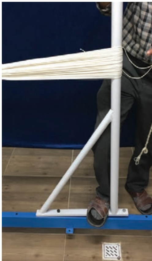
شکل ۳۸-۲- بستن انتهای چله به میله
