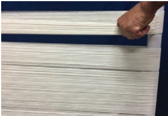
شکل ۳۰-۲- تنظیم تارها بر روی میله
