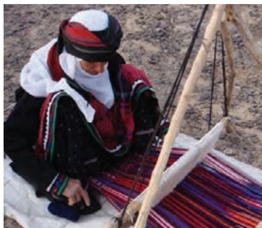
شکل ۱۹-۳- چله‌ریزی بر روی دستگاه برای بافت جاجیم
