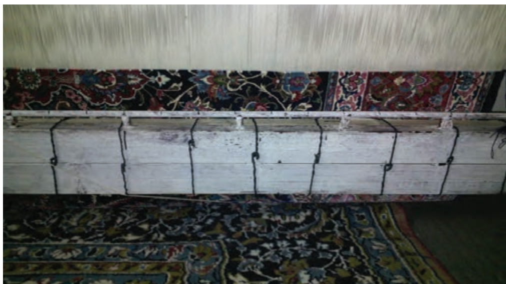
شکل ۳۲-۵ - قالی آماده برای بافت بعد از پایین کشی به روش میخ و تخته
