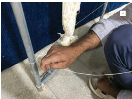
شکل ۷-۳- بازکردن نخ‌های کمکی
