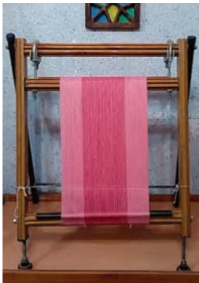
شکل ۱-۴- دار قالی بافی عمودی
