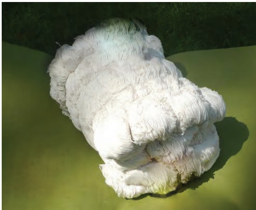
شکل ۱-۲. یک بقیچه (حدود ۴ کیلو ۴۰۰ گرم) نخ چله پنبه ای دوازده لا، نمره ۲۰
