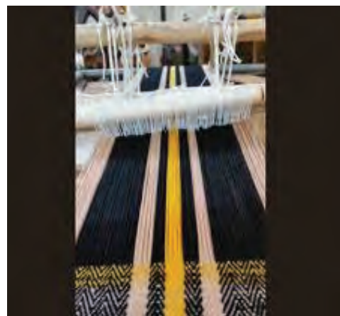
شکل ۱۹-۳- چله‌ریزی بر روی دستگاه برای بافت جاجیم
