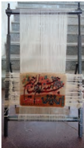
شکل ۱۵-۴- پیچیدن پودها به دور راست روها
