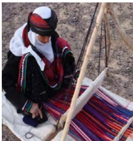
شکل ۲۳-۱ دستگاه چوبی بافت جاجیم
