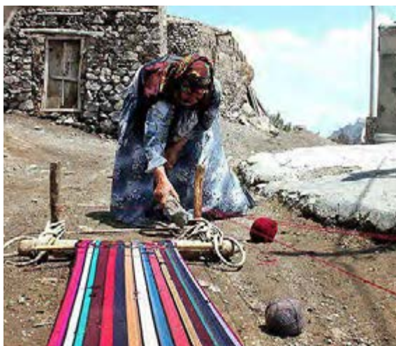
شکل ۳۶-۱ دستگاه چوبی جاجیم بافی (افقی)
