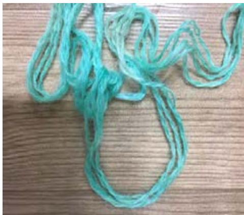
رنگرزی نامرغوب نخ
