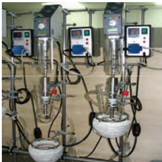
شکل ۱۲- تجهیزات رنگ‌بری تحت خلأ آزمایشگاهی
