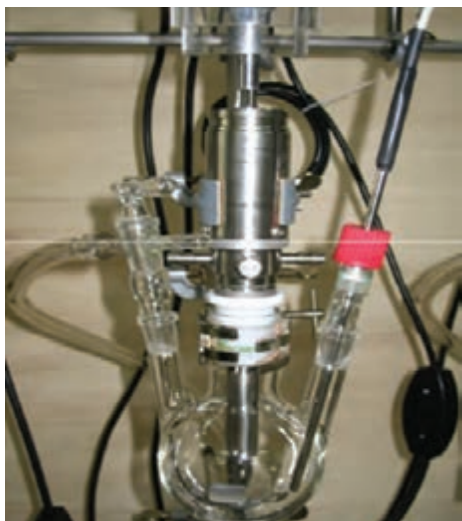
شکل ۱۲- تجهیزات رنگ‌بری تحت خلأ آزمایشگاهی
