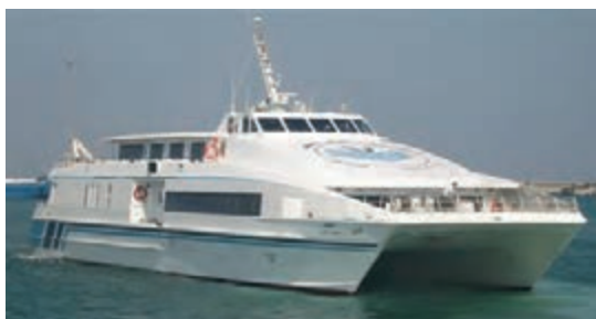
شکل ۱۵- یک شناور کاتاماران با بدنه آلومینیومی
