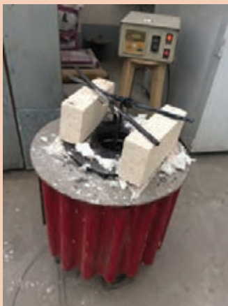
شکل ۲۵- وارد کردن نمونه‌ها در حمام نمک
