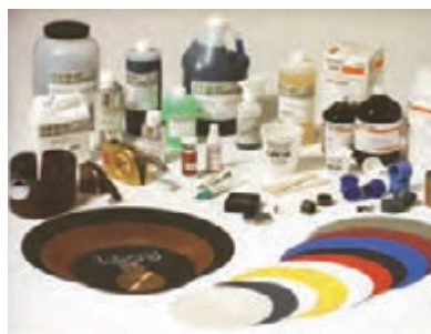
شکل ۱۴- انواع کاغذهای سنبناده و مواد مانت سرد و گرم مورد استفاده در متالوگرافی
