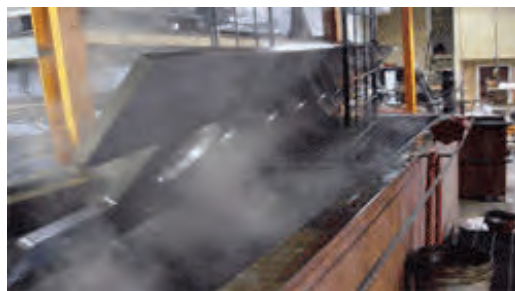
شکل ۲۰- عملیات سیاه کاری
