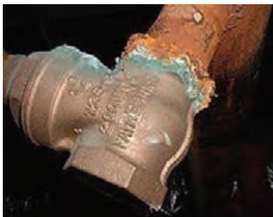
شکل ۶- خوردگی گالوانیکی در اثر اتصال دو فلز متفاوت کنار هم
