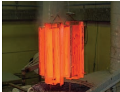
شکل ۳۰- کربوره کردن مایع در حمام نمک
