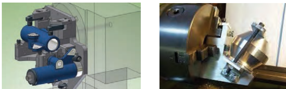
شکل ۳۵- فیکسچرهای تراش کاری
