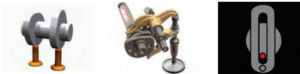
شکل ۲۸- نمونه‌هایی از مکانیزم‌های لنگی و بادامکی
