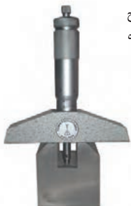
شکل ۵- اندازه گیری با میکرومتر عمق سنج
