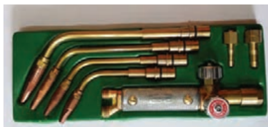
شکل ۲۰- مشعل و سر یک‌های قابل تعویض جوشکاری
