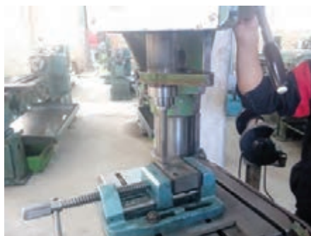
شکل ۱۳- نصب برقوروی محور دستگاه مته
