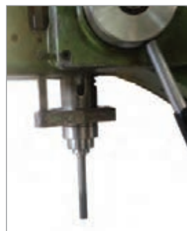
شکل ۱۳- نصب برقوروی محور دستگاه مته
