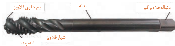
شکل ۲- ساختمان قلاویز ماشینی
