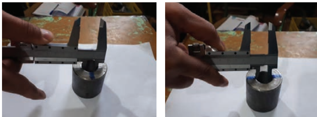
شکل ۱۵- کنترل دایره ای بودن سوراخ
