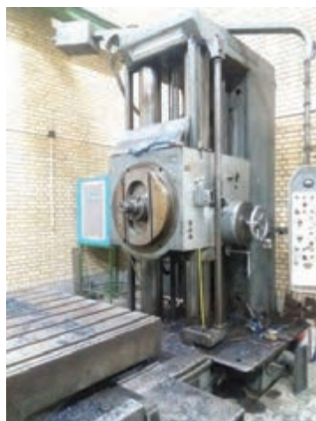
شکل ۶- دستگاه جیک بورینگ
