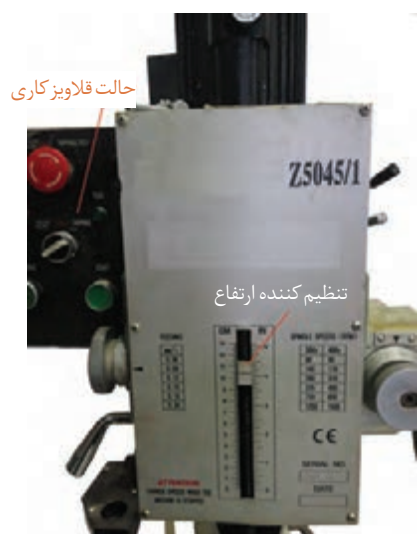
شکل ۴- کلگی قلاویز ماشینی با قابلیت تنظیم ارتفاع
