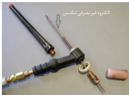
شکل ۶- الکترود غیر مصرفی
