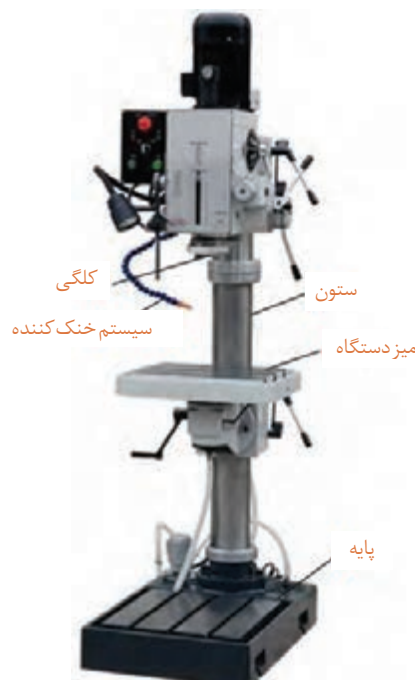
شکل ۳- دستگاه مته ستونی
