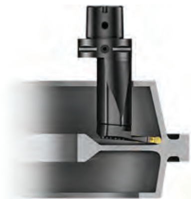
شکل ۵- ایجاد شیار در داخل سوراخ
