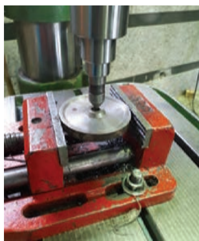
شکل ۹- استفاده از مرغک در ایجاد هم‌مرکزی صحیح
