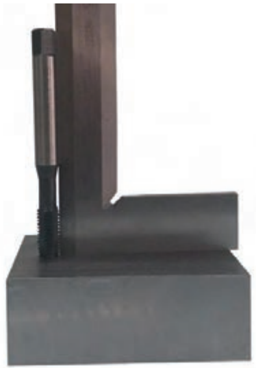
شکل ۷- کنترل عمود بودن قلاویز با سوراخ
