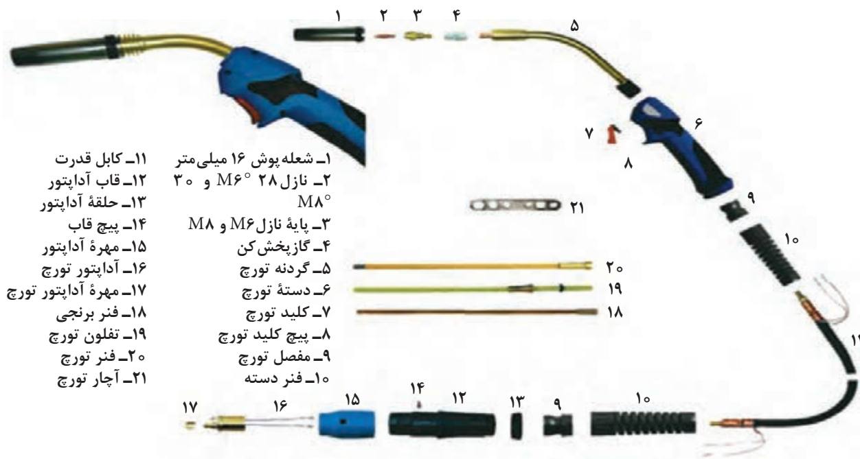
شکل ۷- اجزای تشکیل دهنده تورچ GMAW
