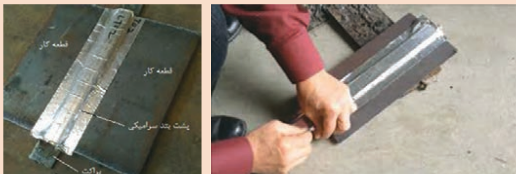
شکل ۱۸- نصب پشت بند سرامیکی
