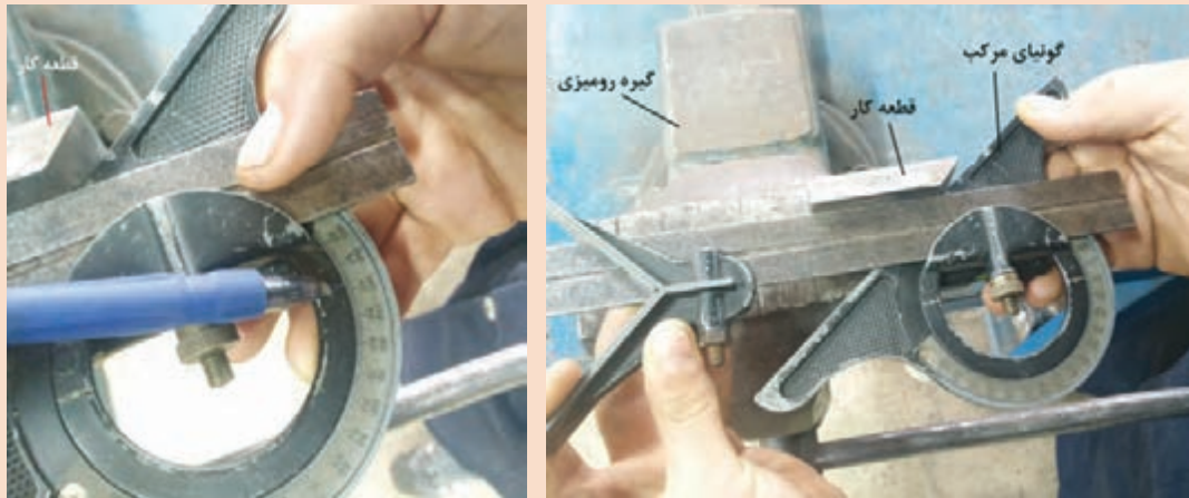
شکل ۲۰- بررسی صحت زاویه با گونیای مرکب
