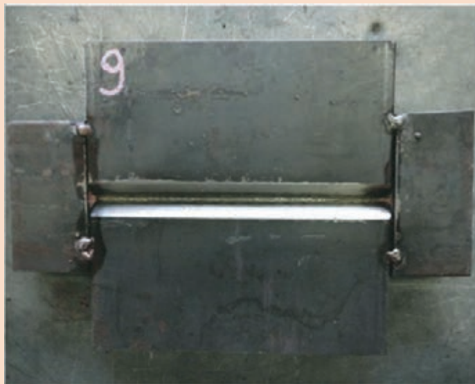
شکل ۲۱- موقعیت دهی و مونتاژ قطعه کار
