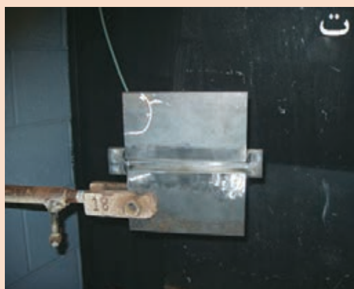
شکل ۱۷- موقعیت دهی و مونتاژ قطعه کار
