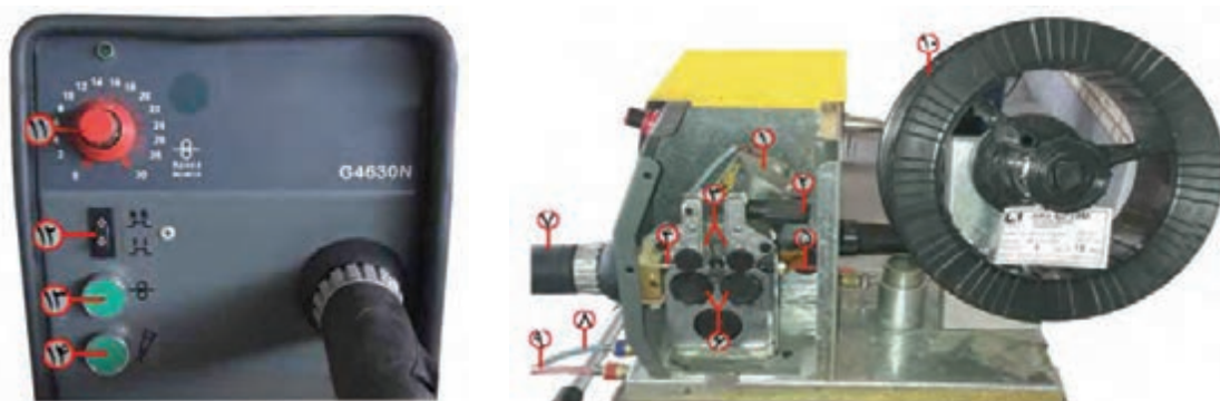
شکل ۱۵- اجزای منبع تغذیه سیم جوش
