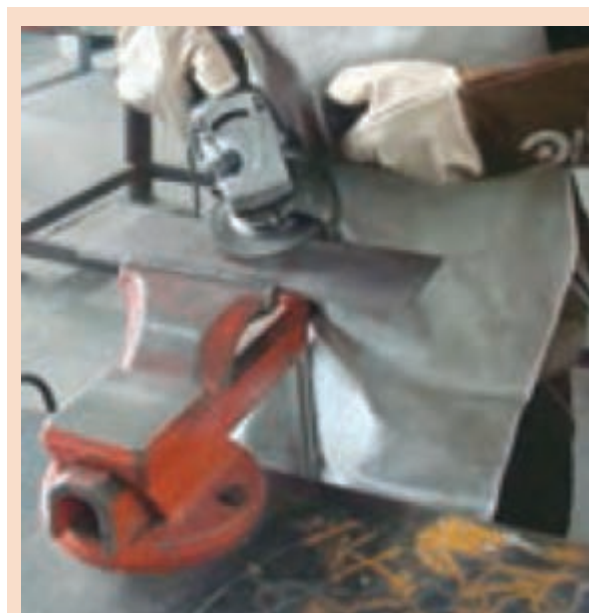
شکل ۱۲- سنگ زدن پشت ورق (ریشه جوش)
