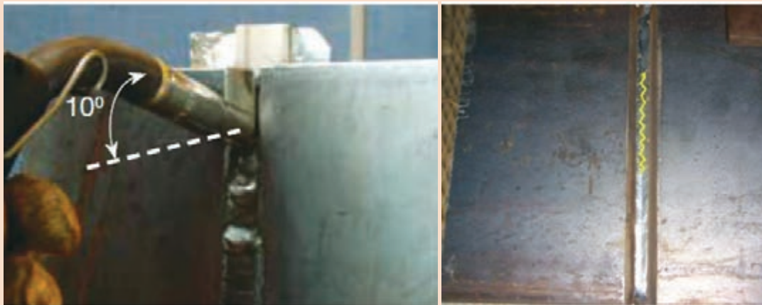
شکل ۲۴- زاویه تورچ و جهت حرکت آن
