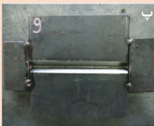
شکل ۱۷- موقعیت دهی و مونتاژ قطعه کار
