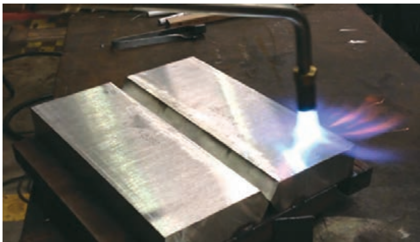
شکل ۵- پیش گرم کردن قطعه ضخیم توسط شعله
