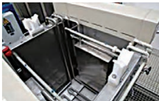
پ) نمونه های صنعتی مخزن آبکاری
