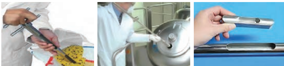
شکل ۸- نمونه‌گیرهای مخروطی
