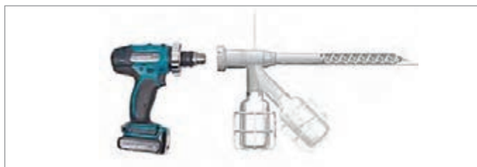
شکل ۹- نمونه گیرهای پیچی
