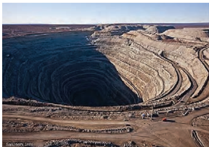
شکل ۲۳- چاله‌های پلکانی در یک معدن روباز
