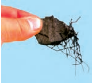
شکل ۱-۱- آهن‌ربای طبیعی براده‌های آهن را جذب می‌کند.
