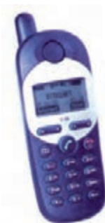
شکل ۴-۳- تلفن بی‌سیم در داخل اتاق صدابرداری یک مولد نویز محسوب می‌شود.
