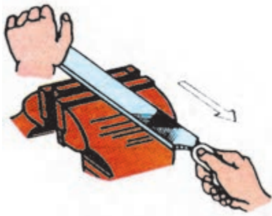
شکل ۲۵-۳- حرکت به عقب بدون فشار
