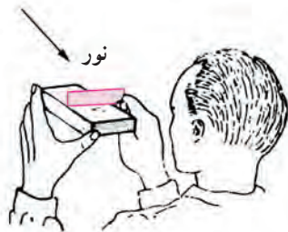
شکل ۱-۲۳- کنترل زاویه قائمه با گونیا
