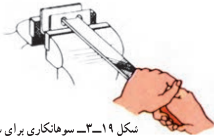
شکل ۳-۱۸ - کارهای کوچک و براده برداری مختصر
