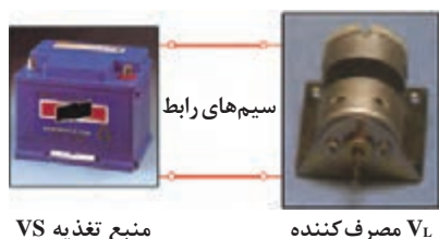
شکل ۵-۹۶- افت ولتاژ بین مولد و مصرف‌کننده
