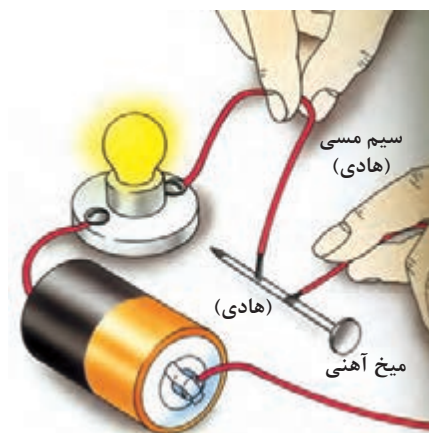
شکل ۲-۳- برقراری جریان الكتريكي در هادی‌ها
