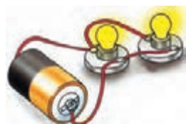
شکل ۵-۶۳- اتصال دو لامپ به صورت موازی
