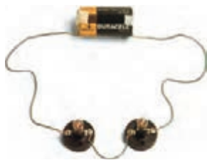
شکل ۵-۳- مدار واقعی دو لامپ به صورت سری
