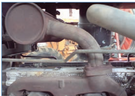
شکل ۳۰-۵- محل اتصال منبع اگزوز به مانیفولد
