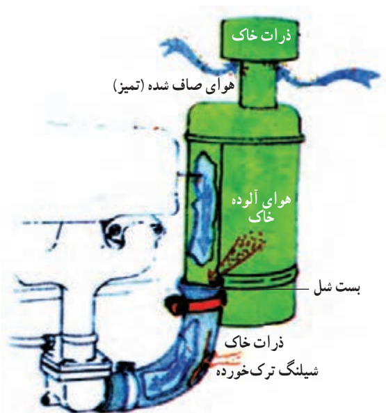
شکل ۱۹-۵- محل بریدگی و سوراخ شدگی در شیلنگ‌ها
