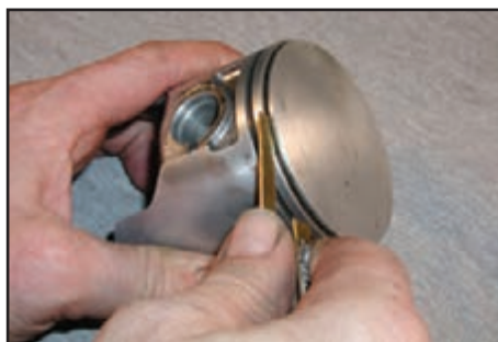
(د) تمیز کردن شیار با ابزار برنجی
