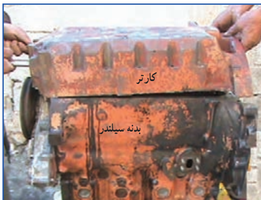
ب) برداشتن کارتر
