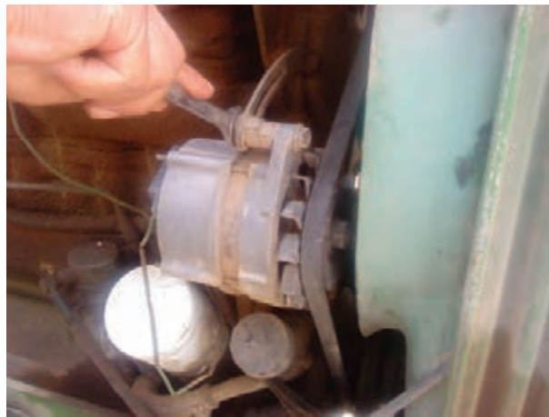
شکل ۳۸-۶ سفت کردن پیچ تنظیم آلترناتور
