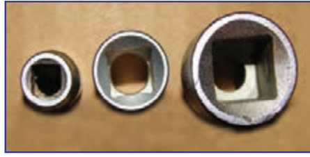
شکل ۳۹-۳- انواع شکاف چهار گوش (درایو بکس) آچار بکس
