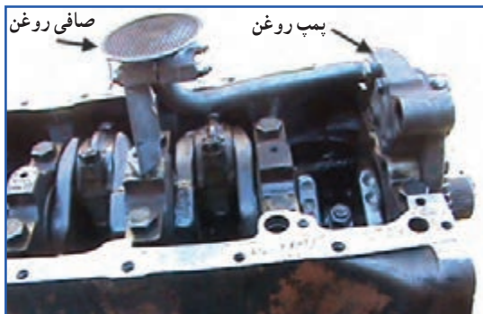
الف) محفظه میل‌لنگ بدون کارتر
