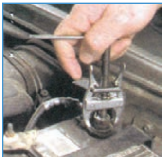
شکل ۶-۷ جدا کردن بست منفی باتری
