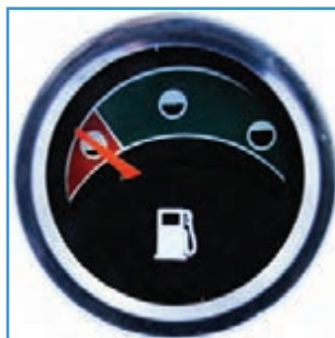
شکل ۹-۲- درجه نشان‌دهنده مقدار سوخت در مخزن سوخت
