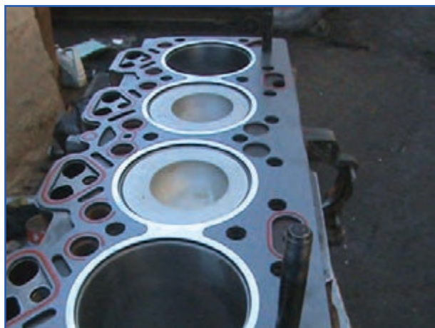
شکل ۵۲-۴- قرار دادن واشر سرسیلندر روی بدنه سیلندر
