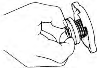
شکل ۱۷-۳- آزمون سوپاپ مکش در رادیاتور
