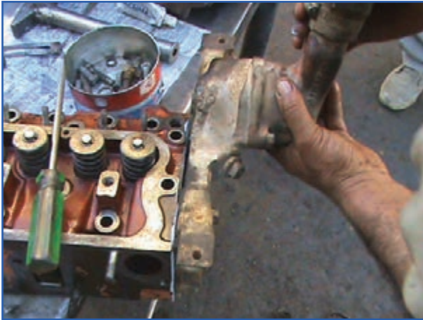
ب) باز کردن محافظه ترموستات تراکتور MF399
