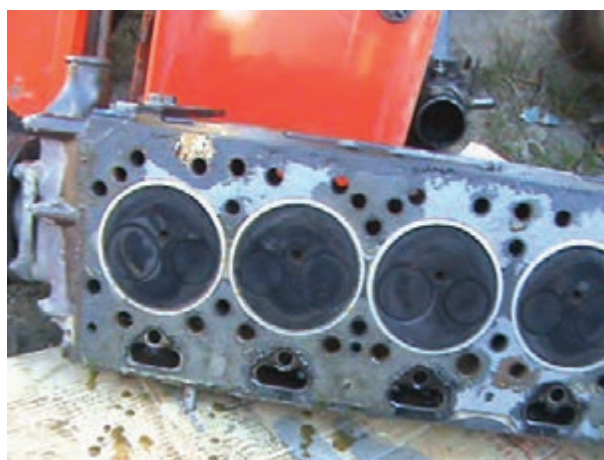
شکل ۱۵-۴- طرز قرار دادن سرسیلندر روی سطح صاف
