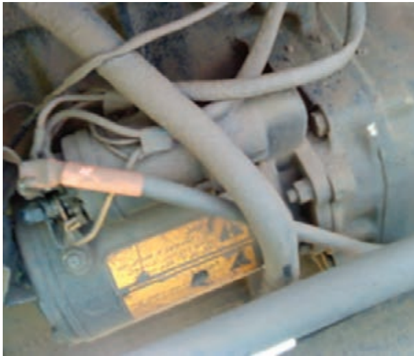
شکل ۶-۴۳- اتصال سیم‌ها از دینام به آفتمات
