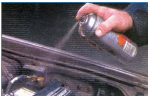
شکل ۱۱-۶- پاشیدن اسپری ضد خوردگی روی بست باتری
