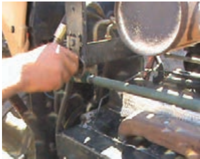
ج) باز کردن شاسی نگهدارنده رادیاتور
