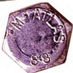
شکل ۱۵-۳ اعداد حک شده روی سر پیچ
