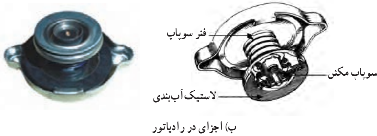
شکل ۳-۵- در رادیاتور و طرز کار سوآپ‌های آن
