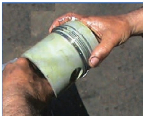
شکل ۱۴۱-۴- تنظیم جهت قرار گرفتن دهانه رینگ‌ها روی پیستون
