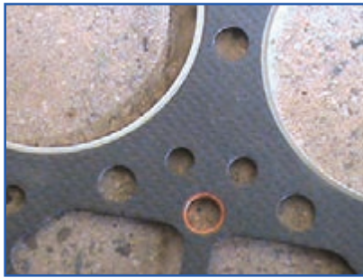
ب) سمت باریک نوار فلزی واشر سرسیلندر
