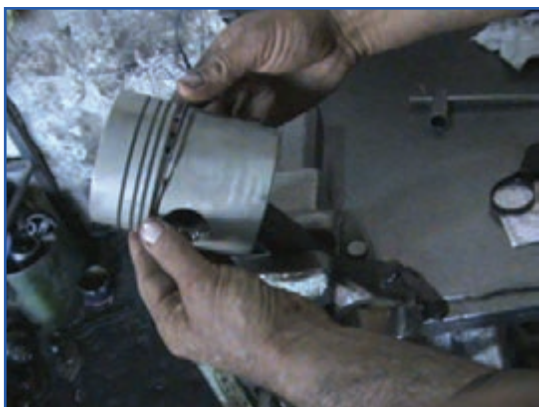
شکل ۱۳۸-۴- جا زدن رینگ با دست
