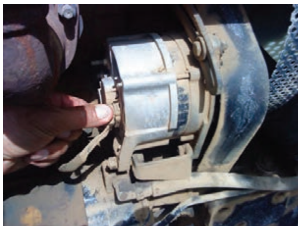
شکل ۲۸-۶- جدا کردن فیش از آلترناتور
