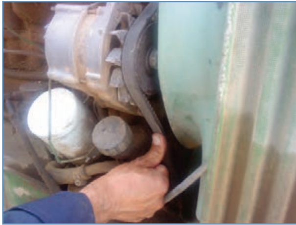
شکل ۲۸-۳- اندازه‌گیری کشش تسمه با فشار انگشت
