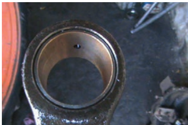
شکل ۱۲۰-۴ قرار گرفتن سوراخ بوش مقابل سوراخ شاتون
