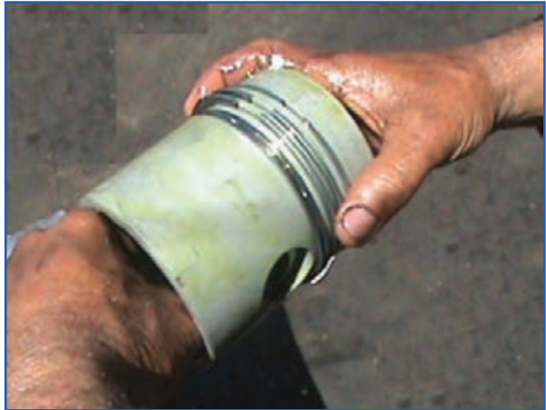
شکل ۱۹۶-۴- تنظیم کردن دهانه رینگها
