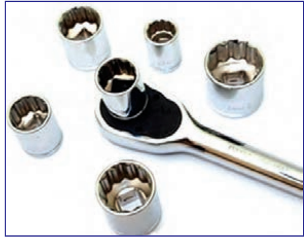
شکل ۴۸-۳- اتصال بکس به دسته بکس جفجغه ای
