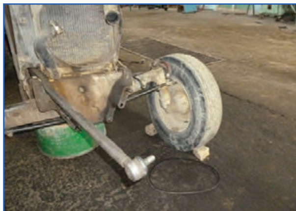
شکل ۱۹-۳- قسمت جلوی تراکتور جدا شده از موتور
