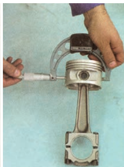
(الف) اندازه‌گیری قطر دامن پیستون
