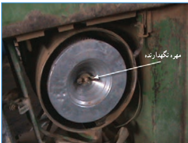
شکل ۱۰-۵ باز کردن شبکه بغل
