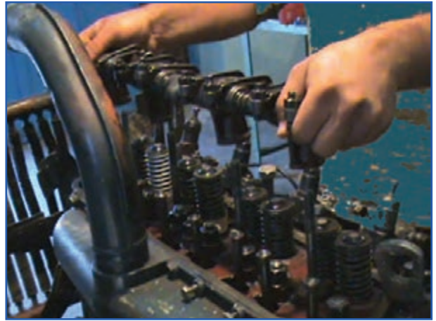
شکل ۹-۴- برداشتن محور اسبک و اسبک‌ها تراکتور U650
