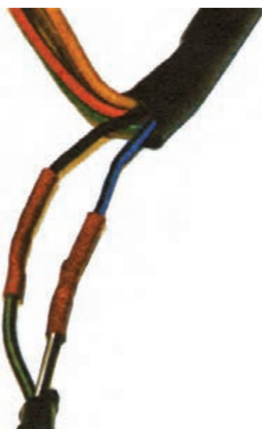
شکل ۶۷-۶- اتصال کامل سیم‌ها با روکش تیوب عایق
