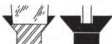
شکل ۷۱-۳- طرز قرار گرفتن لبه پیچ گوشتی در شیار پیچ
