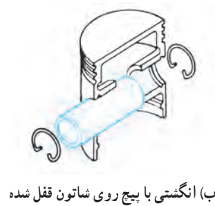
شکل ۳۱-۲- انواع اتصال انگشتی به پیستون
