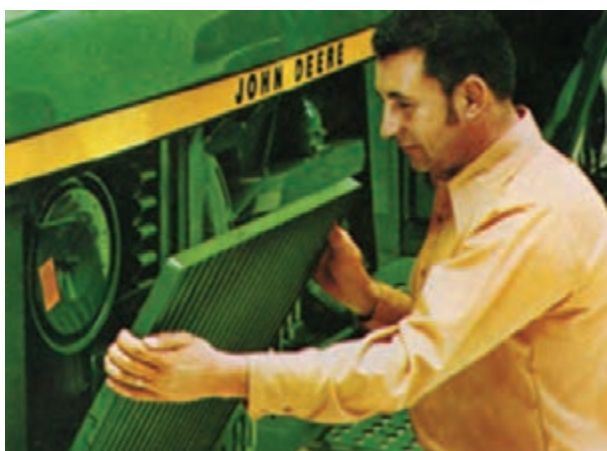
شکل ۱۰-۵ باز کردن شبکه بغل
