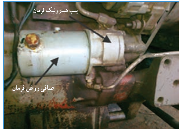
شکل ۲۳-۲- پمپ هیدرولیک فرمان و صافی تراکتور MF285
