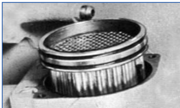
شکل ۳۵-۷- محل قرار گرفتن کویل روغن
