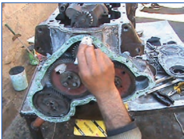
شکل ۴۴-۷- چسب زدن به محل نصب سینی جلو
