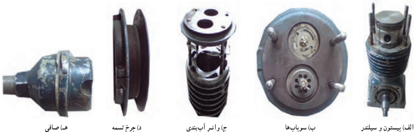
شکل ۳-۸- اجزای کمپرسور باد
