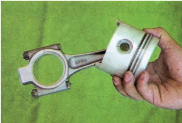
شکل ۱۲۶-۴- طرز آزمایش لقی شاتون روی انگشتی
