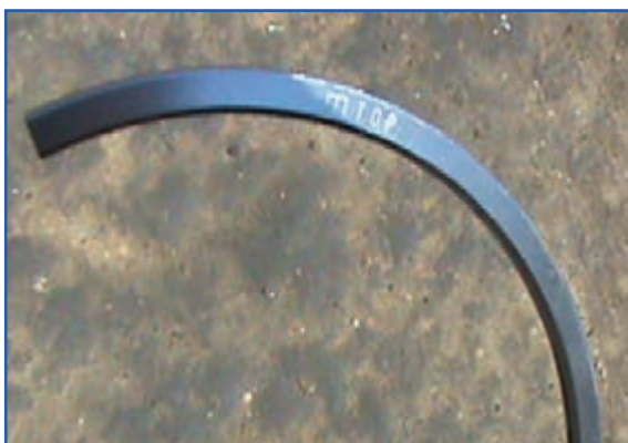
شکل ۱۳۴-۴- علامت TOP روی رینگ
