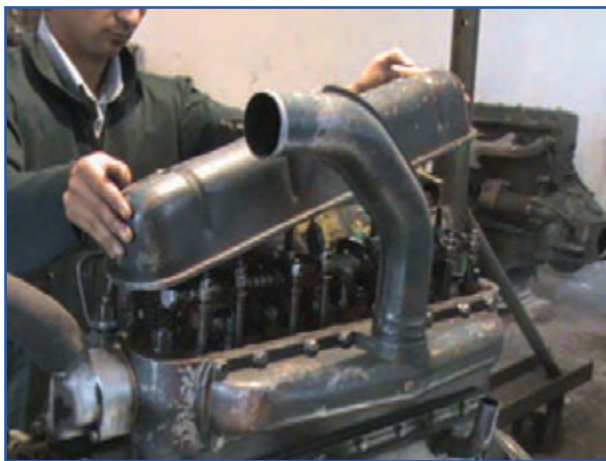
شکل ۴۰-۷. برداشتن قالباق سوپاپ
