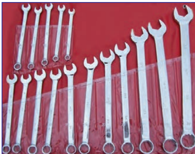
شکل ۳۳-۳- یک سری آچار یک سر رینگی
