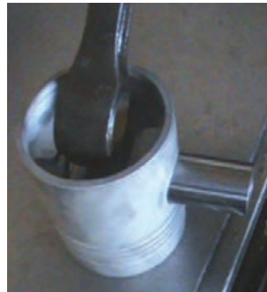
شکل ۱۲۲-۴ اتصال شاتون به پیستون و جازدن انگشتی
