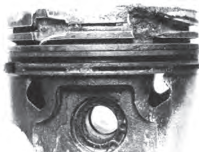
شکل ۴-۱۰۰- تخریب شدید جای رینگ
