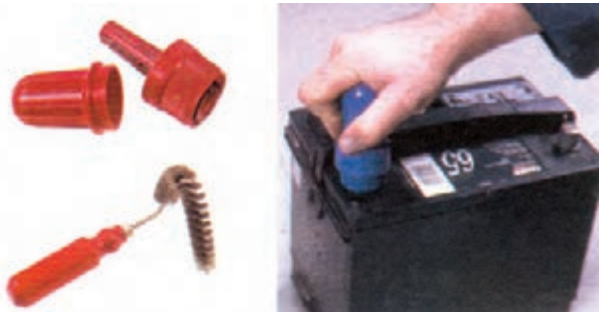
شکل ۲۳-۶- تمیز کردن قطب‌های باتری با ابزار مخصوص
