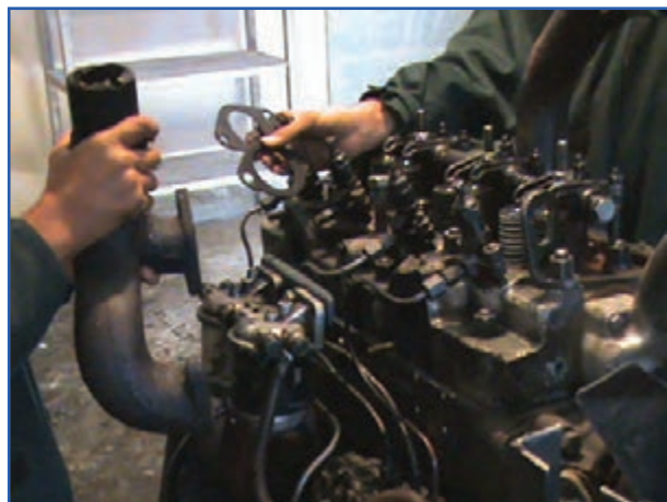
شکل ۴-۴- باز کردن مانیفولد هوا
