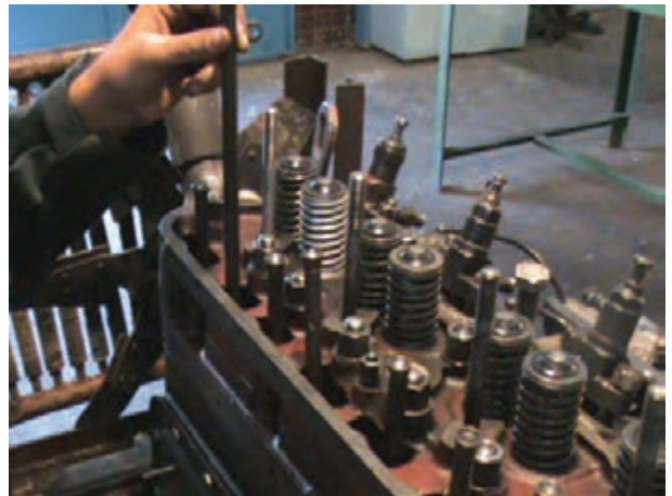
الف) برداشتن میل تایپت
