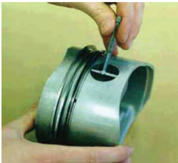
شکل ۱۱۷-۴- اندازه‌گیری سوراخ انگشتی روی پیستون
