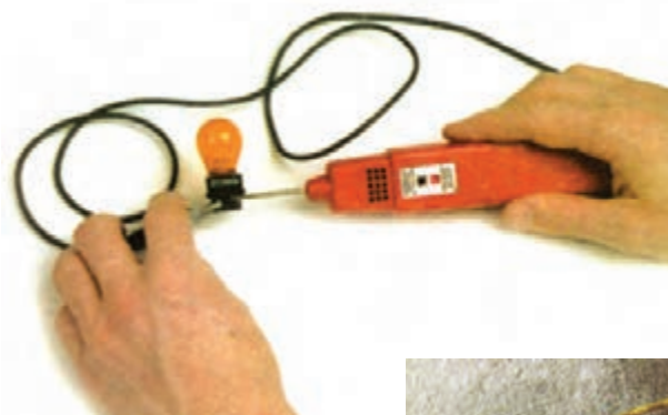
الف) لامپ آزمایش باتری دار
