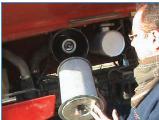
شکل ۱۲-۵ باز کردن مهره نگهدارنده و خارج کردن صافی
