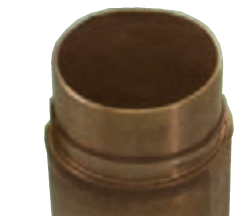
ج) شیار اورینگ روی بوش تر
