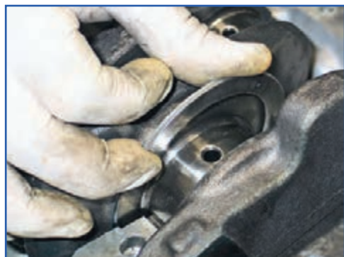
شکل ۱۸۴-۴- جازدن بغل یاتاقانی
