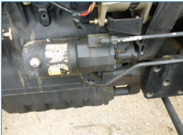
شکل ۲۳-۲- پمپ هیدرولیک فرمان و صافی تراکتور MF285
