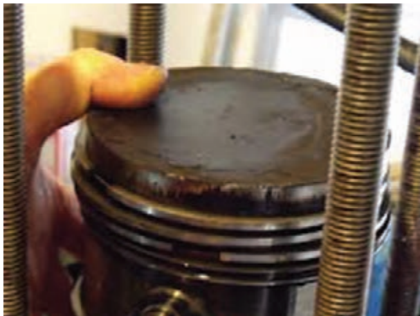
شکل ۲۰۷-۴- رسوبات کربن روی سطح پیستون
