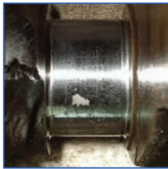
ب) پوسته کردن لایه سخت لنگ
