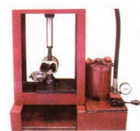
شکل ۱۰۸-۴- خارج کردن انگشتی با پرس هیدرولیک
