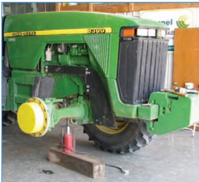
شکل ۱۱-۴- قرار دادن جک روغنی زیر جسم سنگین
