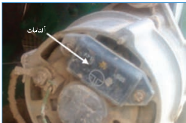
الف) آفتامات روی آلترناتور تراکتور JD3140
