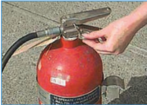
شکل ۱۱-۱- نحوه خارج کردن ضامن کپسول
