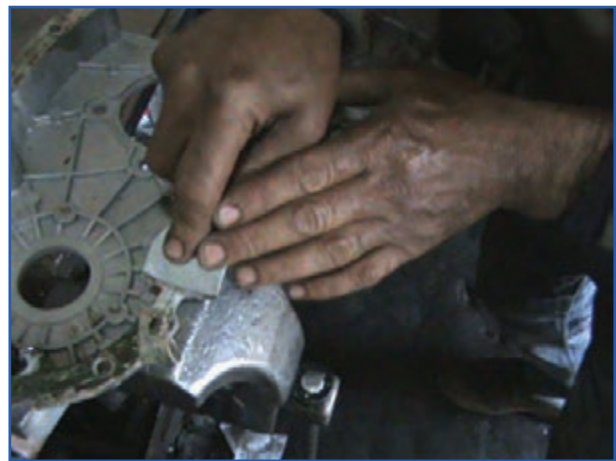
شکل ۴۱-۷- تمیز کردن واشر سینی جلو با کاردک
