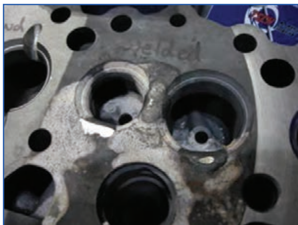
شکل ۲۶-۴- ترمیم ترک سرسیلندر با جوشکاری
