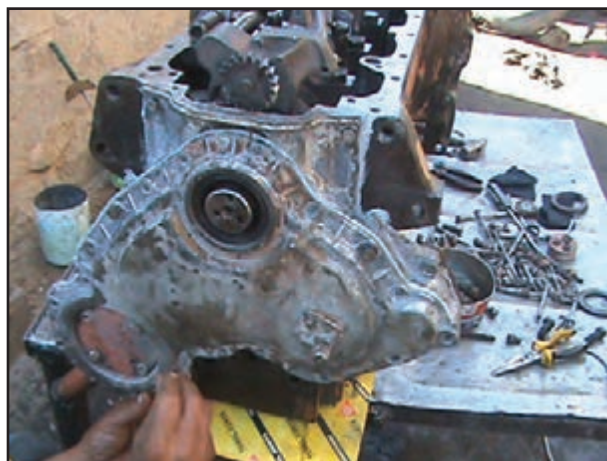
شکل ۵۹-۴- باز کردن پیچ و مهره‌های اطراف سینی جلو
