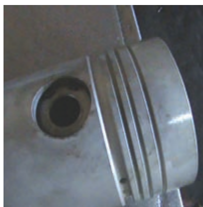
شکل ۱۲۳-۴ میزان داخل شدن انگشتی در پیستون
