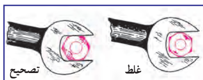
شکل ۲۹-۳ طرز درگیر کردن آچار تخت با مهره
