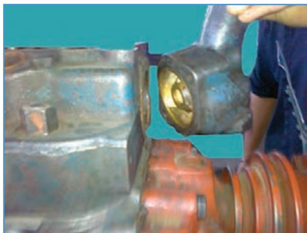
شکل ۲۱-۳- باز برداشتن درپوش ترموستات بعد از باز کردن پیچ‌های آن در تراکتور U650M
