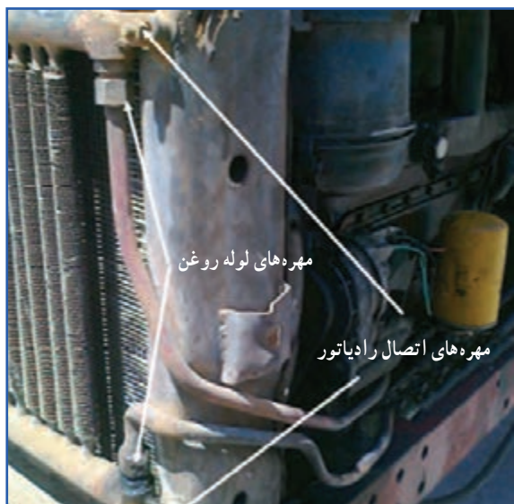
شکل ۳۸-۷- مهره های لوله روغن سمت رادیاتور روغن
