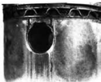
شکل ۱۱۹-۴- خراب شدن جای خار انگشتی
