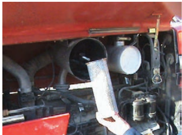
(الف) خارج کردن صافی ثانویه
