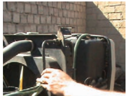
د) باز کردن لوله خنک کن روغن
