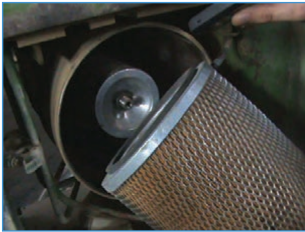
شکل ۵-۵ - صافی خشک و محل قرار گرفتن آن
