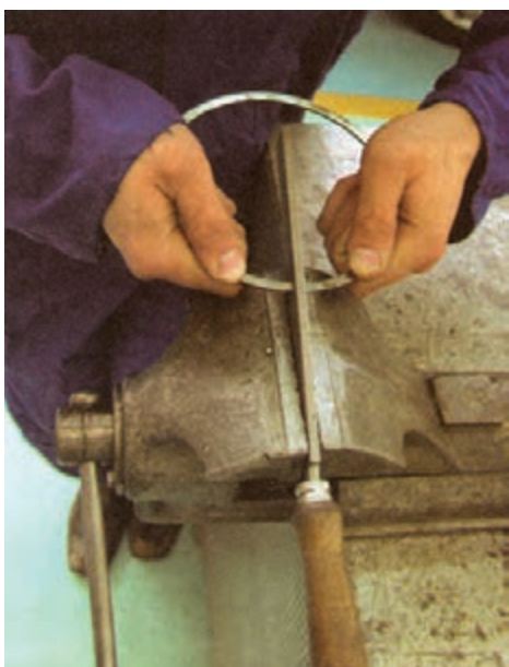
شکل ۱۳۰-۴- ساییدن دهانه رینگ با سوهان
