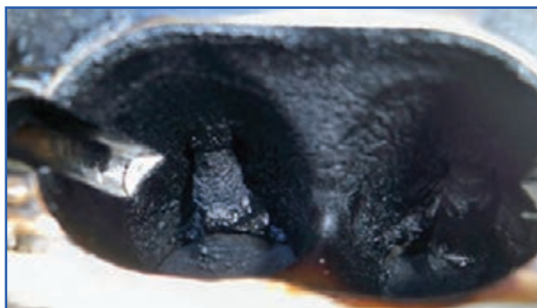
الف) کربن محفظه پشت سوپاپ‌ها
