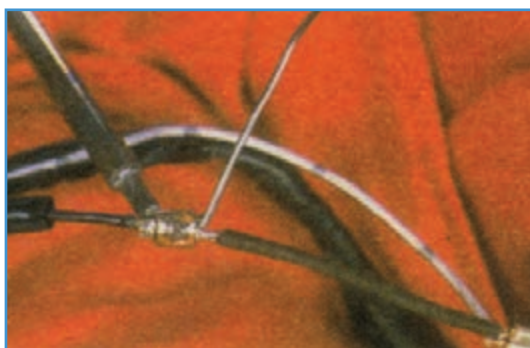
شکل ۶۴-۶- نحوه لحیم کاری سیم‌ها
