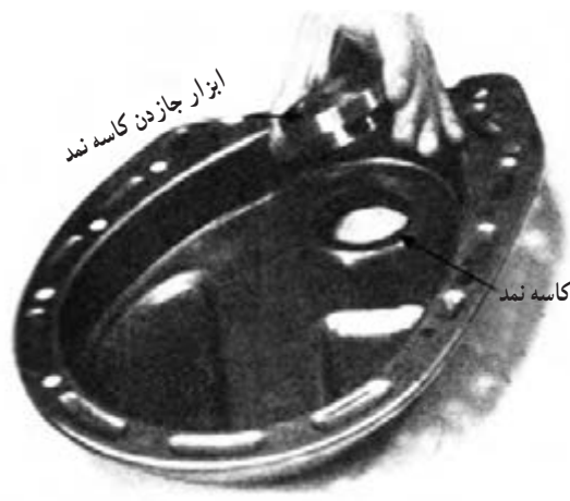
شکل ۴۳-۷- نحوه جازدن کاسه نمد روی سینی جلو
