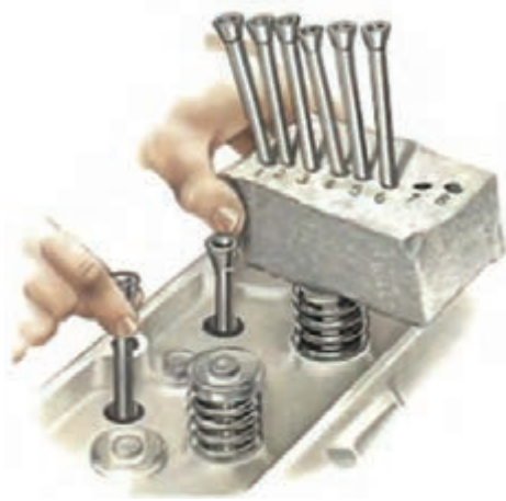
ب) به ترتیب قرار دادن میل تایپت
