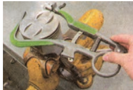
(ب) کاربرد ابزار تمیزکننده شیار رینگ‌ها
