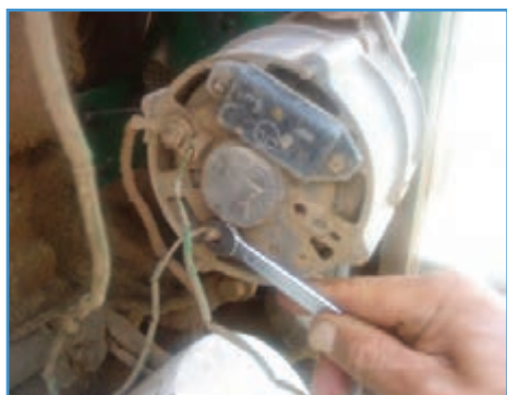
شکل ۳۵-۶- بستن سیم نازک
