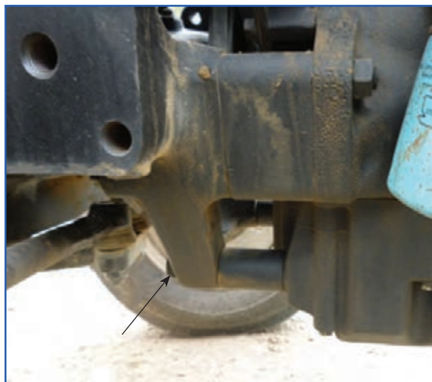
شکل ۱۷-۳- محل پیچ‌های اتصال موتور به جلوی تراکتور
