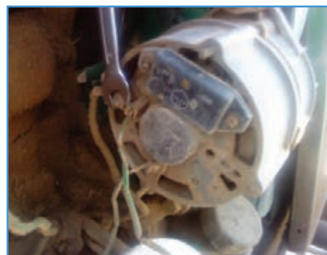
شکل ۳۳-۶- بستن سیم مثبت
