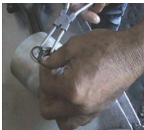
شکل ۱۲۵-۴ طرز جازدن خار انگشتی
