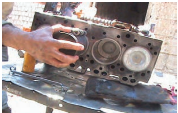
شکل ۱۹۹-۴- چسباندن رینگ جمع کن به سیلندر
