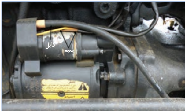
ب) سیم و کابل متصل به استارت‌تر
