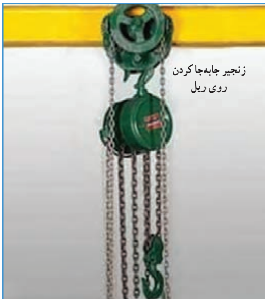
شکل ۲۰-۴- اتصال جرثقیل سقفی به ریل
