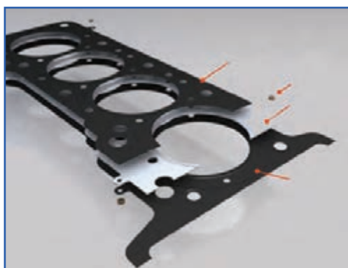
شکل ۴-۴۹ - ساختمان واشر سرسیلندر
