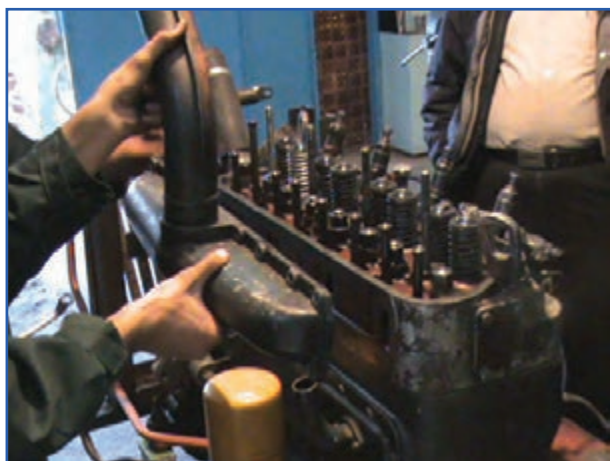
شکل ۴-۴- باز کردن مانیفولد هوا
