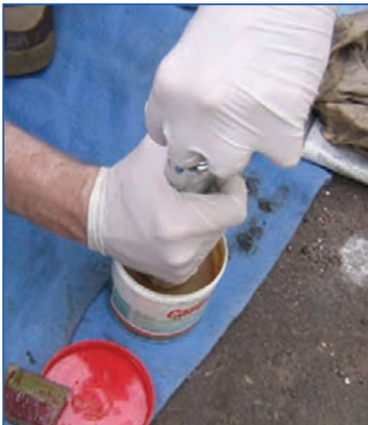
شکل ۴۸-۷- مراحل پر کردن گریس پمپ دستی
