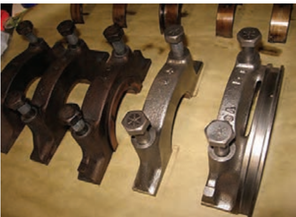
شکل ۱۵۴-۴- چیدن کپه یاتاقان‌ها
