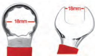
شکل ۳۲-۳- ابعاد آچار یک سر رینگی ۱۸ میلی متری
