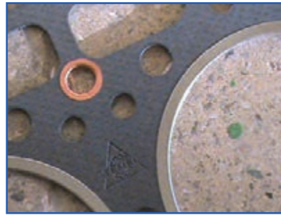
الف) سمت پهن نوار فلزی واشر سرسیلندر
