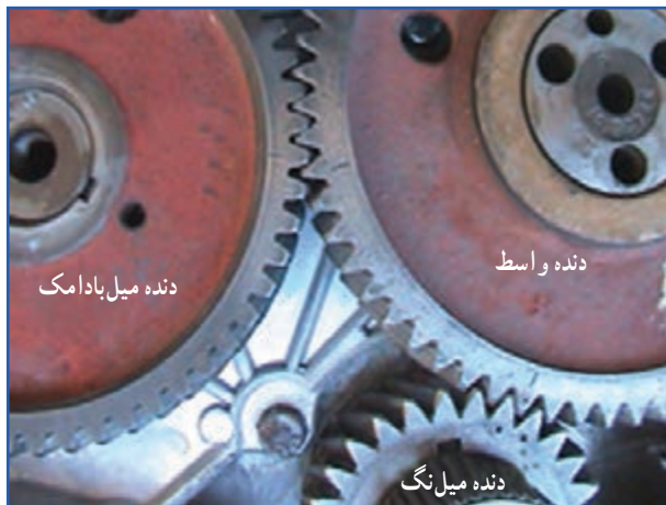
ب) علامت روی چرخ دنده تایمینگ تراکتور MF285
