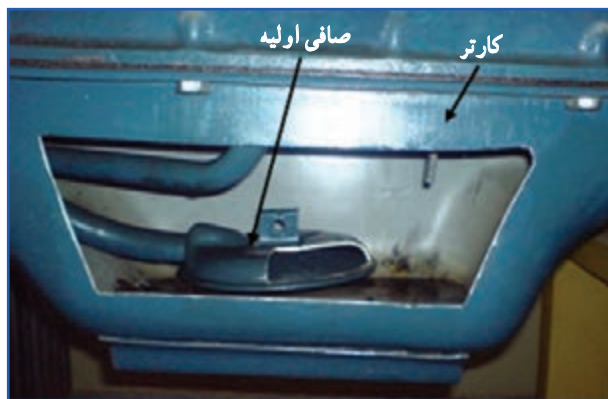
شکل ۲۴-۷- کارتر برش خورده تراکتور U650
