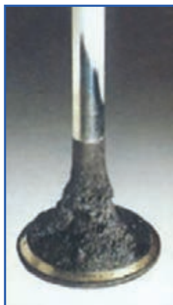
(الف) سوپاپ تمیز شده با محلول
