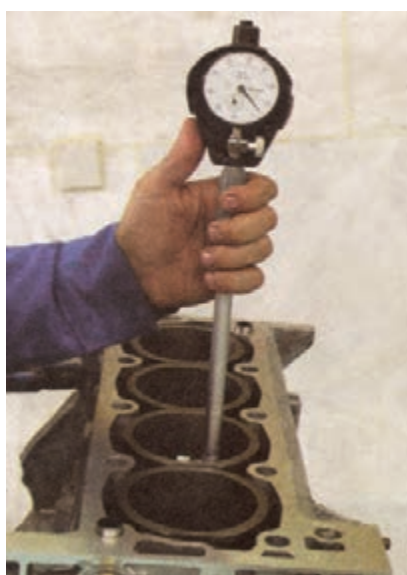
(ب) اندازه‌گیری قطر سیلندر با ساعت اندازه‌گیر داخلی
