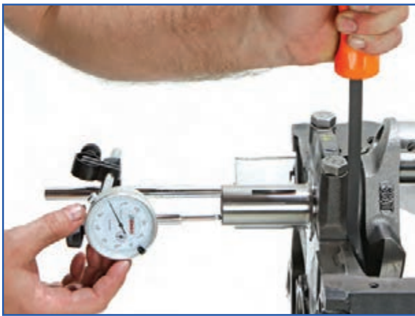
شکل ۱۷۹-۴- اندازه‌گیری لقی طولی میل‌لنگ با ساعت اندازه‌گیری
