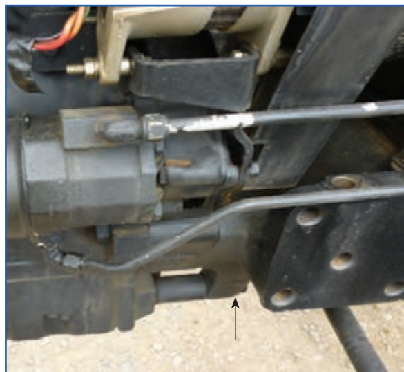
شکل ۱۷-۳- محل پیچ‌های اتصال موتور به جلوی تراکتور
