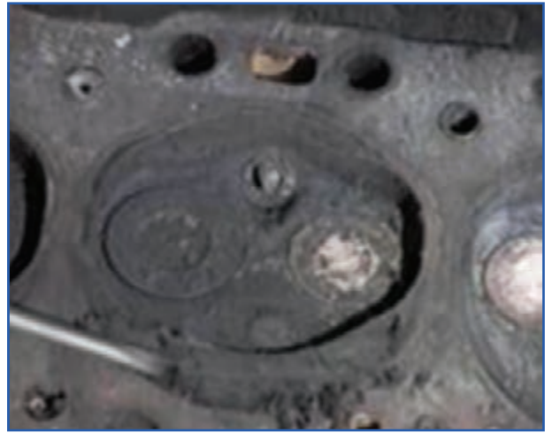
الف) کربن گرفتن سرسیلندر
