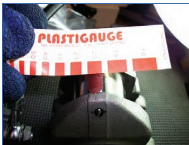
شکل ۱۷۶-۴- اندازه گیری دو بهنی پلاستی گیج شابلون
