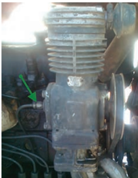
شکل ۵-۸- لوله روغن کاری کمپرسور در تراکتور U650
