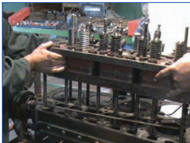
شکل ۱۴-۴- بلند کردن سرسیلندر از روی بدنه سیلندر
