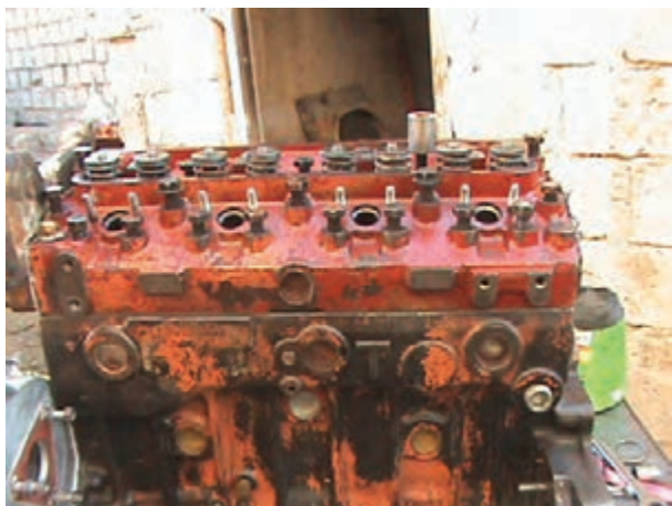
ب) پیچ‌های سرسیلندر باز شده تراکتور MF285
