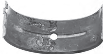
شکل ۱۶۷-۴- نقاط ذوب‌شده روی یاتاقان
