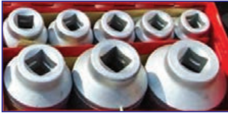
شکل ۳۹-۳- انواع شکاف چهار گوش (درایو بکس) آچار بکس
