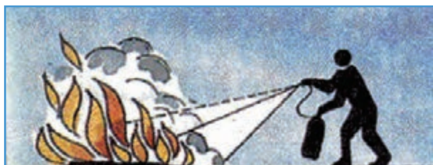
شکل ۱۳-۱- روش خاموش کردن آتش با پودر
