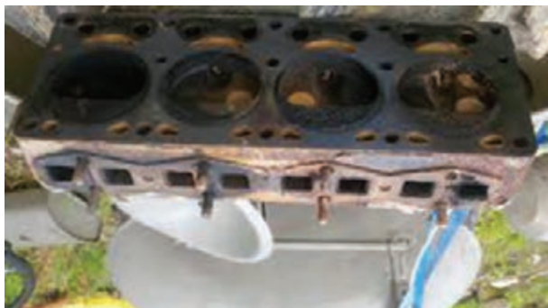
شکل ۲۰۹-۴- رسوبات کربن سطح سرسیلندر
