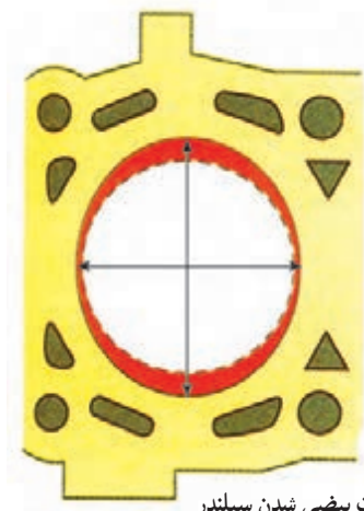
شکل ۱۴۹-۴- وضعیت بیضی شدن سیلندر
