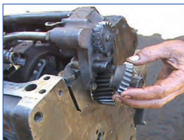
شکل ۸۰-۴- خارج کردن چرخ‌دنده بلمپ روغن
