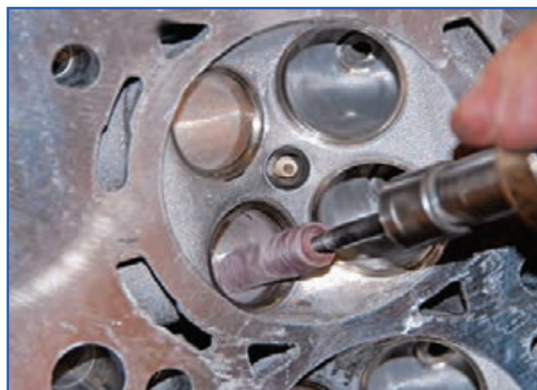
الف) نحوه تمیز کردن محفظه پشت سوپاپ
