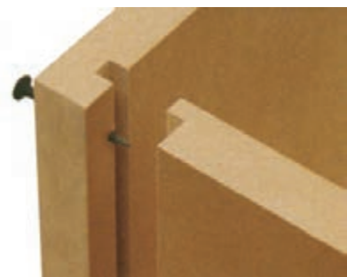
شکل ۲-۳۴ - تصویر مجسم پشت‌بند دو راهه شده که داخل کنشکاف، با پیچ محکم می‌شود.
