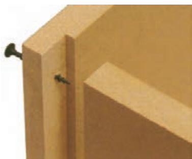
شکل ۲-۳۳ - تصویر مجسم پشت‌بند، که داخل دو راهه، با پیچ محکم می‌شود.
