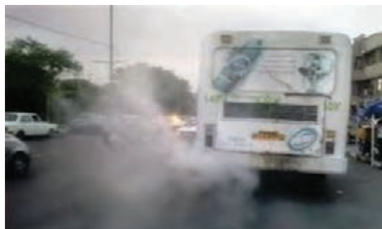
شکل ۶- سوخت ناقص گازوئیل در ماشین‌های فرسوده
