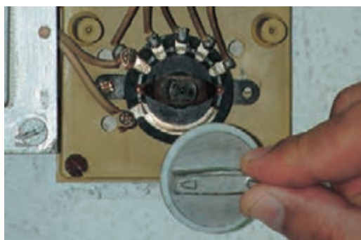
شکل ۷-۳۷۶ سیم رابط فاز خروجی کلید به پنکه
