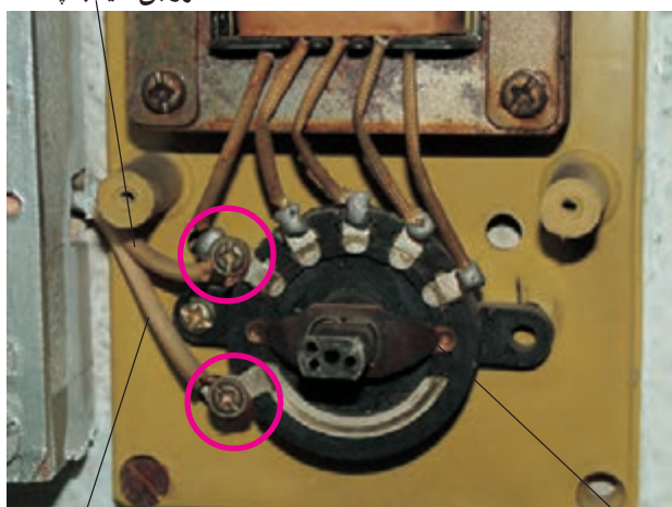
سیم رابط فاز ورودی به کلید
