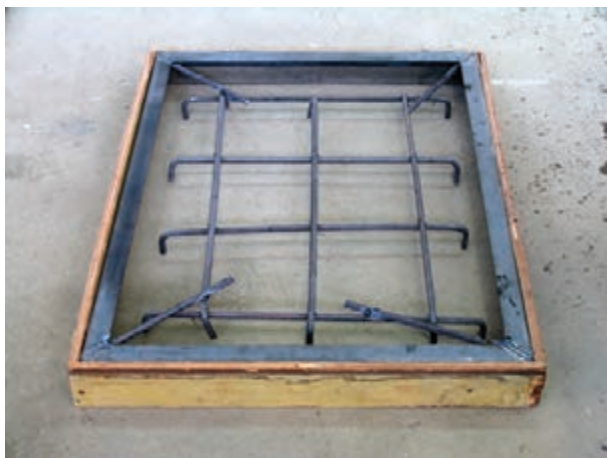
شکل ۵-۱- قرارگیری میل‌گردها در قالب
