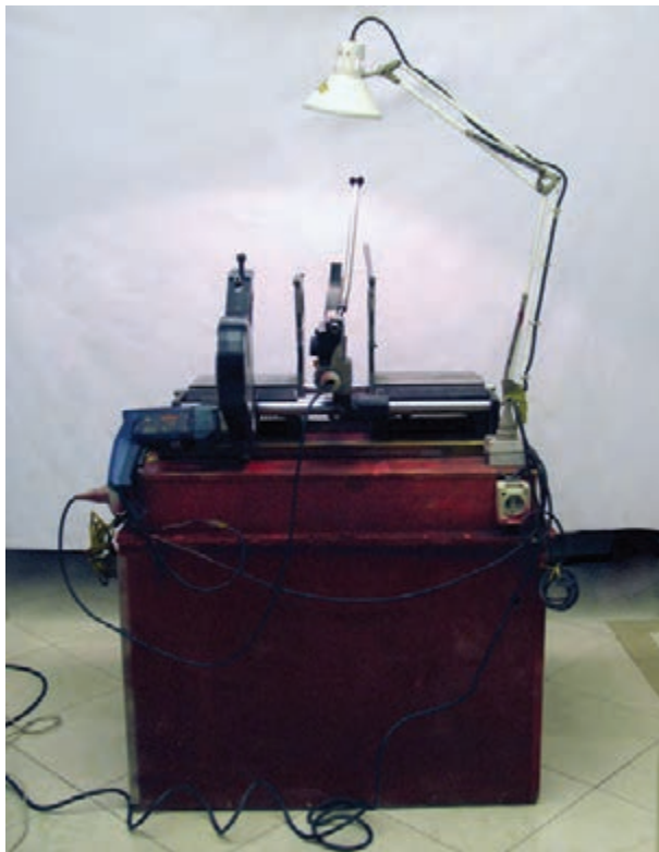
شکل ۲-۳۷- دستگاه جوش لوله و فیتینگ پلی اتیلن
