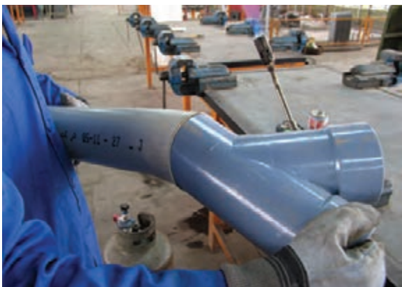
شکل ۲-۹- درست کردن سرکاسه
