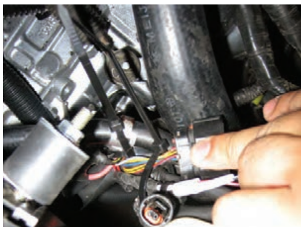
شکل ۴۵-۵ بررسی اتصالات الکتریکی سیم‌کشی
