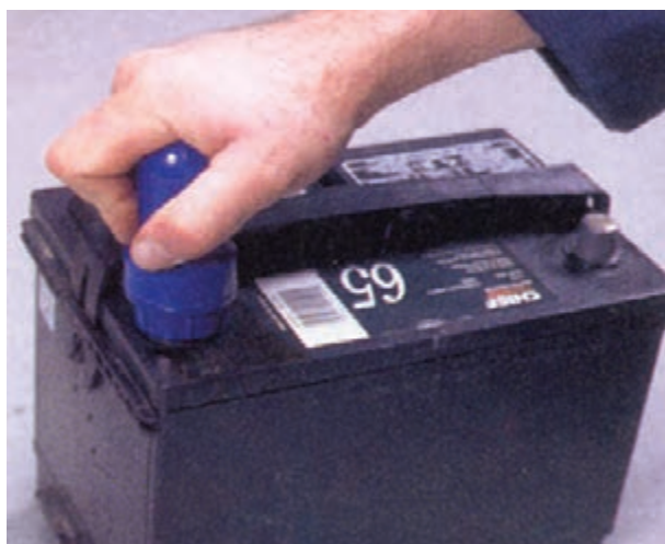
شکل ۸۹-۱ - نحوه‌ی استفاده از ابزار مخصوص باتری
