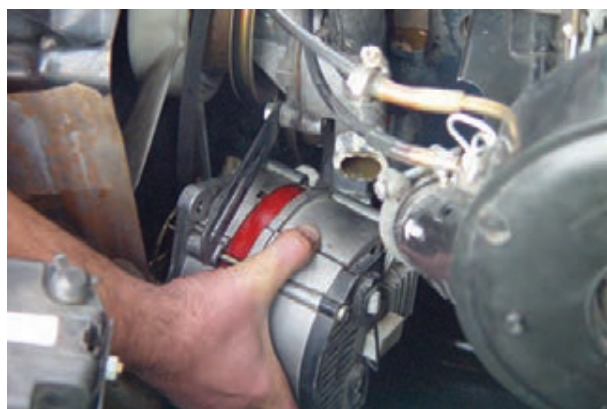
شکل ۸۶-۷- نصب آلترناتور
