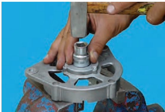
شکل ۶۹-۷ - بیرون آوردن بلبرینگ
