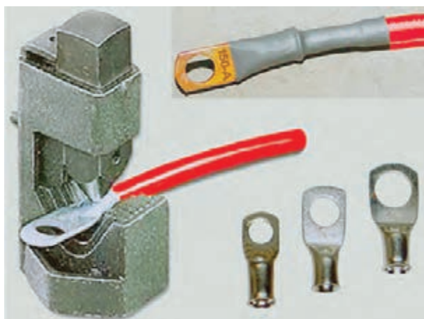
شکل ۸۰-۸- اتصال بست به کابل باتری
