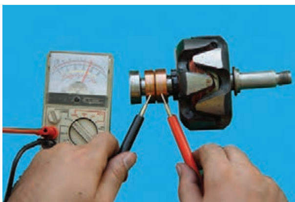
شکل ۷-۷۵ - آزمایش سالم بودن سیم پیچ روتور
