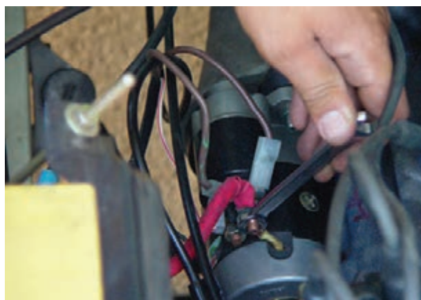
شکل ۸-۴۸ – جدا کردن اتصالات الکتریکی استارتر
