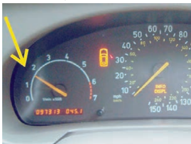
شکل ۷-۱۰۱ افزایش دور موتور برای آزمایش
