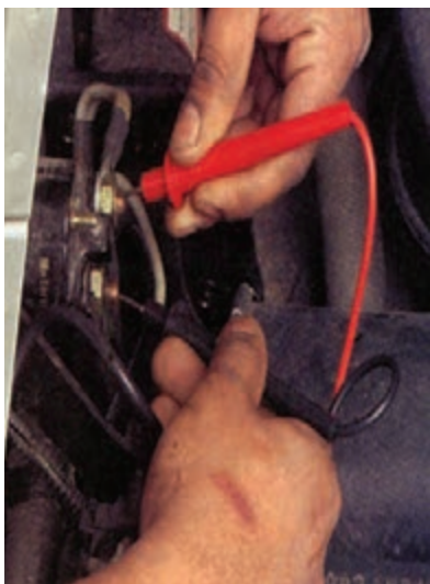
شکل ۸-۴۲ اتصال فیش‌های ولت‌متر به اتومات استارتر
