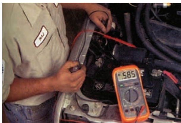
شکل ۸-۴۴ اندازه‌گیری افت ولتاژ پلاتین‌های سولونوید استارتر
