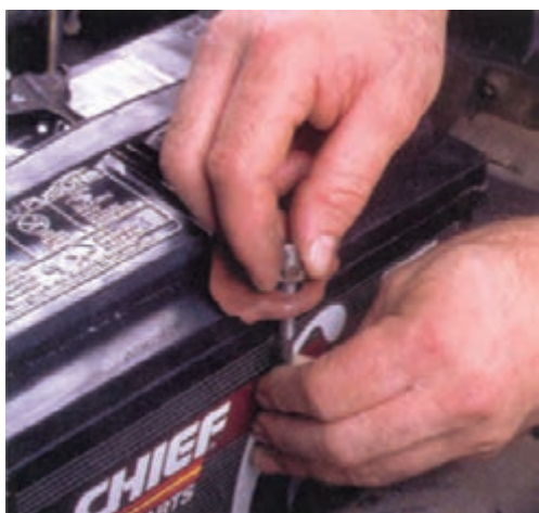
شکل ۹۴-۱- بستن باتری روی خودرو
