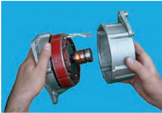
شکل ۶۱-۷ – جدا کردن درپوش‌های آلترناتور
