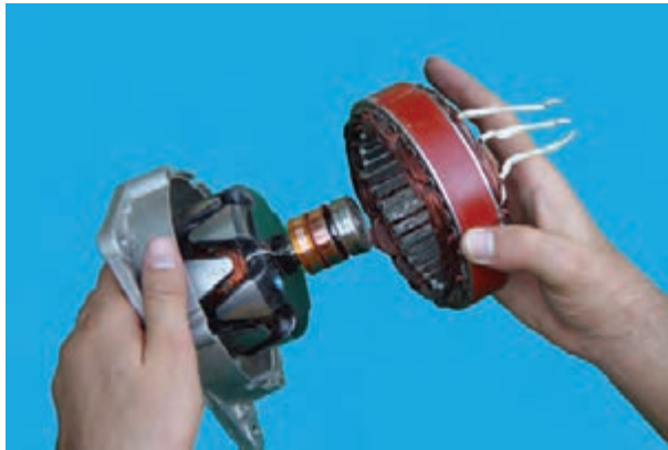
شکل ۶۲-۷ – جدا کردن استاتور
