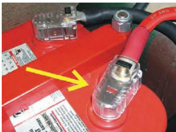
شکل ۱۹-۲- مورد استفاده تلق محافظ قطب‌های باتری
