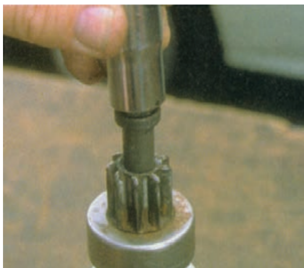
شکل ۸-۶۰ – خارج کردن حلقه رینگ‌ی از شیار شافت
