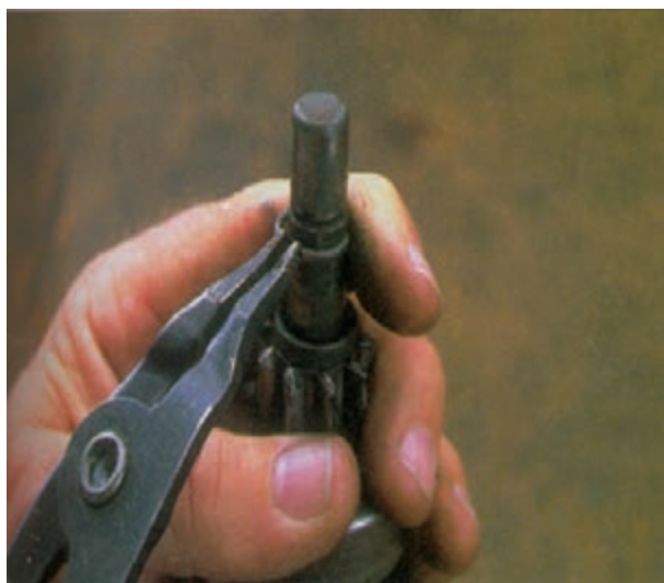
شکل ۸-۶۱ – درآوردن خار رینگ‌ی
