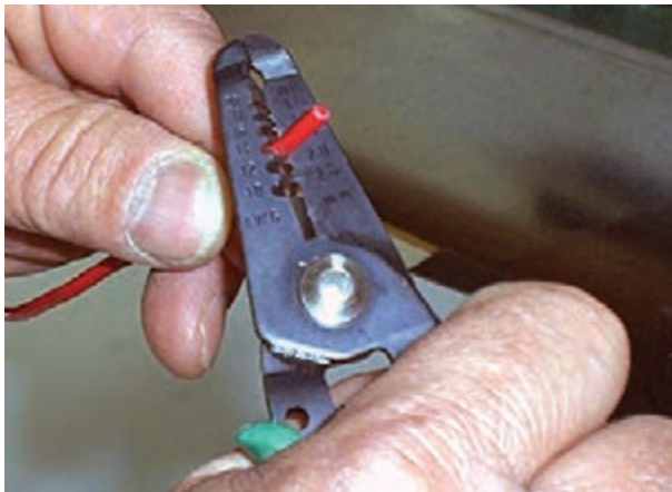
شکل ۶-۳۰ جدا کردن عایق سیم
