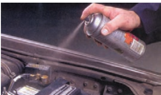
شکل ۱-۹۶- پاشیدن محلول ضد خوردگی روی بست
