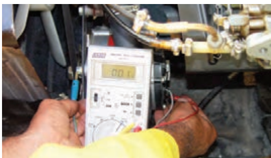
شکل ۷۲-۷۱ - اتصال ولت‌متر بین ترمینال B و بدنه
