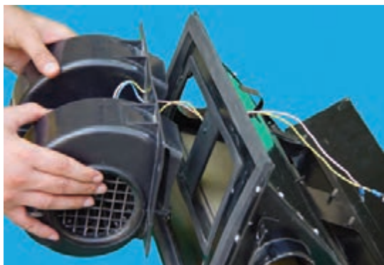
شکل ۴-۳۷ – جدا کردن محفظه‌ی موتور از بخاری
