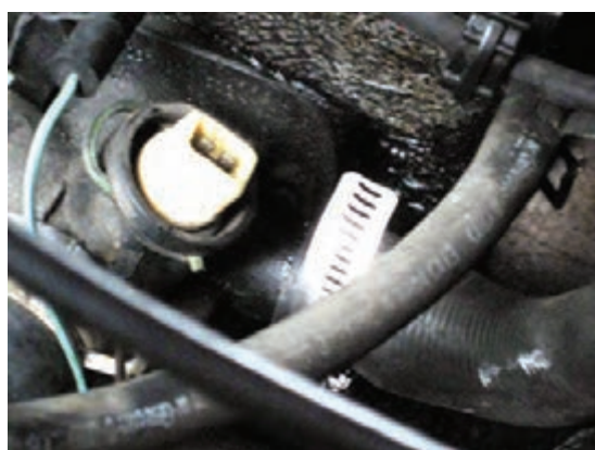
شکل ۲۵-۶ ترمینالهای سنسور حرارتی مدار خنک کاری
