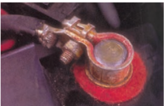
شکل ۱-۹۷- گریس زدن بست قطب‌ها
