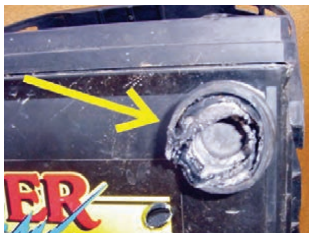
شکل ۳۶-۲- معیوب بودن ترمینال باتری
