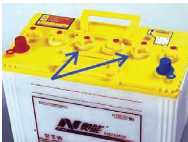
شکل ۴-۱- درپوش خانه‌های باتری
