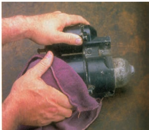
شکل ۸-۵۰ - تمیز کردن استارتر
