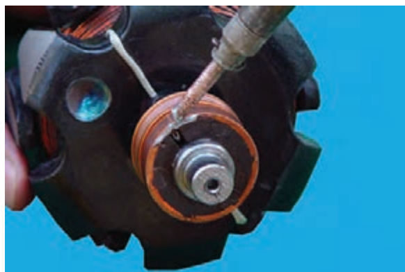
شکل ۶۶-۷ – جدا کردن سیم های روتور از کلکتور
