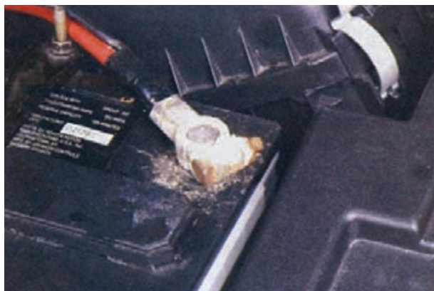
شکل ۸-۳۱ سولفات شده شدن اتصال قطب باتری
