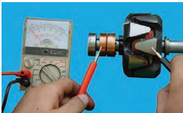
شکل ۷-۷۴ - آزمایش اتصال بدنه نبودن سیم پیچ روتور
