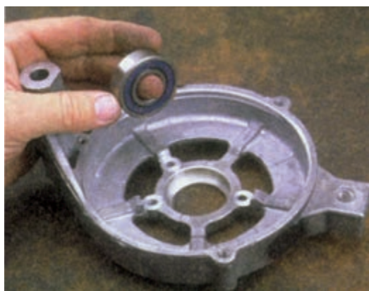
شکل ۷۰-۷ - خارج کردن بلبرینگ و آزمایش آن
