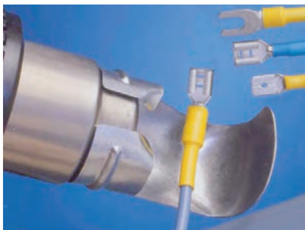
شکل ۷۹-۸- عایق کاری اتصال سرسیم به سیم
