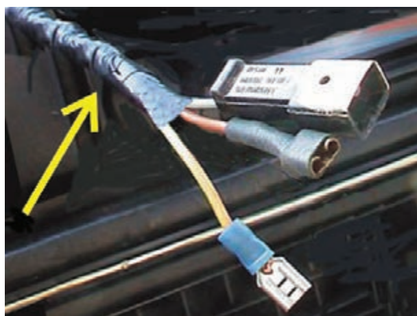
شکل ۳-۳۹- کلاف‌بندی سیم‌ها
