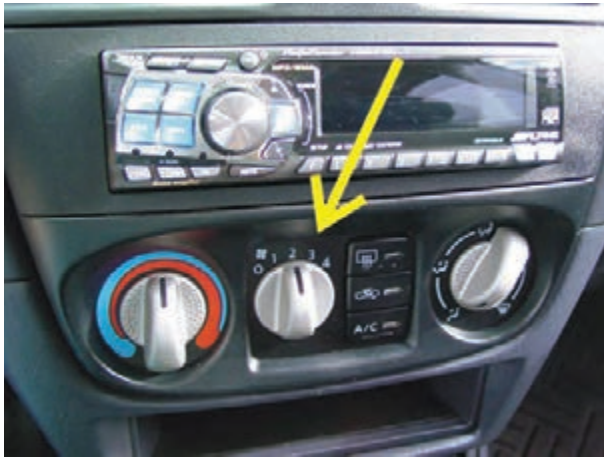
شکل ۴-۵۲- سوئیچ فن چهار وضعیتی
