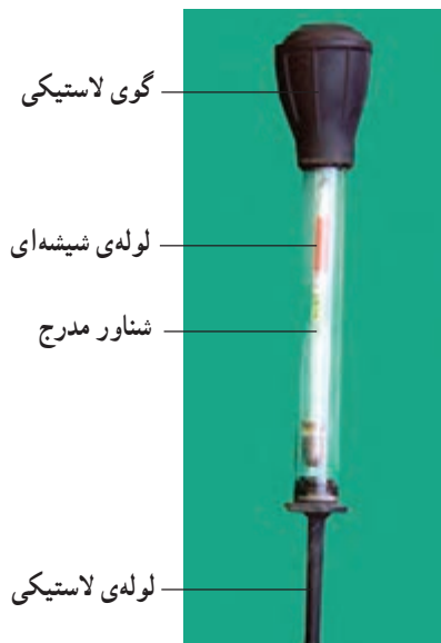
شکل ۱-۱۴- دو نوع هیدرومتر یا چگالی سنج
