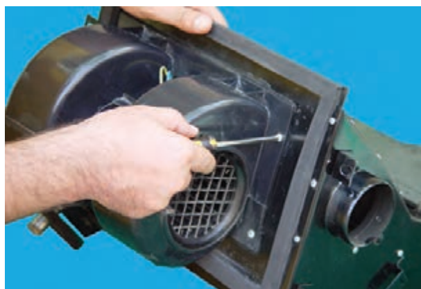
شکل ۴-۳۶- باز کردن پیچ‌های محفظه‌ی موتور
