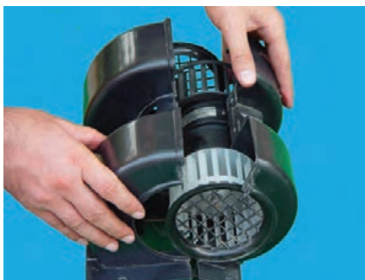
شکل ۴-۴۰ – جدا کردن محفظه‌ی نگه‌دارنده‌ی موتور
