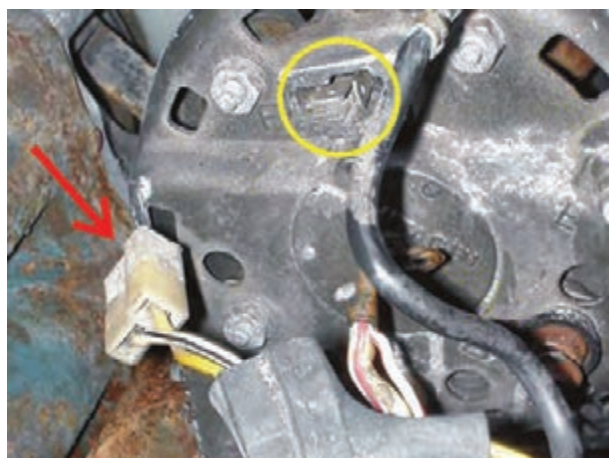
شکل ۳-۳۵ جدا کردن کائوچویی سیم کشی لامپ شارژ
