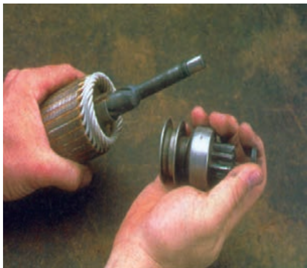
شکل ۶۲-۸ – خارج کردن مجموعه دنده‌ی استارتر از روی شافت
