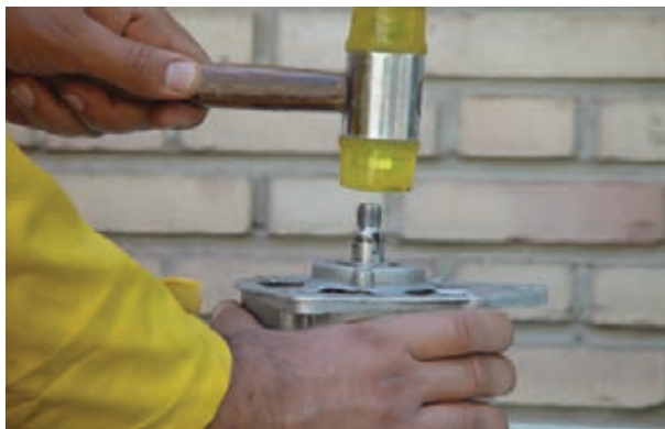
شکل ۶۳-۷ – بیرون آوردن روتور از درپوش
