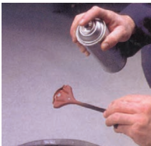
شکل ۹۳-۱- اسپری ضدخوردگی روی بست نگه‌دارنده‌ی باتری
