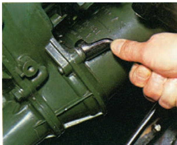
شکل ۸-۷۶ - بستن استارتر روی موتور
