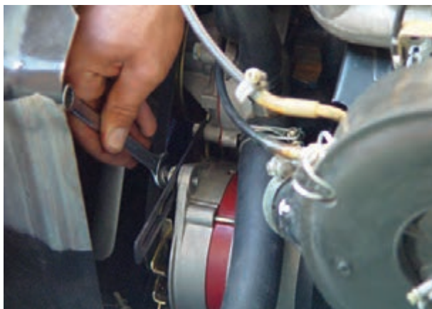
شکل ۷-۴۹ - باز کردن پیچ کشش تسمه پروانه
