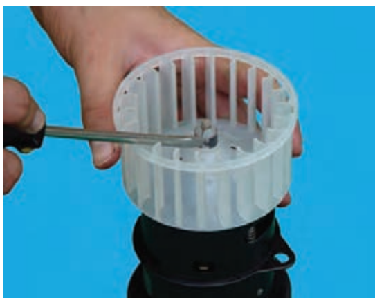
شکل ۴-۴۲- درآوردن خار نگهدارنده‌ی فن
