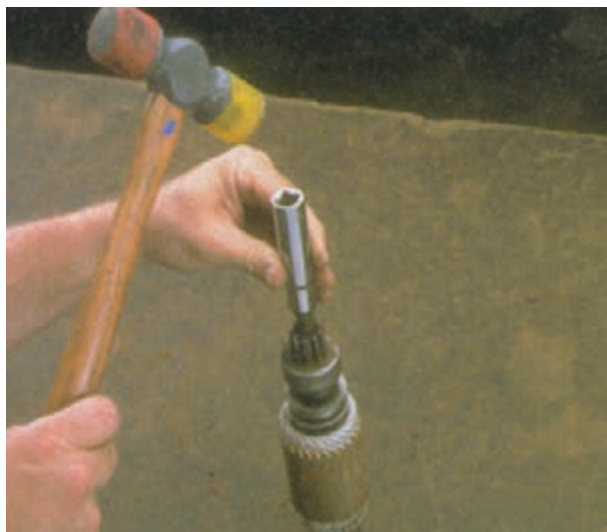
شکل ۸-۵۹ – ضربه زدن با چکش روی خار
