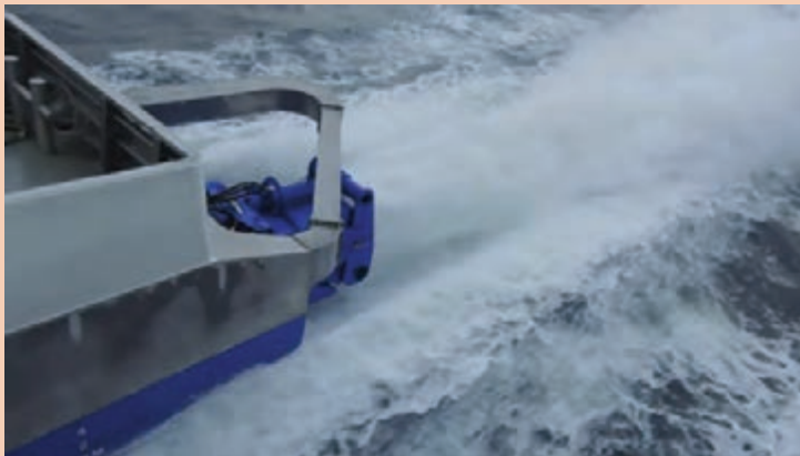
یک نمونه واترجت در انتهای یک شناور
