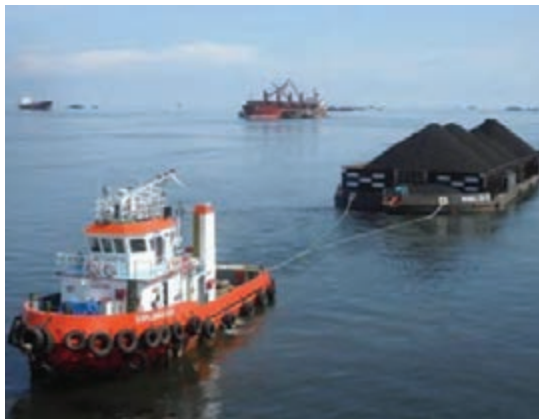
شکل ۲۲- یدک کش در حال حمل بارج
