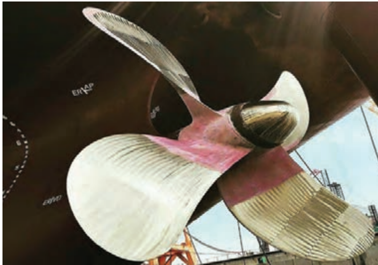
شکل ۱۳- پروانه کشتی با چهار پره
