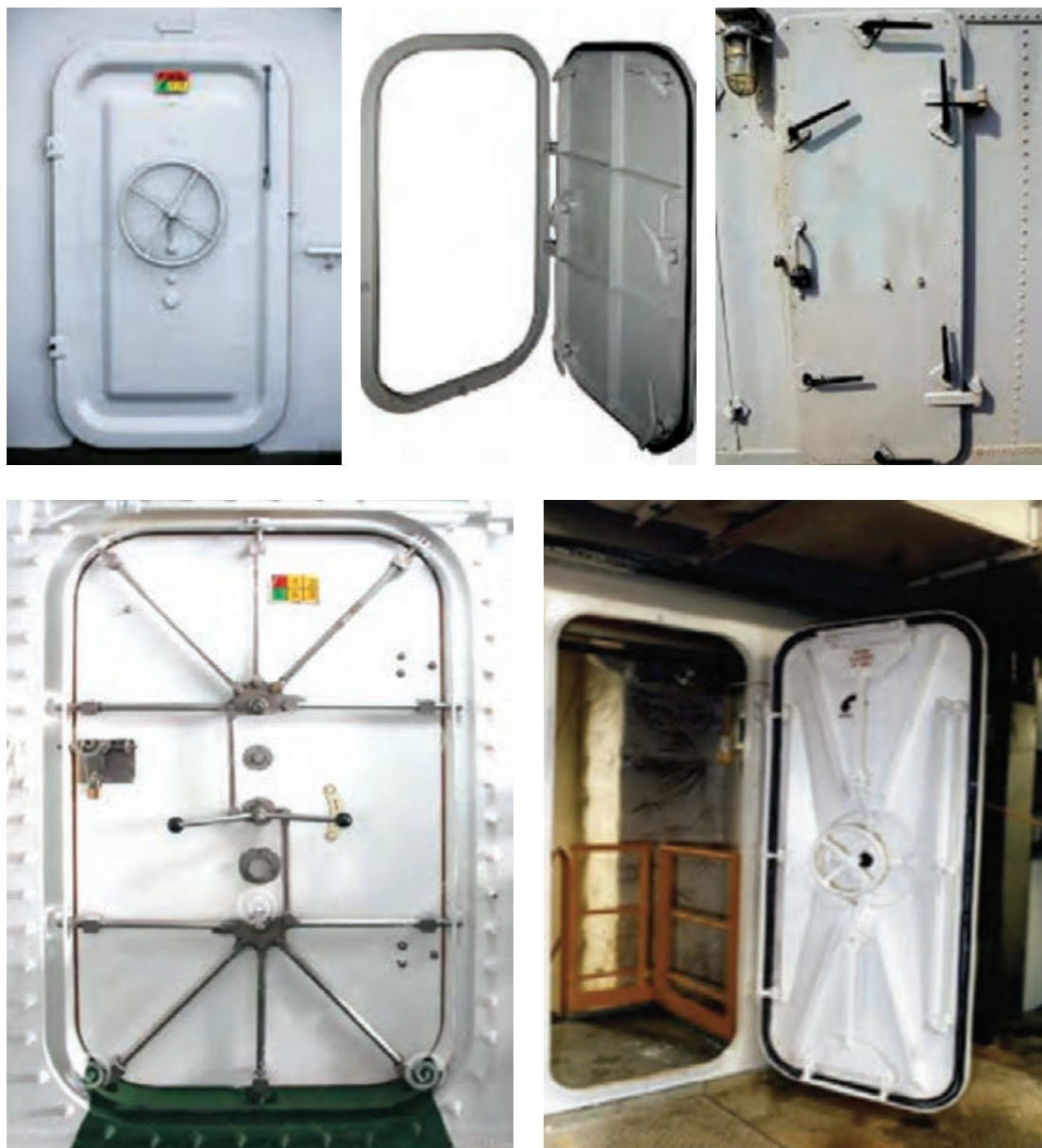
شکل ۶- چند نمونه از درب‌های غیر قابل نفوذ
