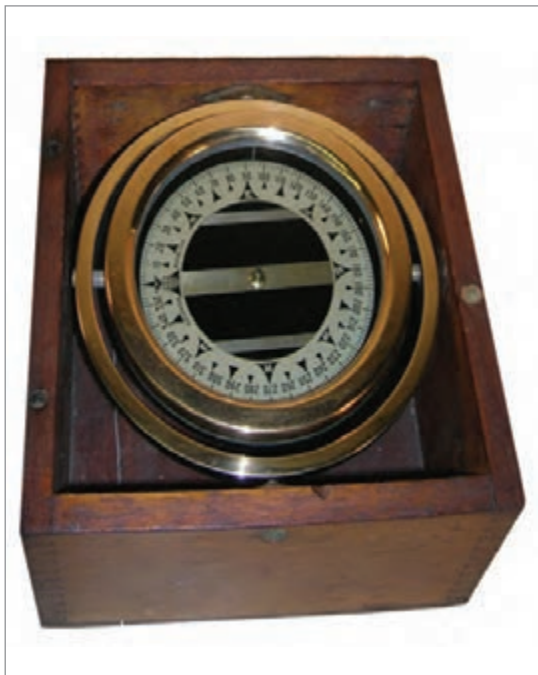
شکل ۲- نمونه‌ای از قطب نماهای مورد استفاده در کشتی‌ها
