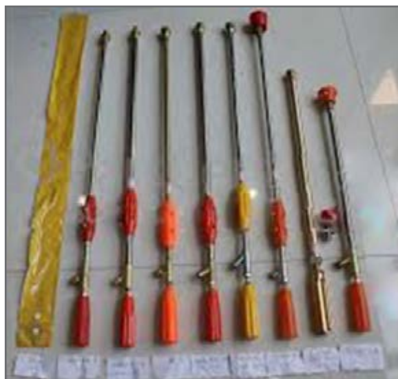
شکل ۱۶- انواع پمپ و نازل سم پاش
