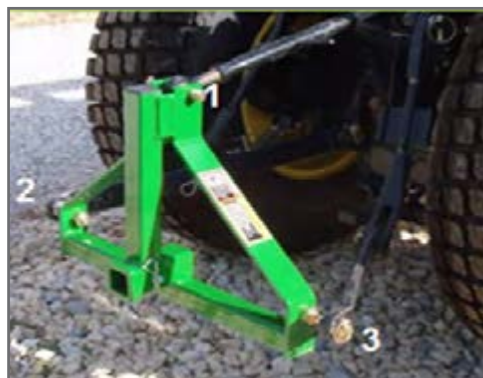
شکل ۸- نقاط اتصال سه‌گانه تراکتور
